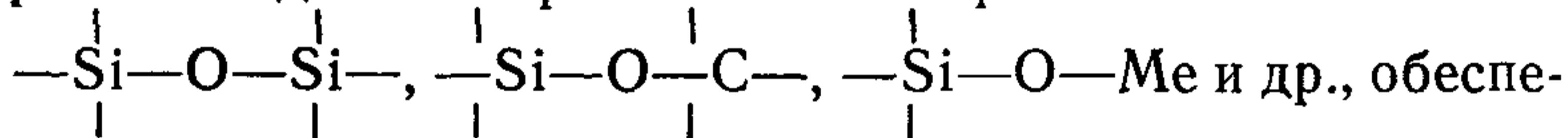
обеспечивающие физическое и химическое взаимодействие с материалом, обращены к поверхности, а органогенные группы, обрамляющие атом Si, направлены в противоположную сторону — наружу. Благодаря такому распределению полиорганосилоксанов, на поверхности материала при малых его количествах обеспечивается большой водоотталкивающий эффект.
