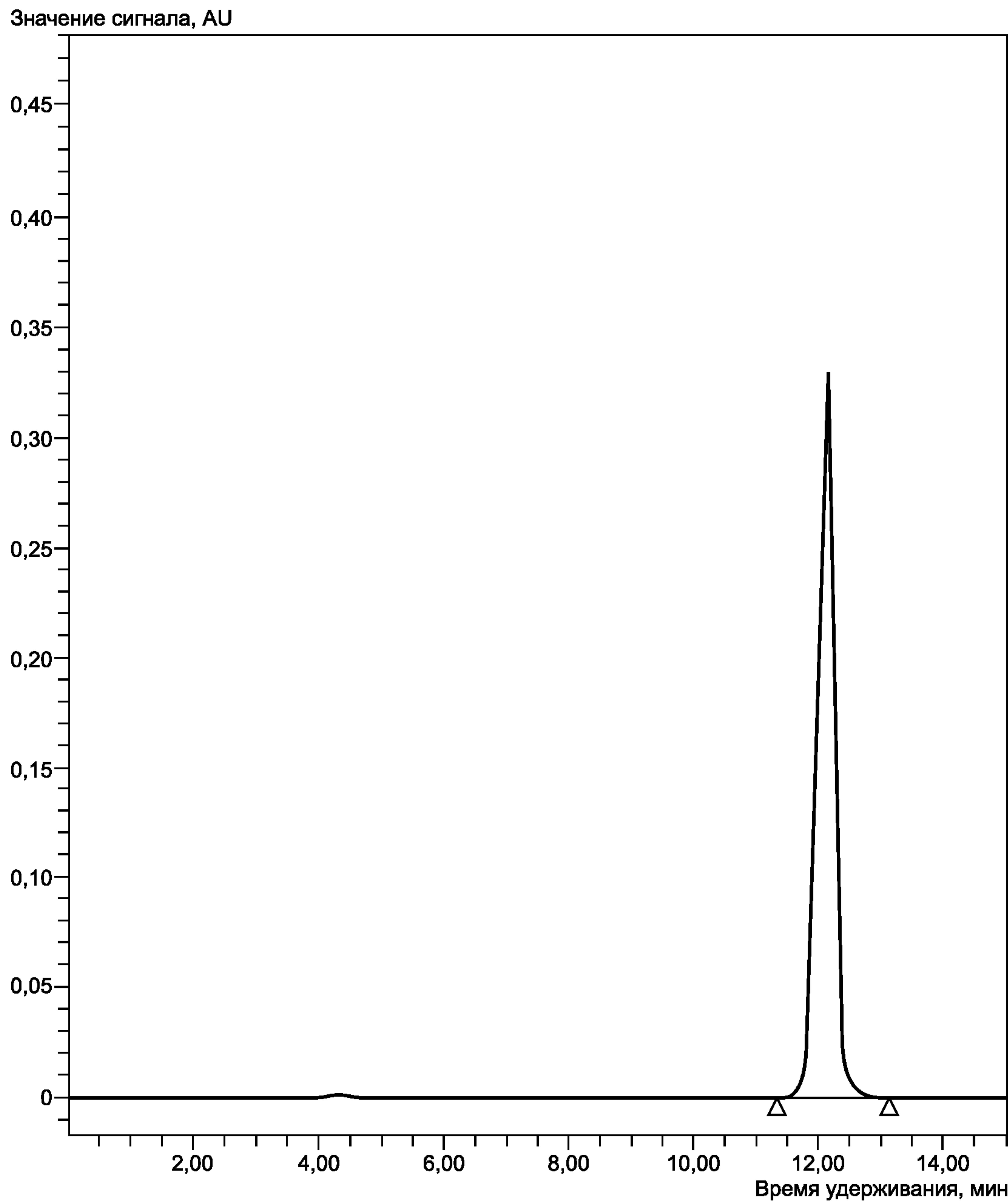
Рисунок А.1 — Хроматограмма стандартного раствора L-аскорбиновой кислоты
