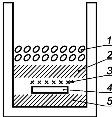
1 — вольфрамовый плавень (4.3): 1,9 г; 2 — чистое железо (4.4): 0,4 г; 3 — аналитическая проба (7.2) или углекислый барий (4.6): 0,4 г; 4 — оловянная капсула (4.5); 5 — чистое железо (4.4): 0,9 г
