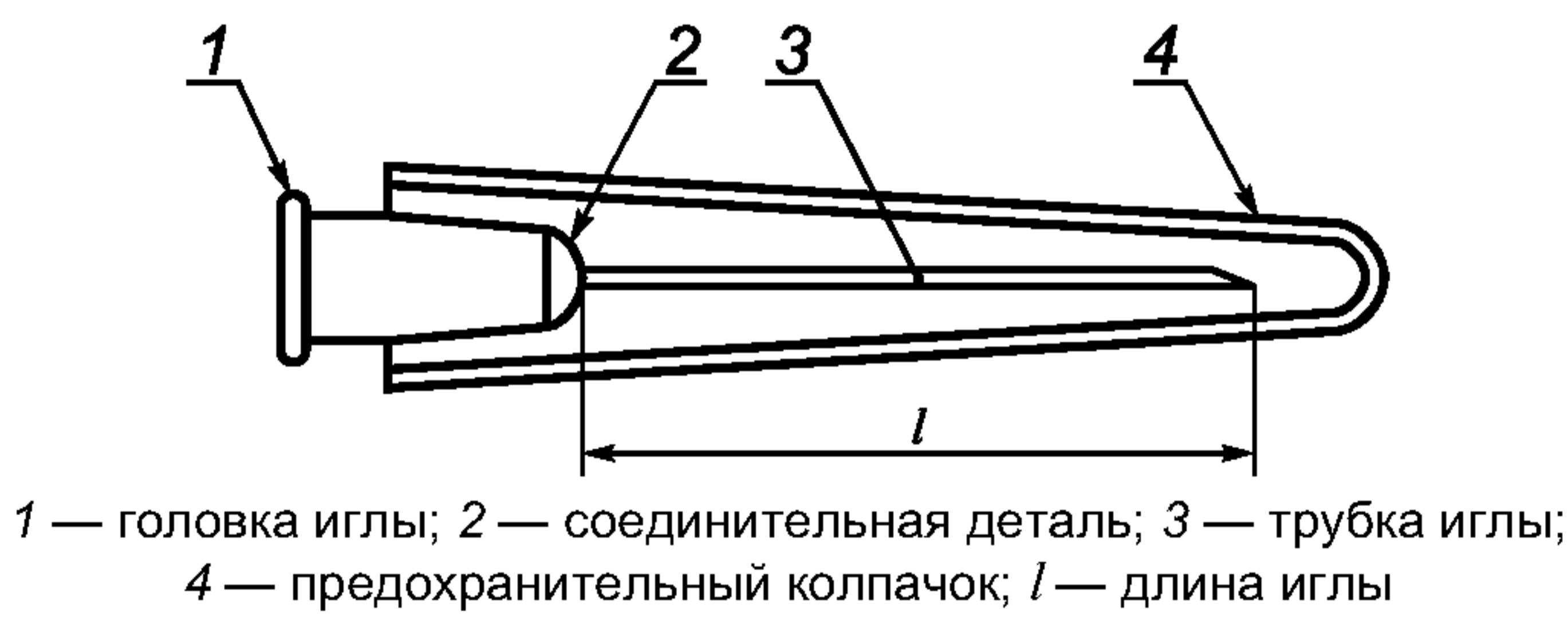
Рисунок 1 — Пример типовой инъекционной иглы однократного применения
