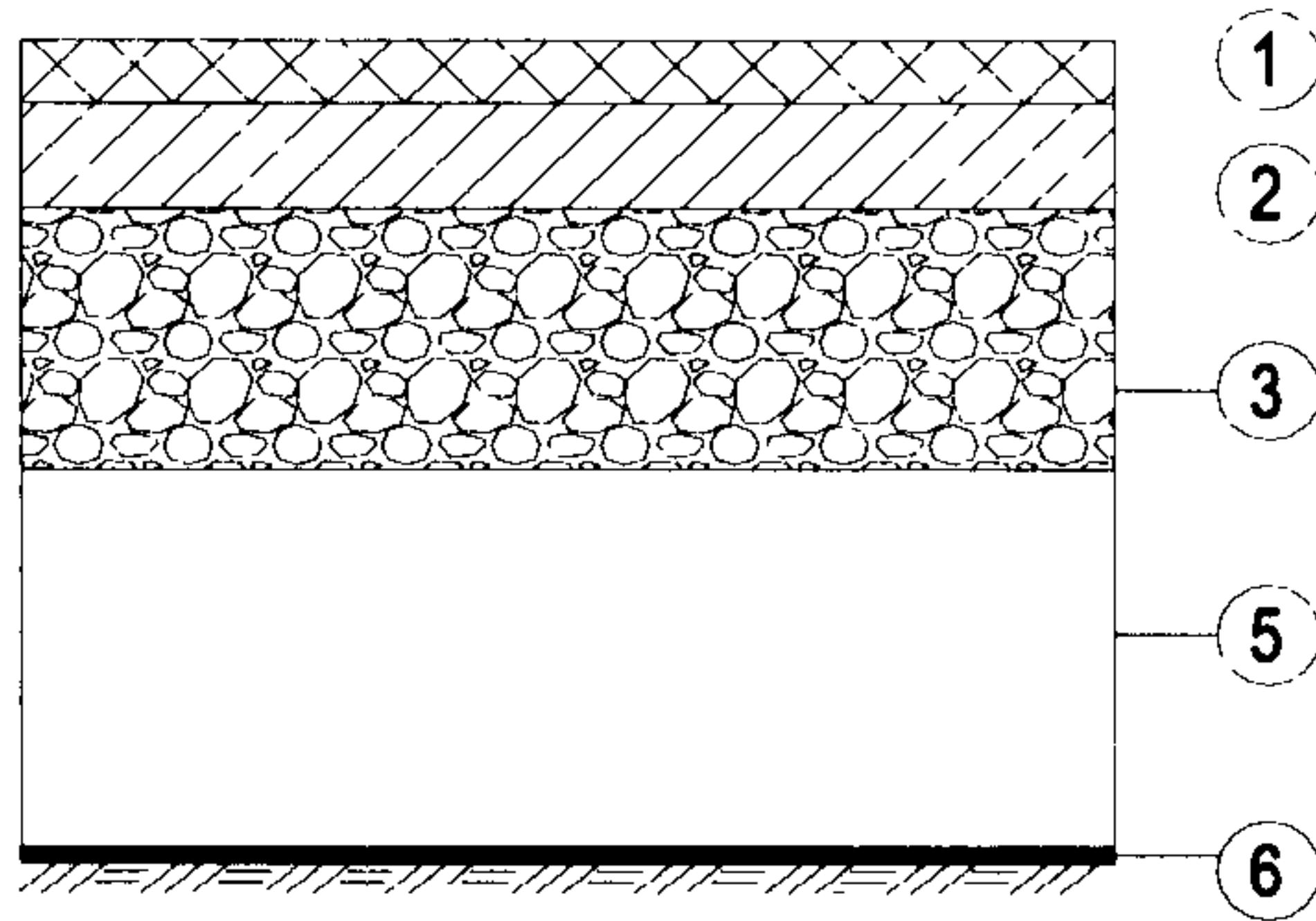
Рисунок 1а - Геосетка уложена на земляное полотно
