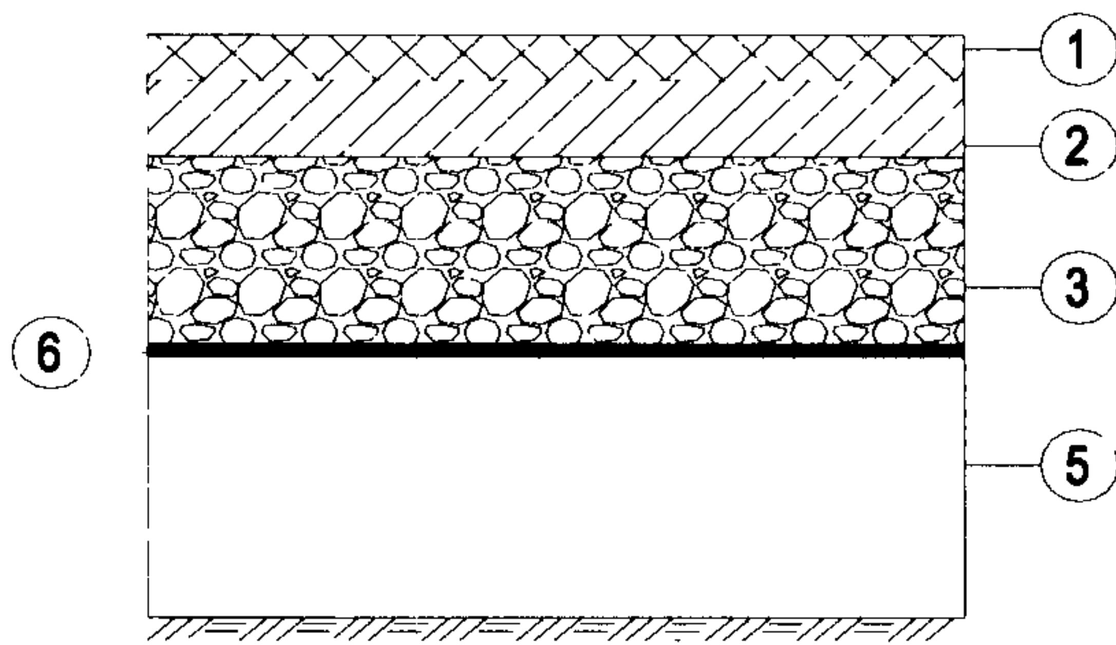
Рисунок 1б - Геосетка уложена на песчаный подстилающий слой под щебеночным основанием
