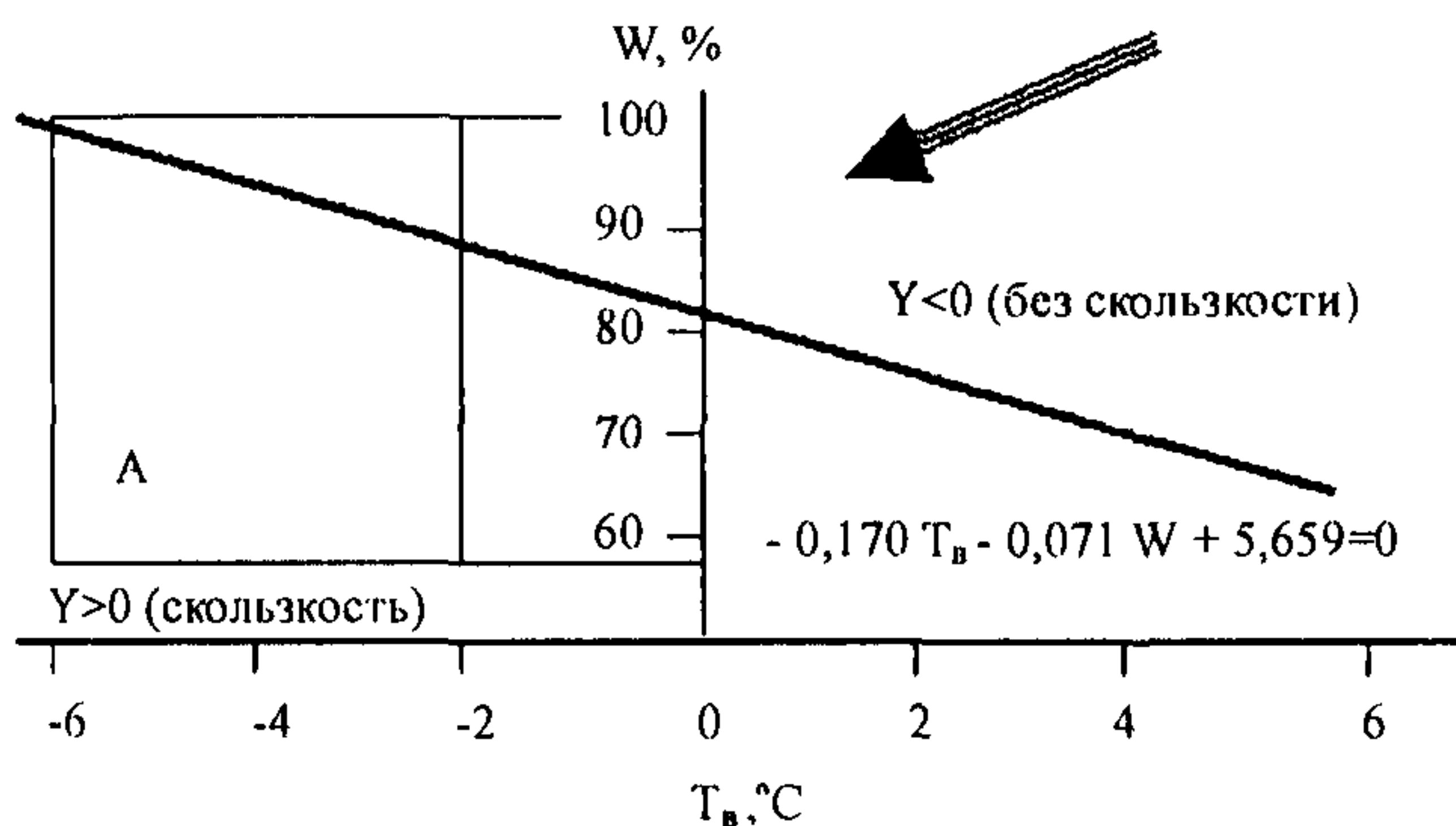
*Рисунок 3. Геометрическая интерпретация производственно-технологического предупреждения об образовании гололедицы*
