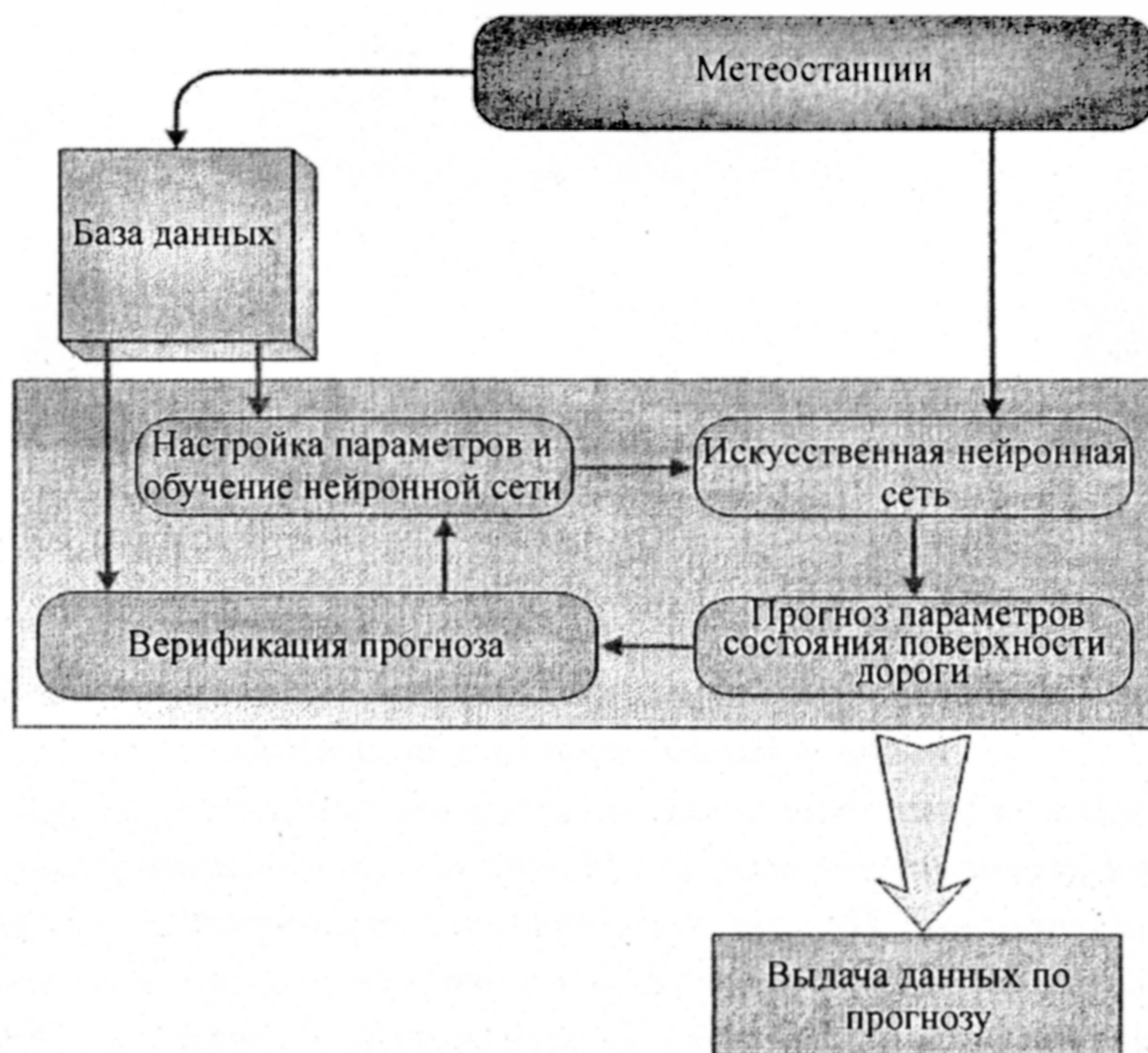
**Рисунок Г.3. Блок-схема расчета прогноза параметров погоды и параметров состояния дорожного покрытия**
