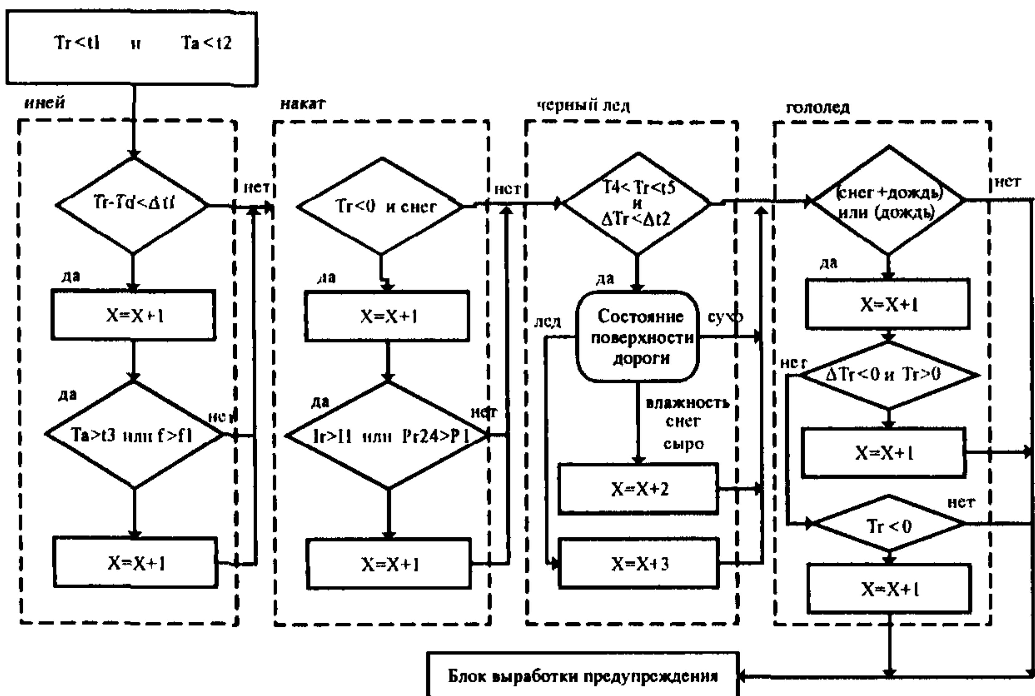
**Рисунок Г.2. Схема алгоритма выработки предупреждений о возможности возникновения сколькости на поверхности дороги:**
