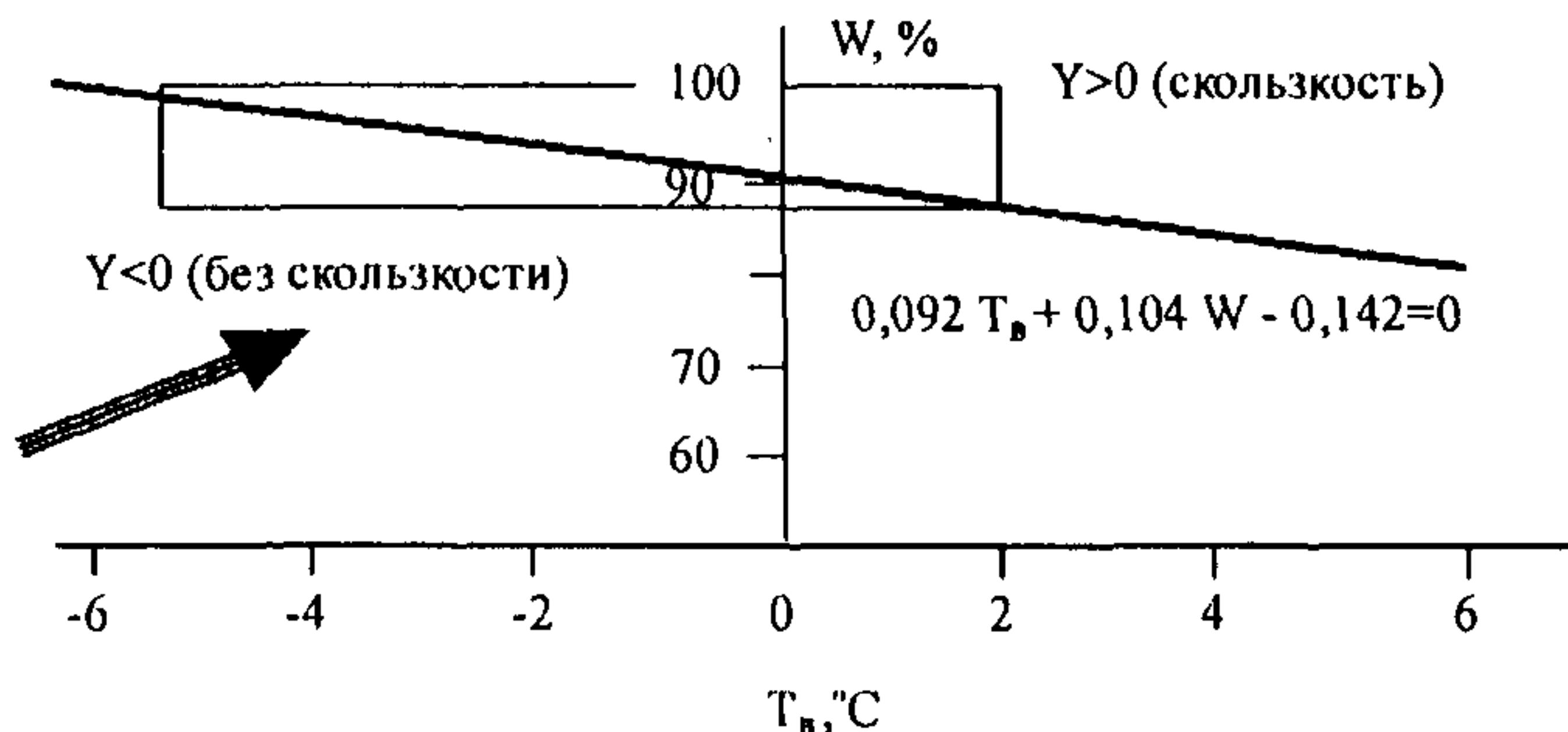
*Рисунок 4. Геометрическая интерпретация производственно-технологического предупреждения об образовании гололеда*
