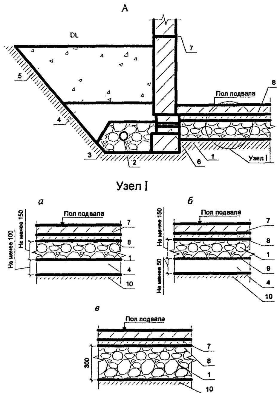
Рис. 7. Схема конструкции пластового дренажа
