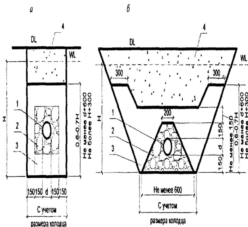
Рис. 5. Схема устройства обсыпок:
