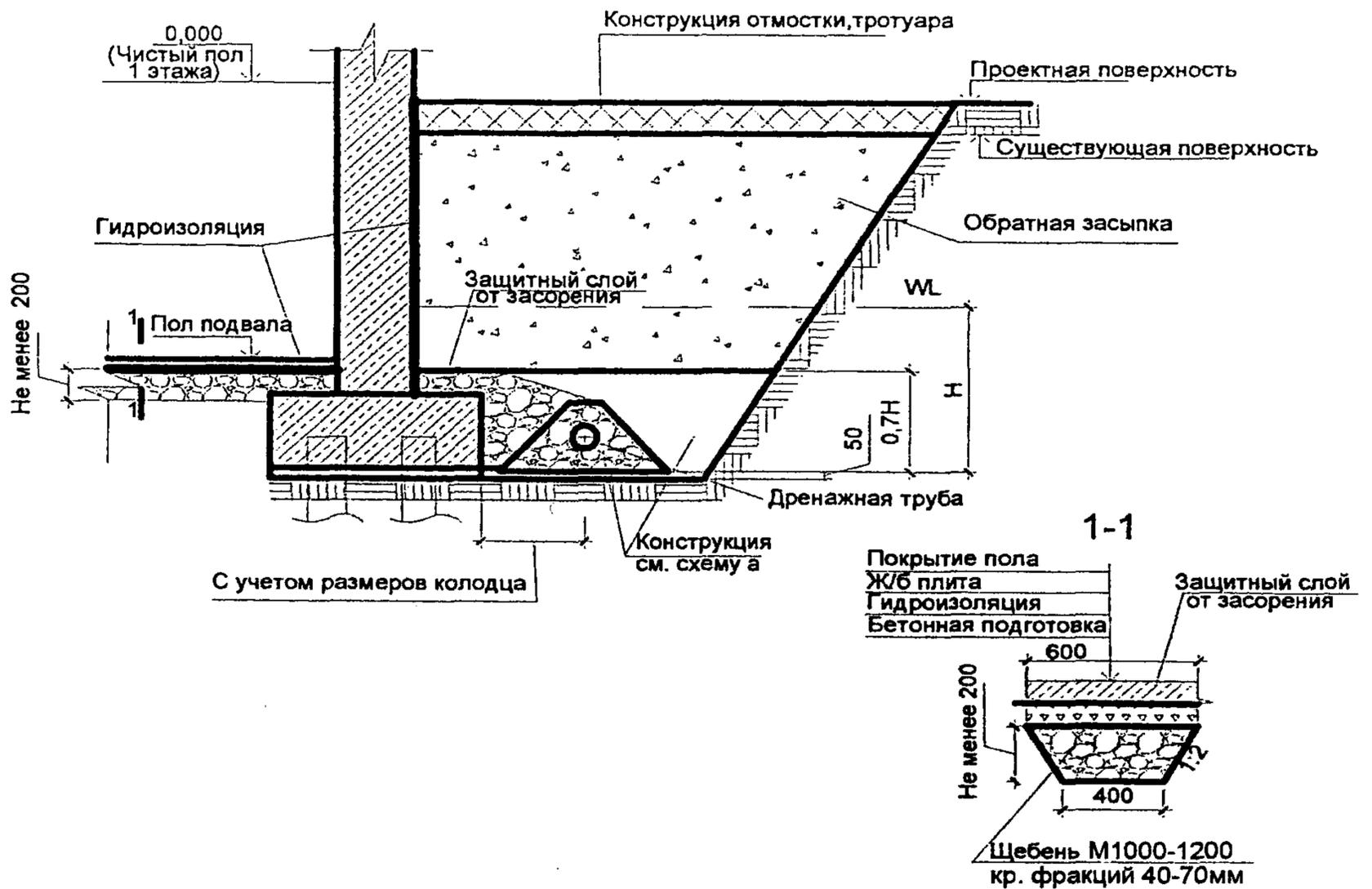
в – совершенного типа на условном водоупоре с линейным пластовым дренажем
