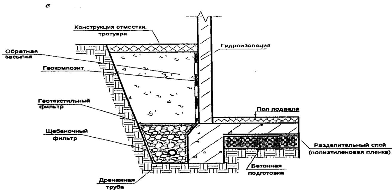
*e – с геотекстильной прослойкой в обсыпке дрены и геокомпозитом*
