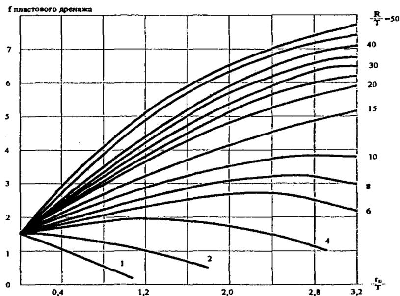
Рис. 16. График определения величины гидравлического сопротивления пластового дренажа
