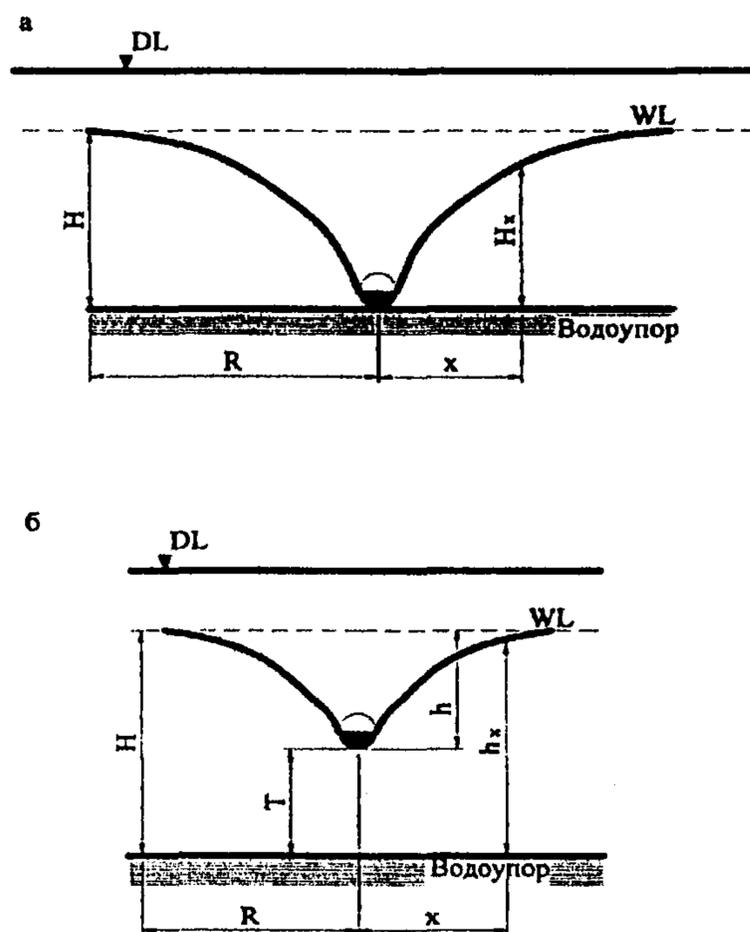
Рис. 9. Расчетные схемы однолинейного дренажа
