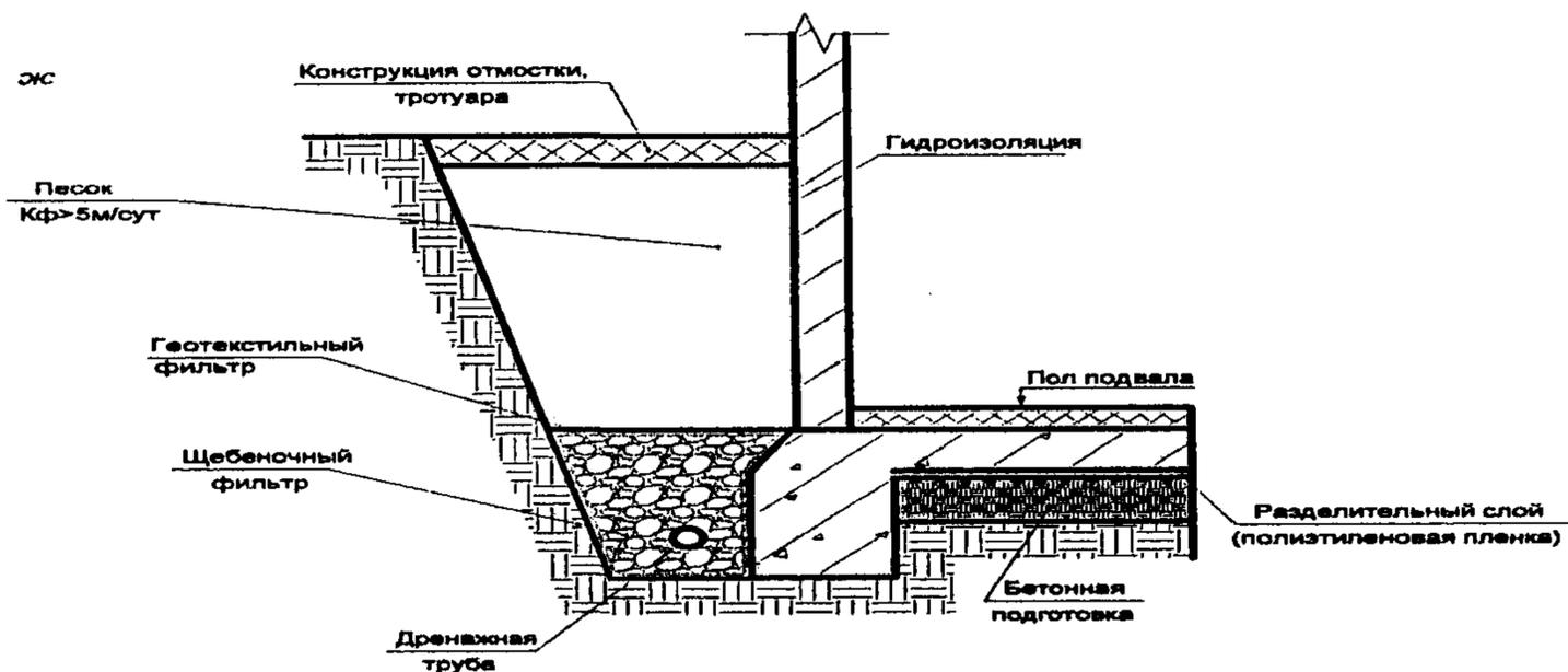
*ж – с геотекстильной прослойкой в обсыпке дрены без геокомпозита*
