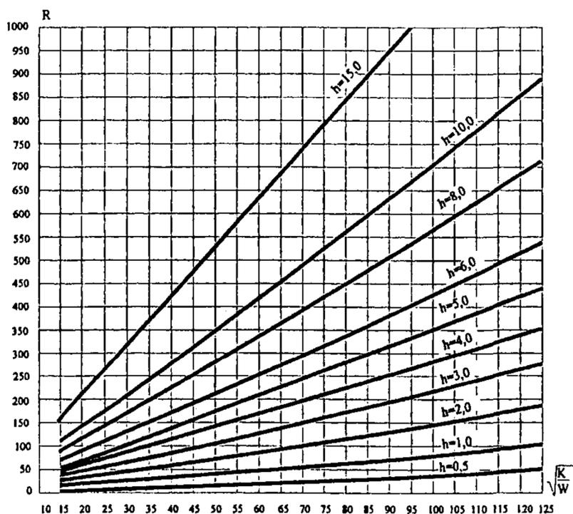
Рис. 10. График определения радиусов депрессии линейных дренажей
