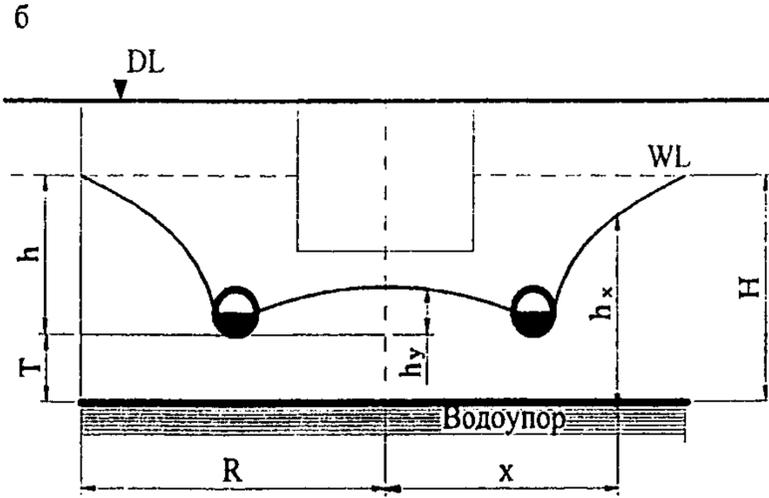
Рис. 11. Расчетные схемы контурного (кольцевого, пристенного) дренажа: а – совершенного типа; б – несовершенного
