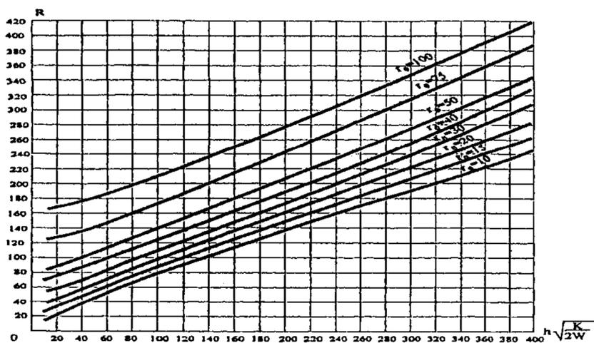
Рис. 12. График определения радиуса депрессии контурных и пластиковых дрен
