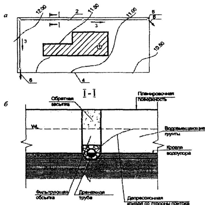
Рис. 2. Схема однолинейной системы дренажа совершенного типа:
