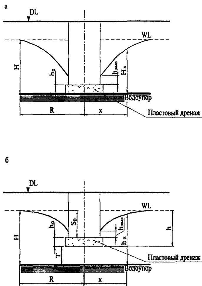
Рис. 15. Расчетные схемы пластового дренажа:
