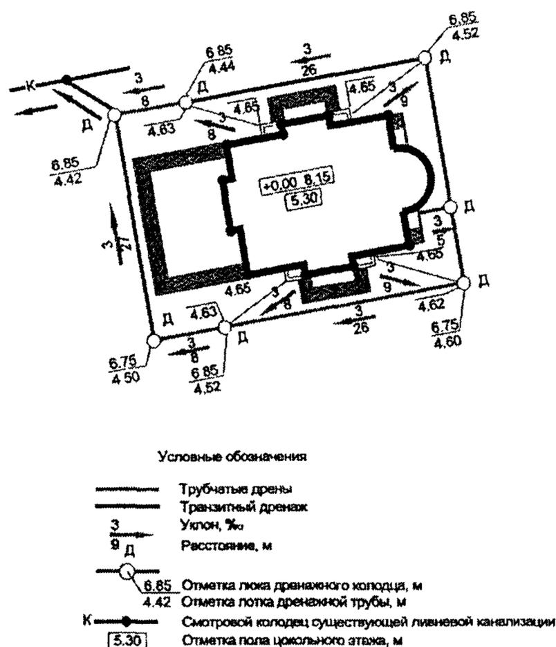
Рис. 3. Схема контурного дренажа с поперечными шпорами
