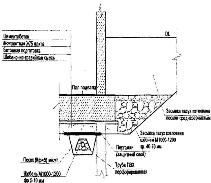
Рис. 1. Схема засыпки пазух котлована
