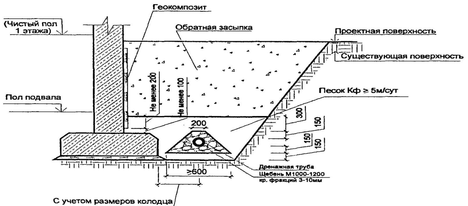
г – с дренажно-изоляционным геокомпозитом
