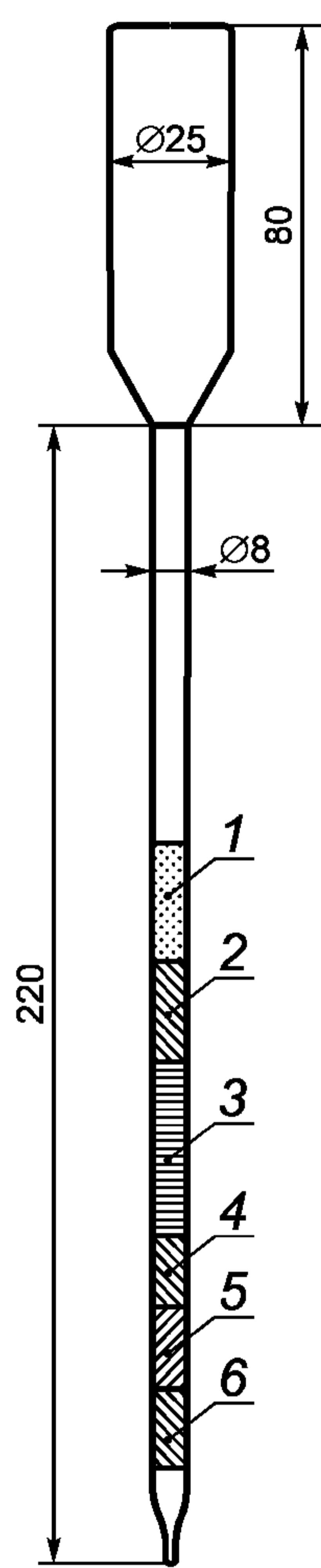
1 — безводный  $\text{Na}_2\text{SO}_4$ ; 2 — активированный  $\text{SiO}_2$ ; 3 —  $\text{SiO}_2/\text{H}_2\text{SO}_4$ ; 4 — активированный  $\text{SiO}_2$ ; 5 —  $\text{SiO}_2/\text{NaOH}$ ; 6 — активированный  $\text{SiO}_2$
