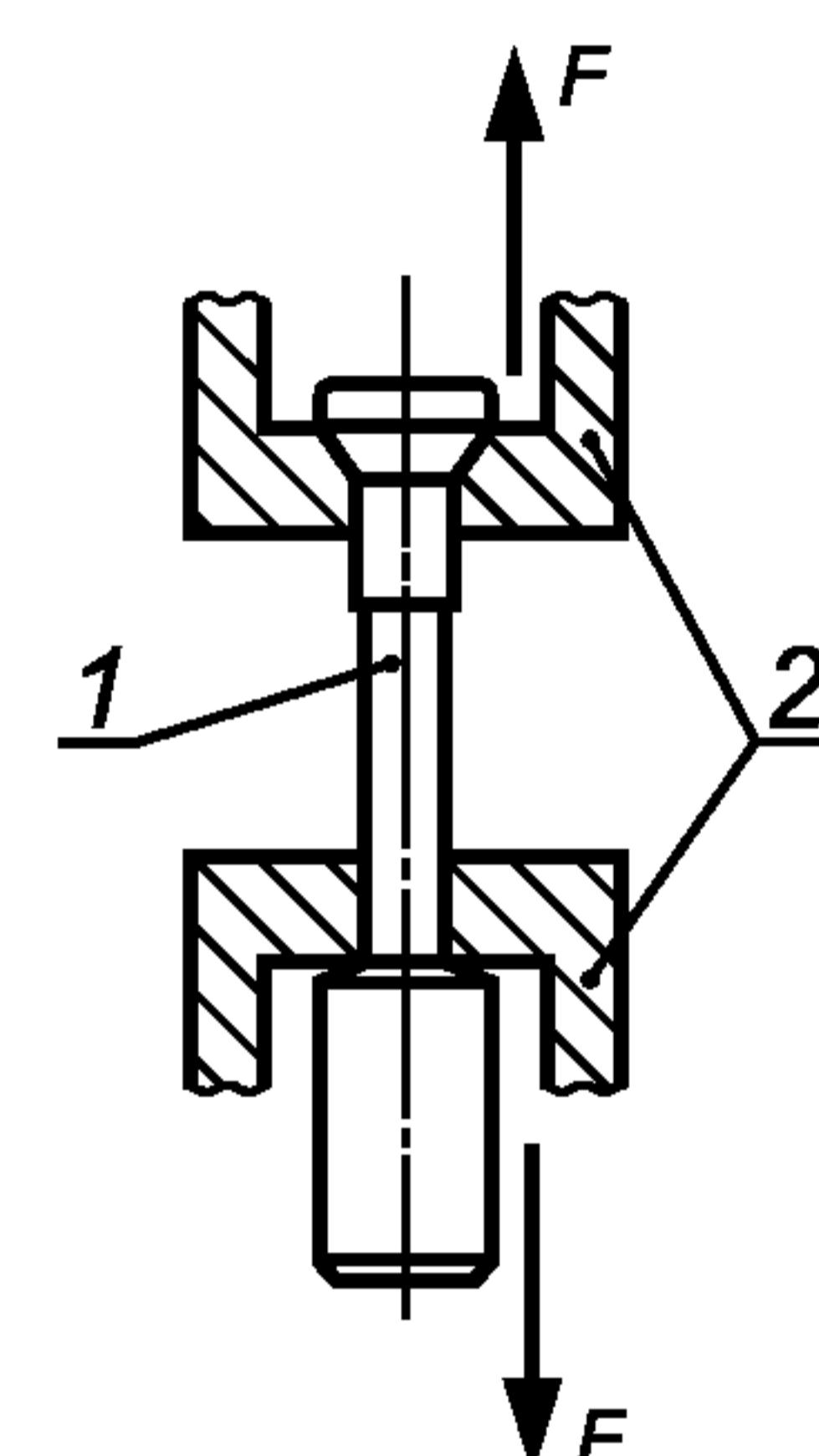
1 — ПУ; 2 — приспособление для крепления и передачи нагрузки
