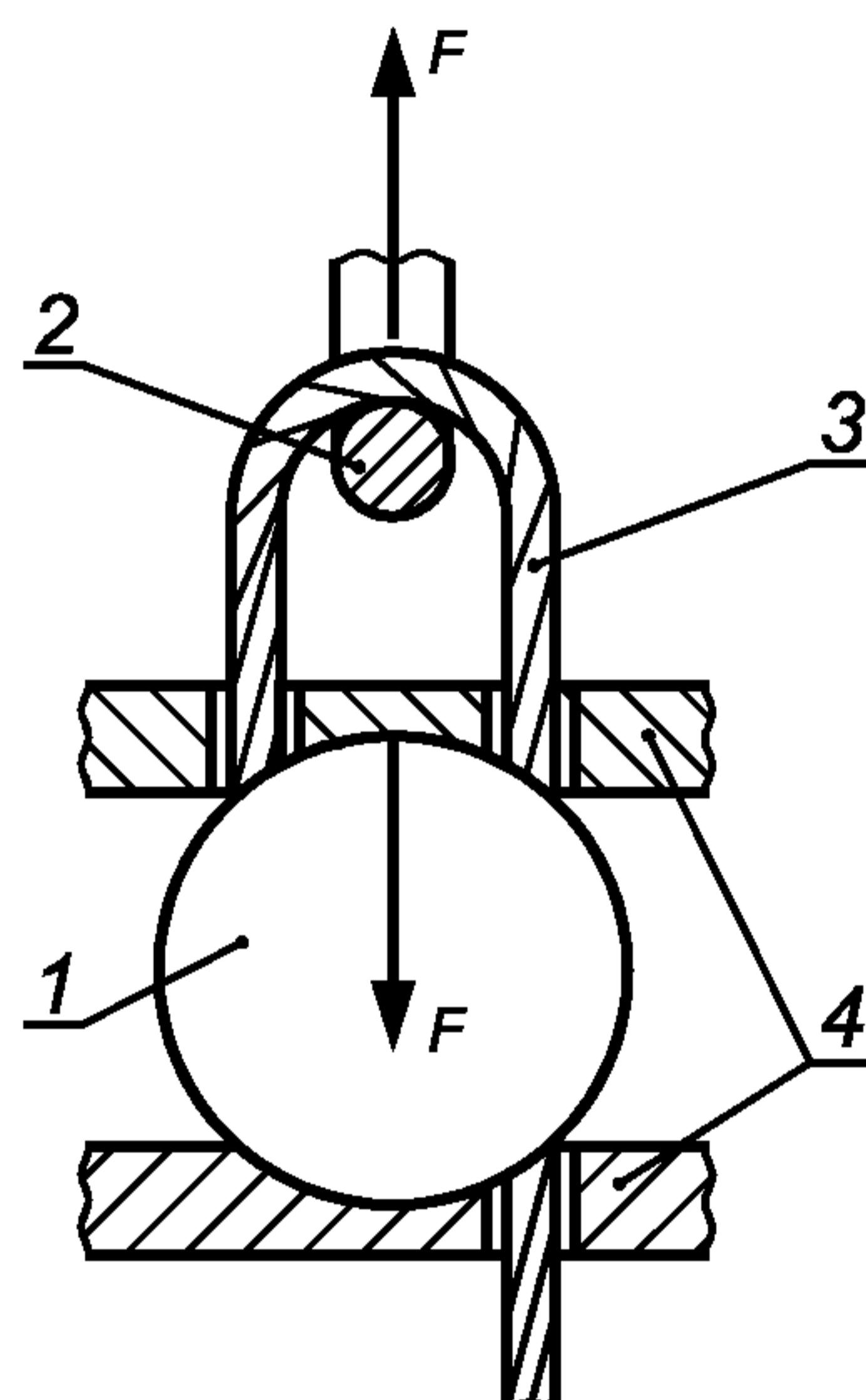
1 — ПУ; 2 — стержень Ø 20 мм для передачи нагрузки;
