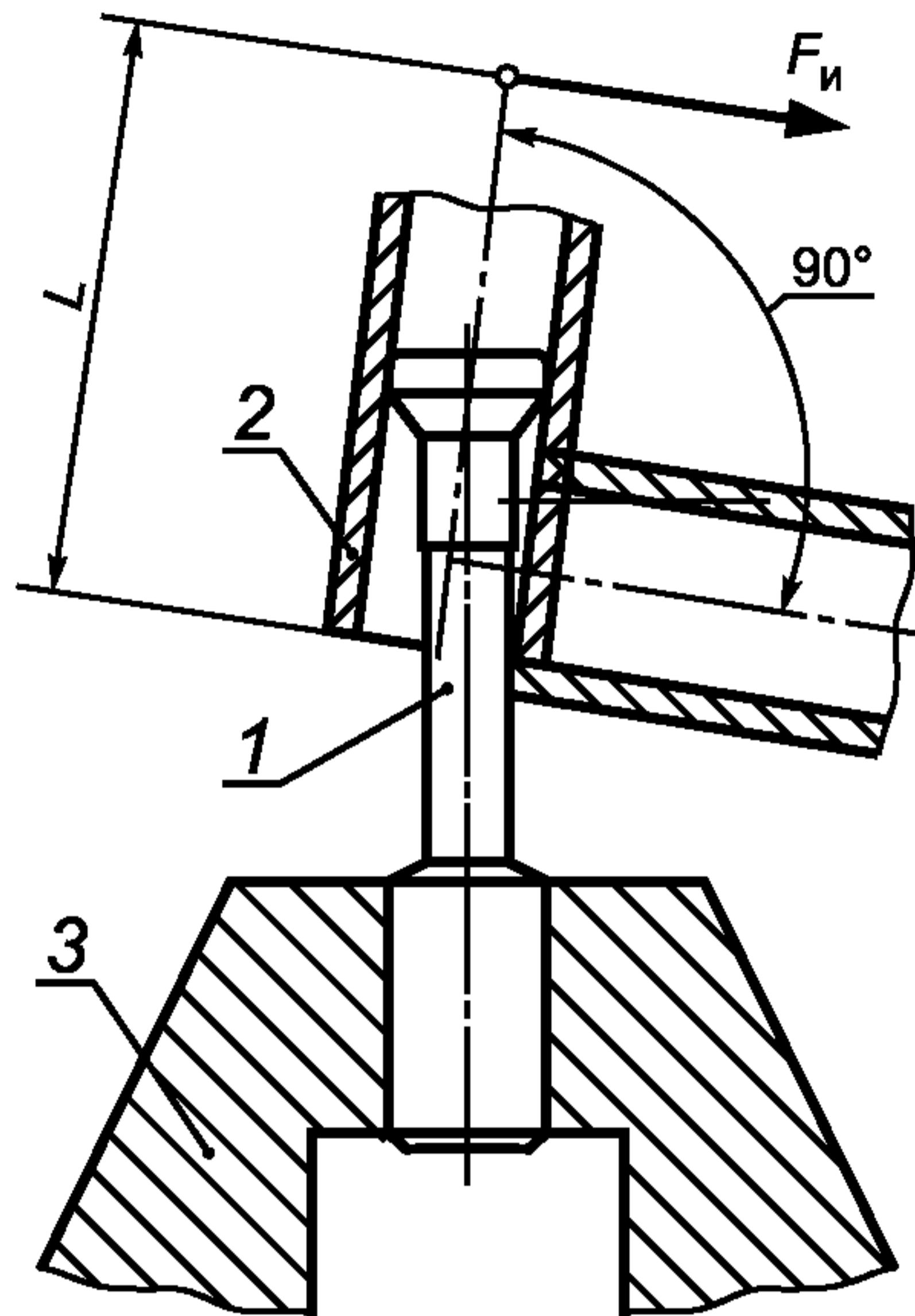
1 — пломба; 2 — рычаг; 3 — приспособление для крепления
