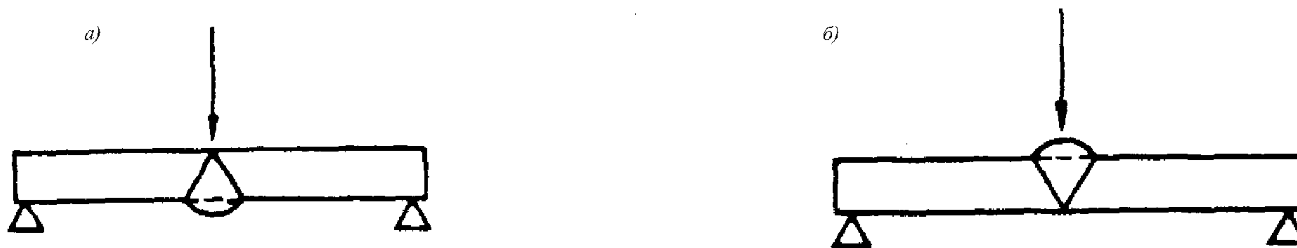
Рис. 4.4.4.4-2 Схема испытаний на излом со стороны усиления корня шва (а) и со стороны шва (б) образцов из пробы стыковых соединений труб Р 3 , Р 5 и Р 6
