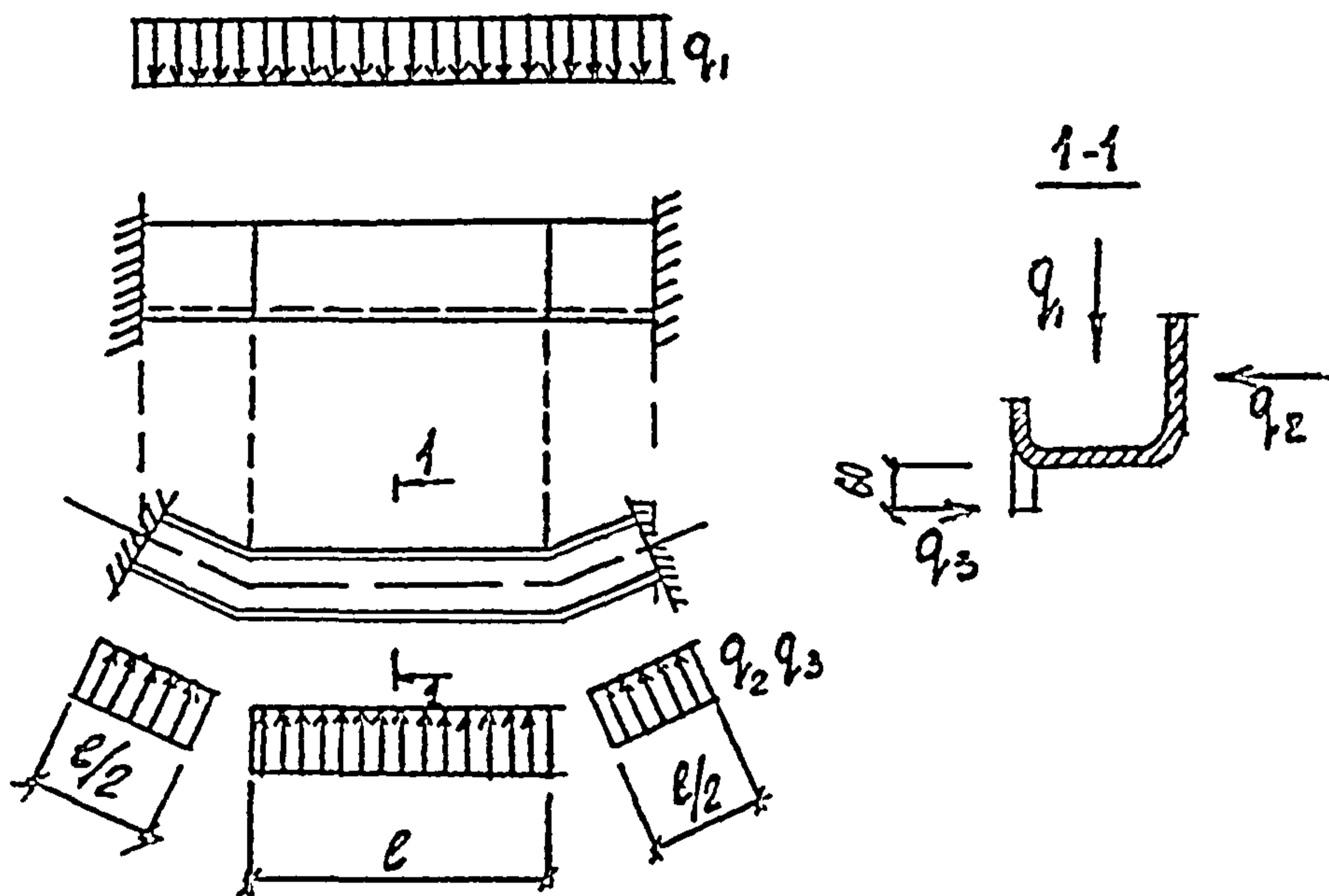
Расчетные нагрузки на лотки
