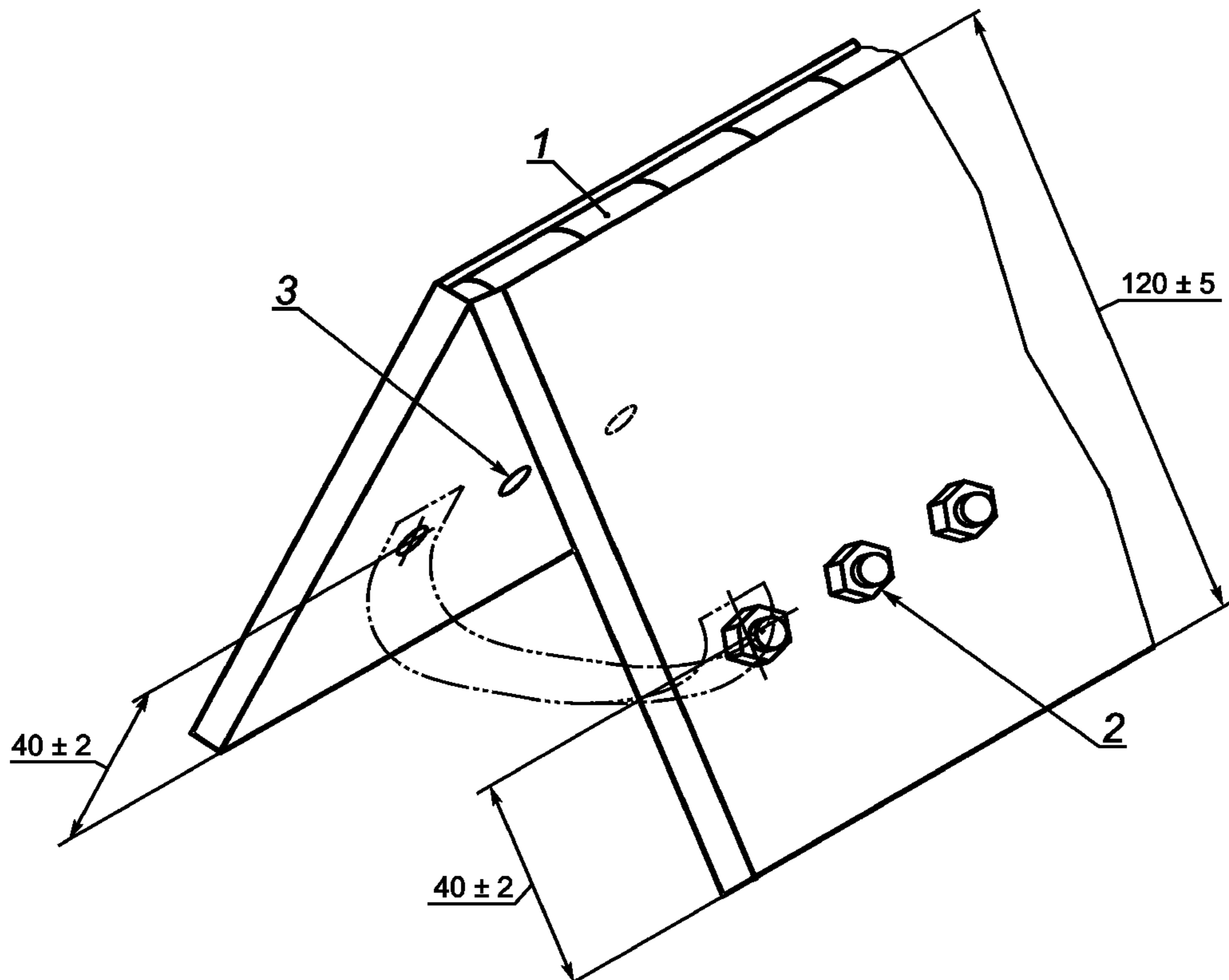
1 — шарнир; 2 — элементы крепления; 3 — отверстия
