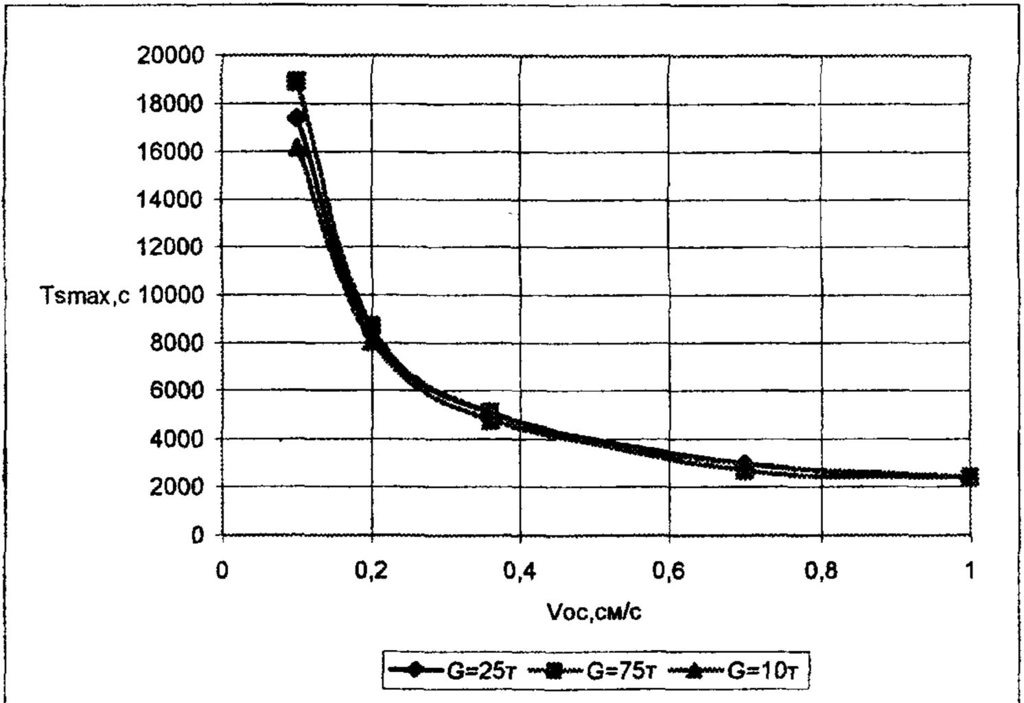
Рисунок 25 - Время  $T_{smax}$  образования на глубине  $d/2$  пятна взвеси наибольших размеров для ПДК=0,75мг/л (а) и ПДК=0,25мг/л (б) при дампинге из трюма землесоса
