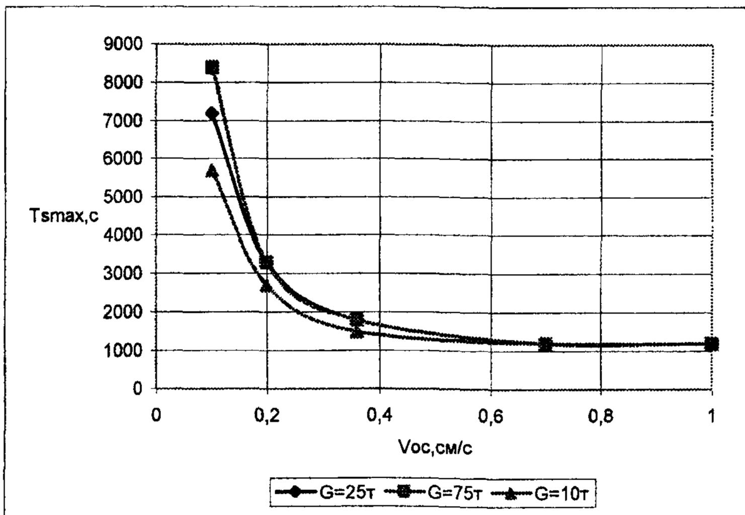
Рисунок 22 - Время  $T_{smax}$  образования на поверхности зон мутности наибольших размеров для ПДК=0,75мг/л (а) и ПДК=0,25мг/л (б) дампинге из трюма землесоса
