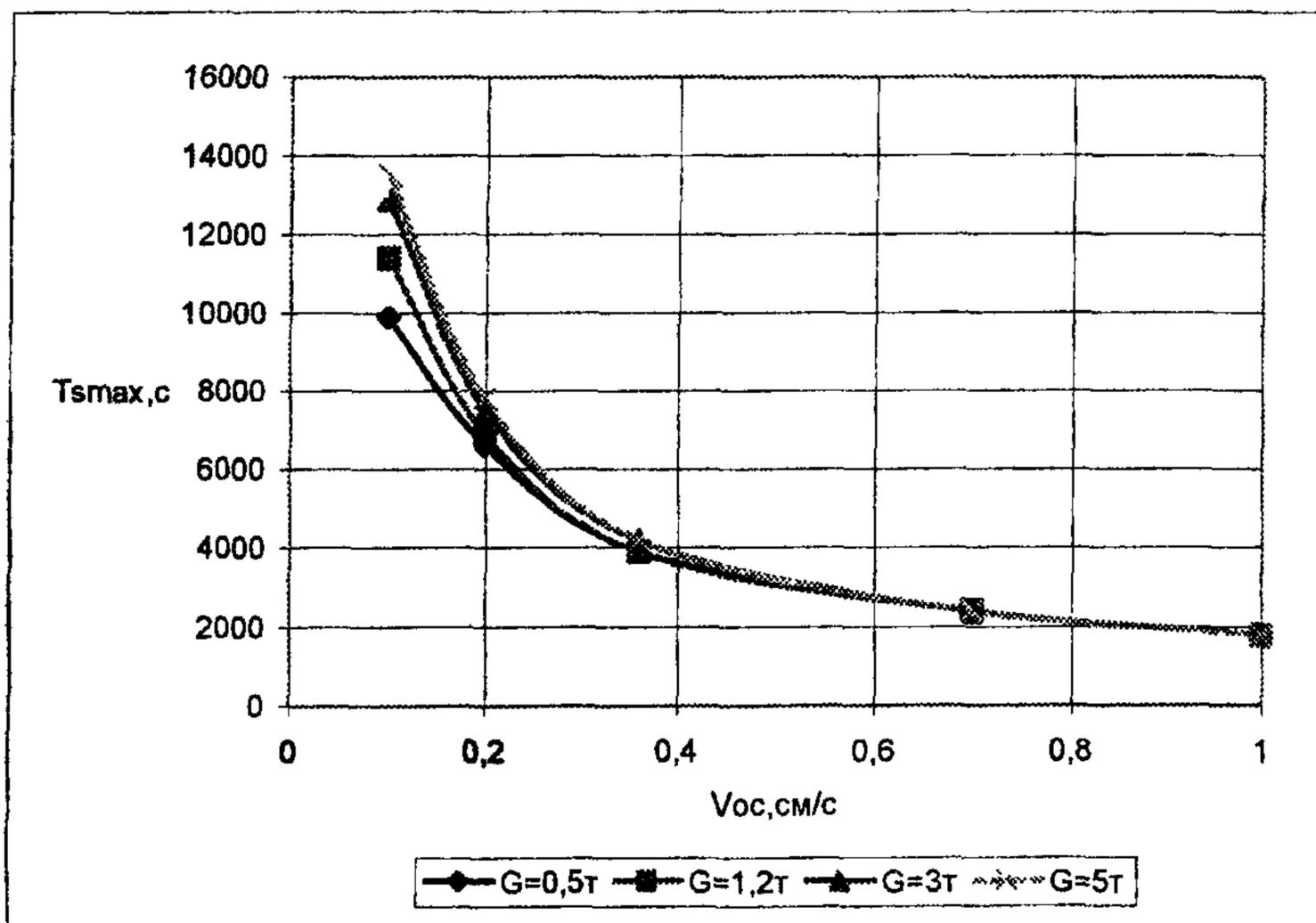
Рисунок 19 - Время  $T_{smax}$  образования на глубине  $d/2$  зон мутности наибольших размеров для ПДК=0,75мг/л (а) и ПДК=0,25мг/л (б) при дампинге из шаланд
