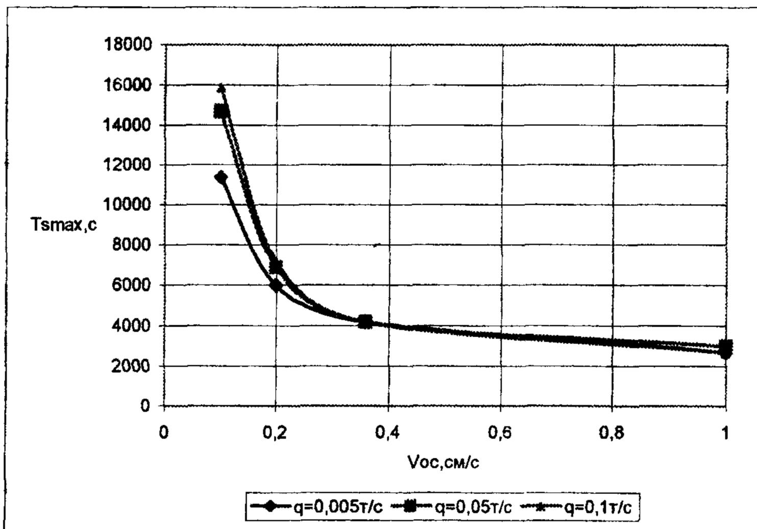
Рисунок 9 - Время  $T_{smax}$  образования на глубине  $d/2$  зон мутности наибольших размеров для ПДК=0,75мг/л (а) и для ПДК=0,25мг/л (б) при сливе из трюма землесоса во время его работы
