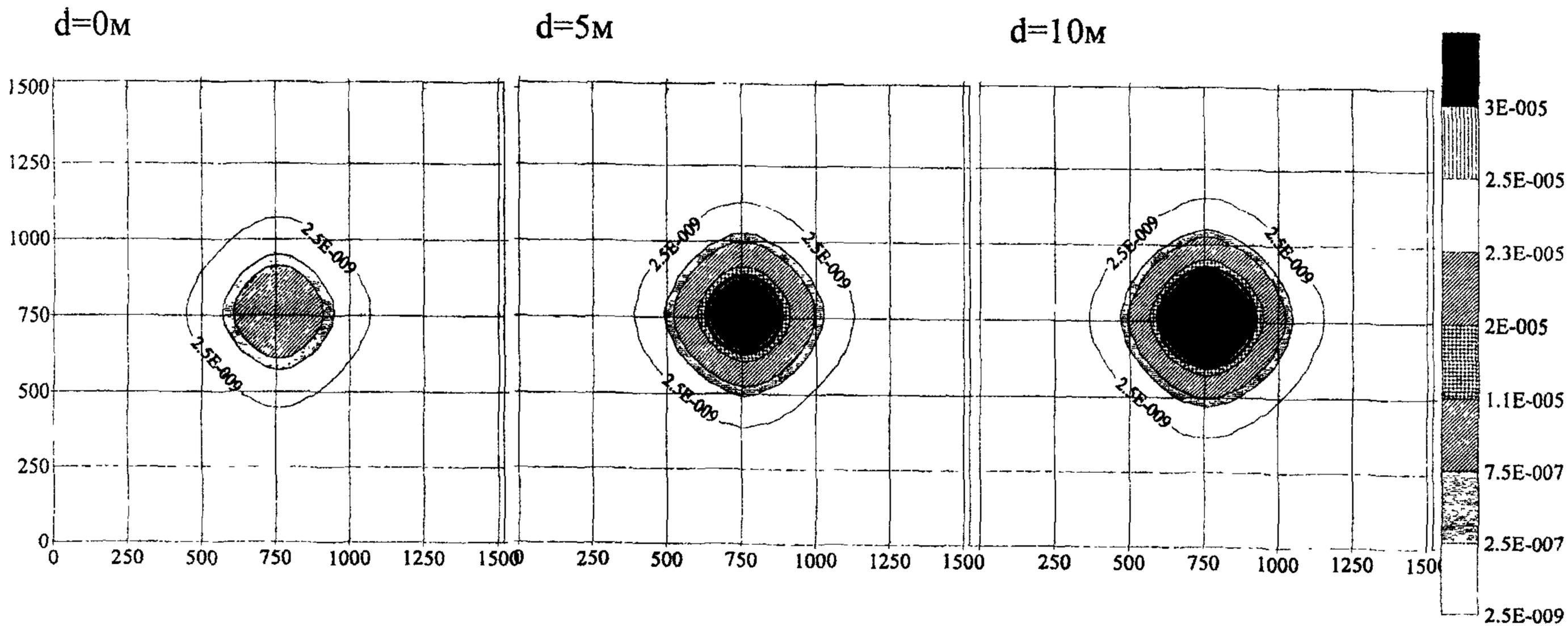
Рисунок Е.2 - Результат расчета по программе DNODAMP концентрации зон мутности при дампинге на трех горизонтах,  $V_{oc}=0,15\text{см/с}$ ,  $q=0,08\text{т/с}$ , длительность разгрузки 12,5 мин., через 1,5 часа после начала разгрузки, течение отсутствует
