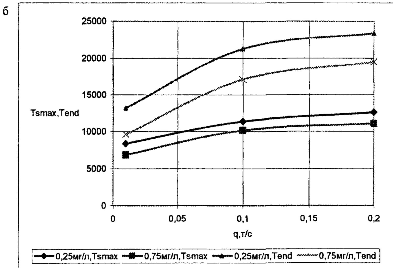
Рисунок 4 - Наибольшие площади зон мутности  $S_{max}$  на глубине  $d/2$  для ПДК=0,75 мг/л и для ПДК=0,25 мг/л (а); моменты  $T_{max}$  достижения зон мутности наибольших размеров и моменты  $T_{end}$  их существования при дноуглублении землесосами  $V_{oc}=0,01$  см/с (б)
