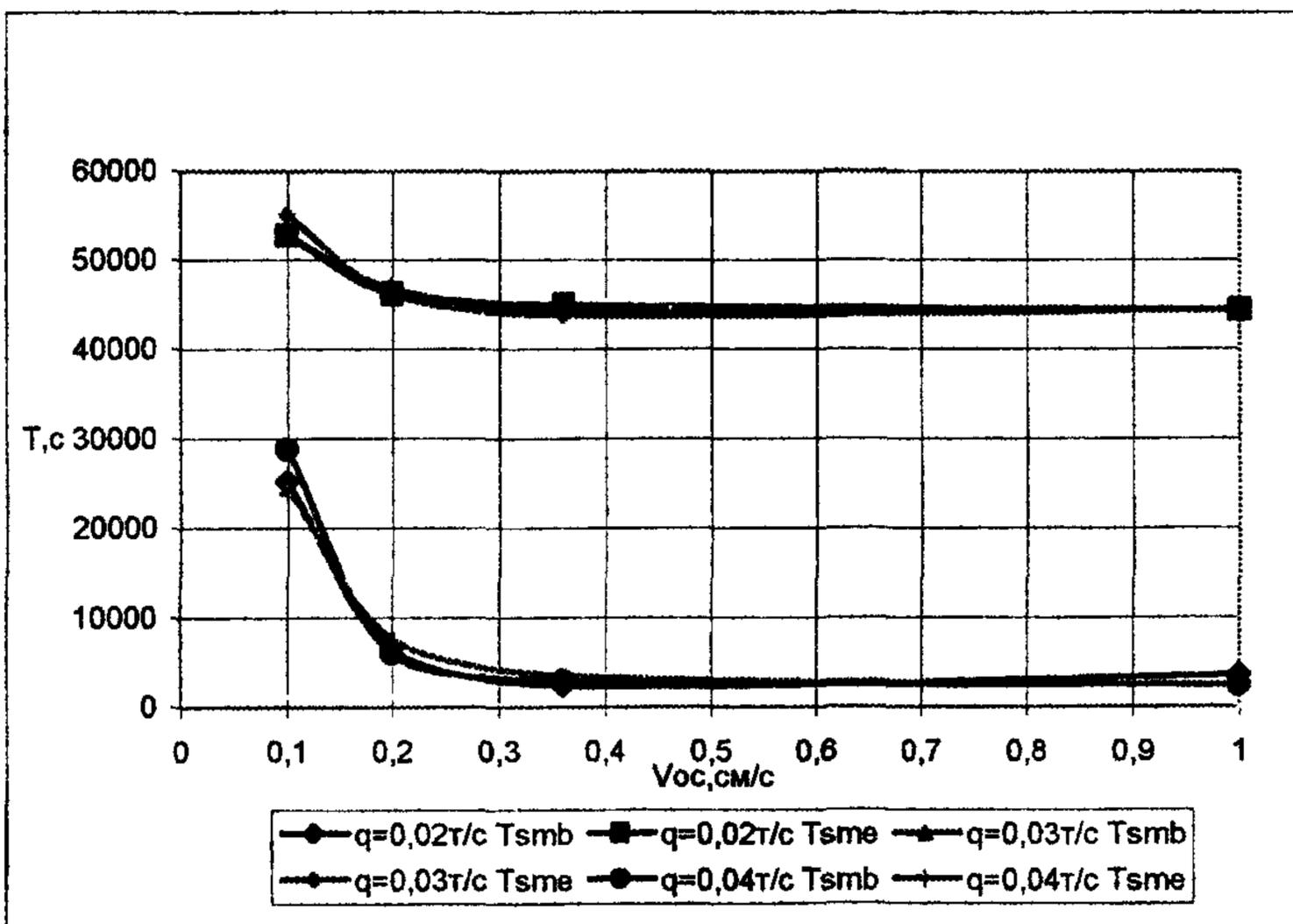
Рисунок 12 - Время  $T_{smb}$  достижения зонами мутности наибольших размеров на дне и момент  $T_{sme}$  начала их уменьшения для ПДК=0,75мг/л(а) и для ПДК=0,25мг/л(б) при дноуглублении черпаковыми земснарядами
