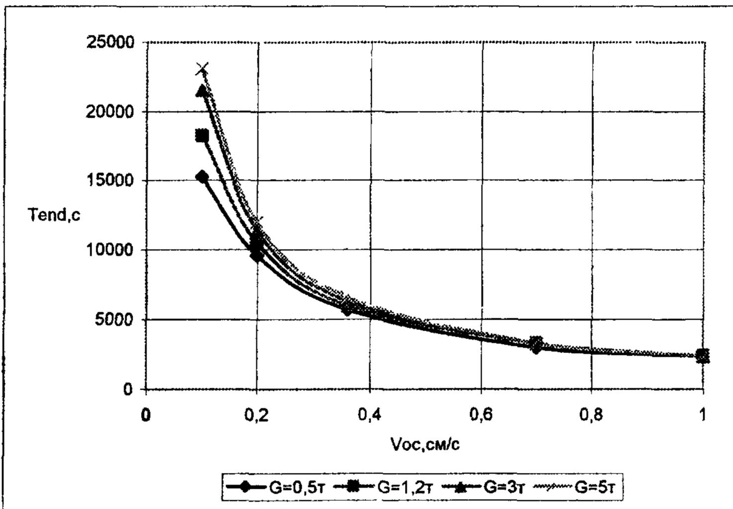
Рисунок 20 - Время  $T_{енд}$  существования зон мутности на глубине  $d/2$  для ПДК=0,75мг/л (а) и для ПДК=0,25мг/л (б) при дампинге из шаланд
