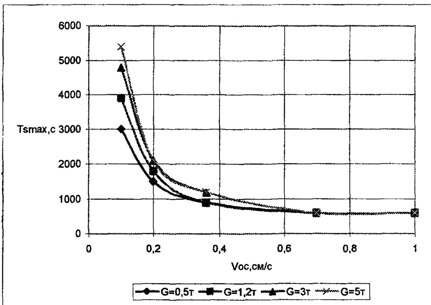
Рисунок 16 - Время  $T_{smax}$  образования на поверхности зон мутности наибольших размеров для ПДК=0,75мг/л (а) и ПДК=0,25мг/л (б) при дампинге из шаланд
