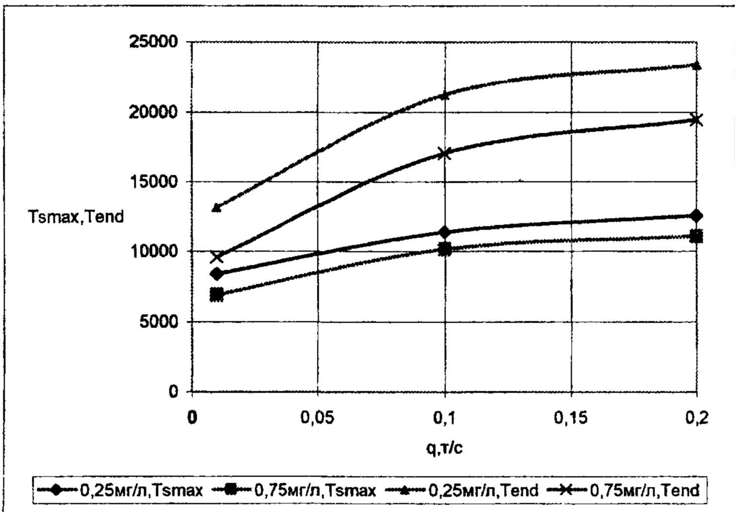
Рисунок 14 - Наибольшие площади зон мутности  $S_{max}$  на глубине  $d/2$  для ПДК=0,75 мг/л и ПДК=0,25 мг/л (а); моменты  $T_{max}$  образования зон мутности наибольших размеров и их существования  $T_{end}$  (б) при дноуглублении черпаковыми земснарядами,  $V_{oc}=0,01$  см/с
