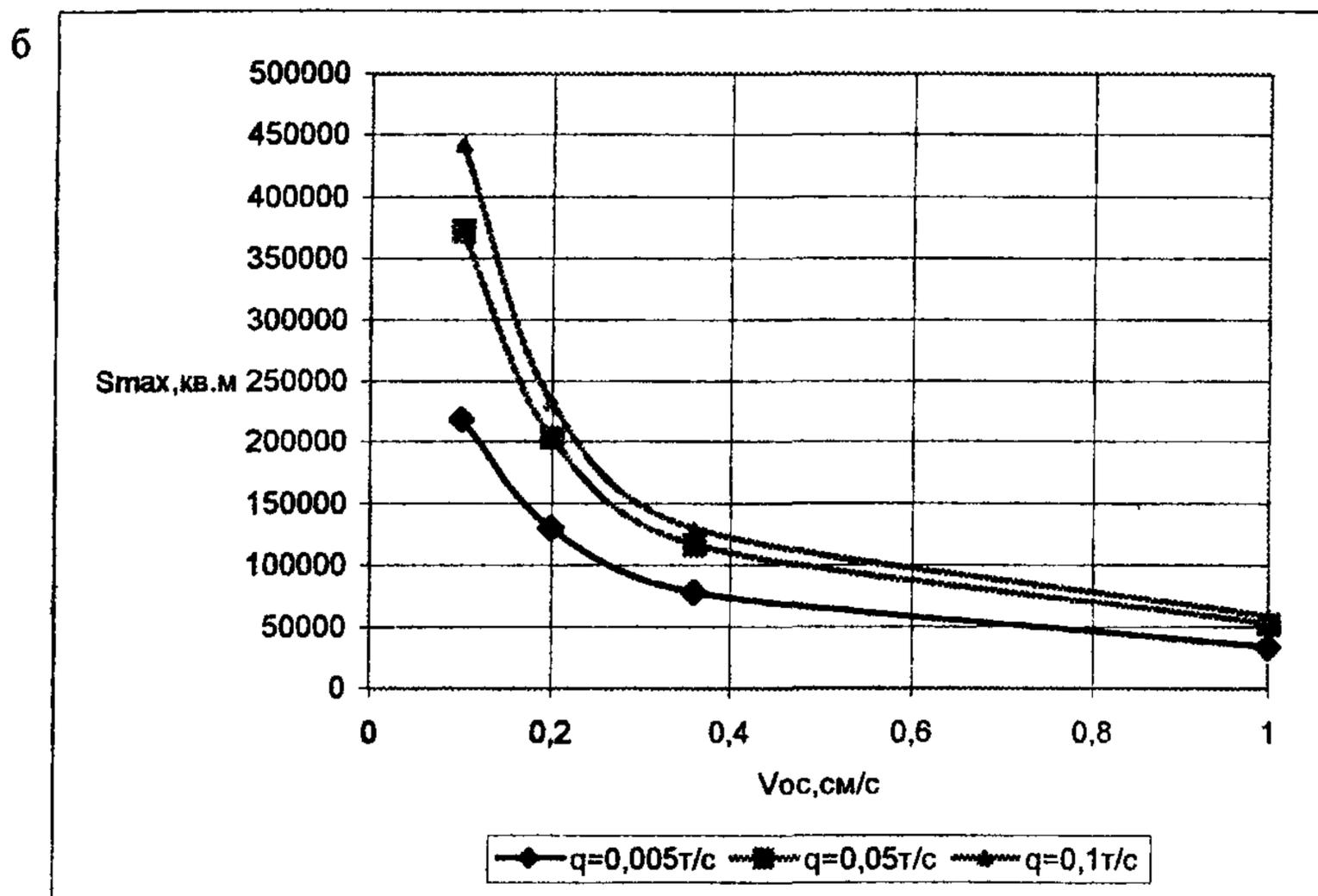
Рисунок 8 - Наибольшие площади  $S_{max}$  зон мутности на глубине  $d/2$  для ПДК=0,75 мг/л (а) и для ПДК=0,25 мг/л (б) при сливе из трюма землесоса во время его работы
