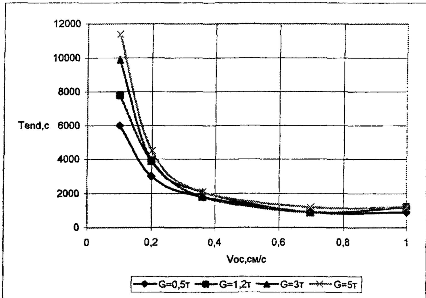
Рисунок 17 - Время  $T_{end}$  существования зон мутности на поверхности для ПДК=0,75 мг/л (а) и для ПДК=0,25 мг/л (б) при дампинге из шаланд
