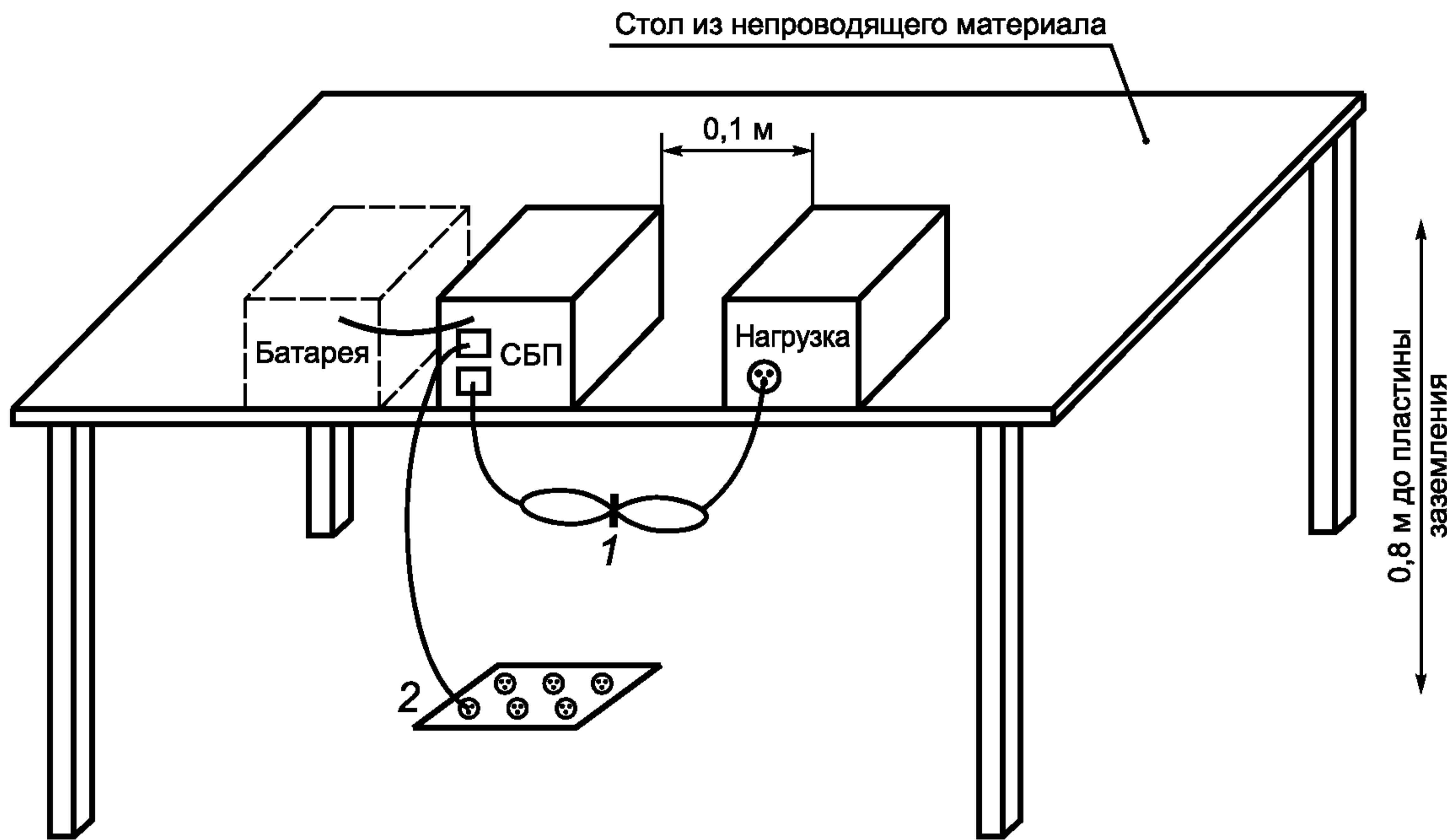
1 — соединительные кабели, проходящие на расстоянии менее 40 см от пластины заземления, которые не могут быть укорочены до подходящей длины; укладывают в связки длиной от 30 до 40 см; 2 — штепсельная колодка, находящаяся на уровне пластины заземления и соединенная с ней
