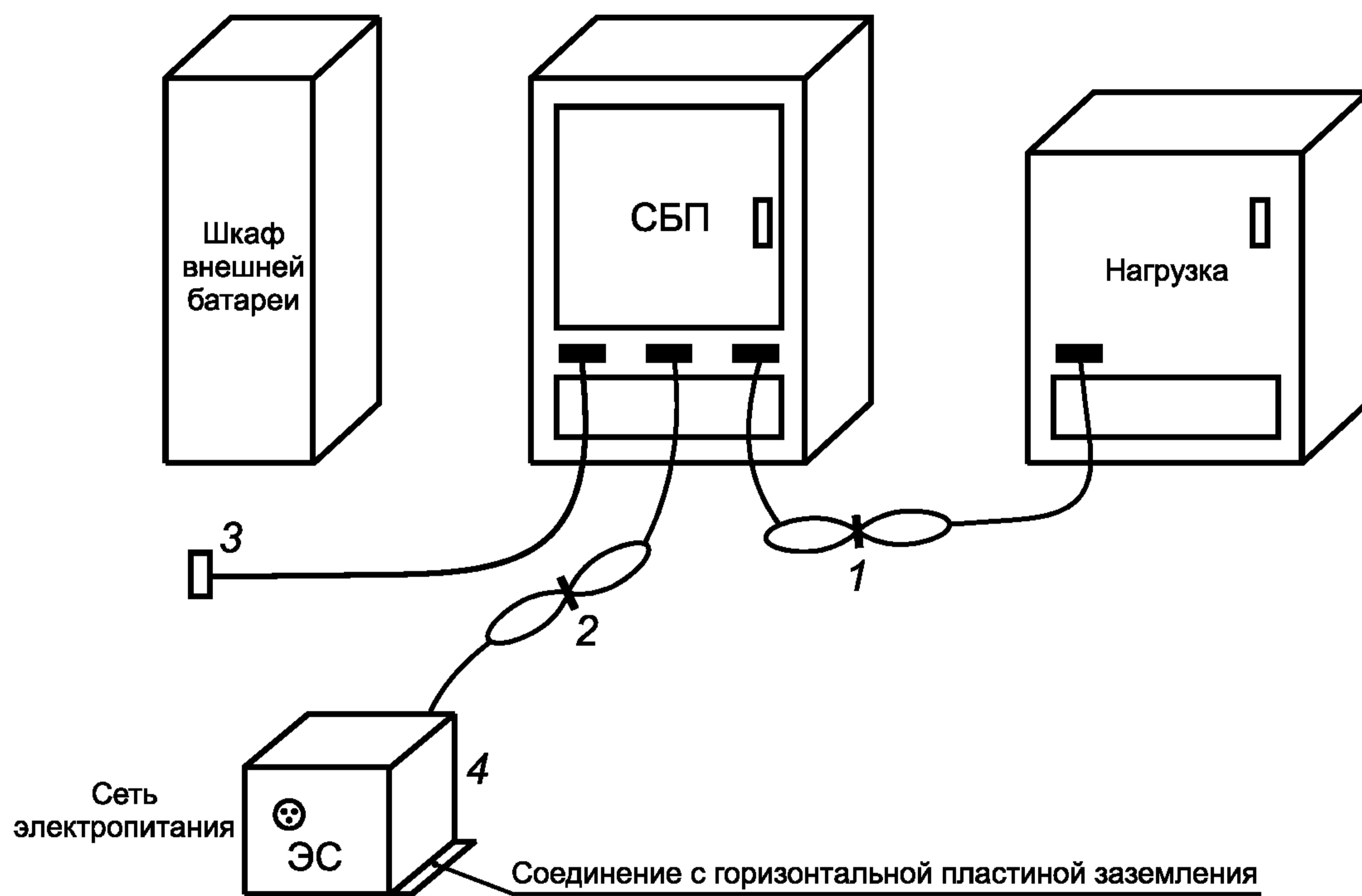
ЭС — эквивалент сети; 1, 2 — излишки кабелей укладывают в связки, расположенные в центральной части, или укорачивают; 3 — концы кабелей, которые не подключаются к внешним устройствам — нагружают на соответствующие сопротивления нагрузки; 4 — СБП подсоединяют к эквиваленту сети, который располагают над горизонтальной пластиной заземления или непосредственно под пластиной заземления
