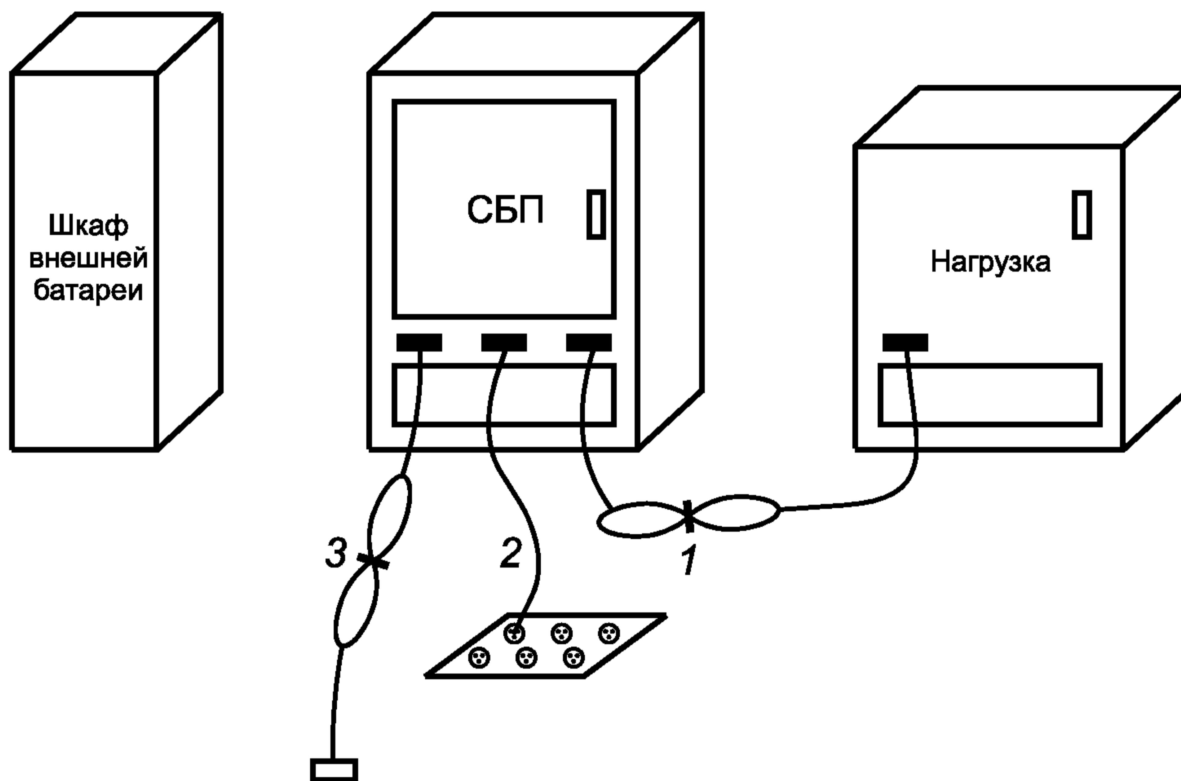
1 — излишки соединительных кабелей ввода — вывода укладывают в связки (если укладка в связки невозможна, кабелям придают форму змеевика); 2 — излишки сетевых кабелей укладывают в связки или кабели укорачивают; 3 — концы кабелей, которые не подключаются к внешним устройствам, нагружают на соответствующие сопротивления нагрузки, излишние части кабелей укладывают в связки
