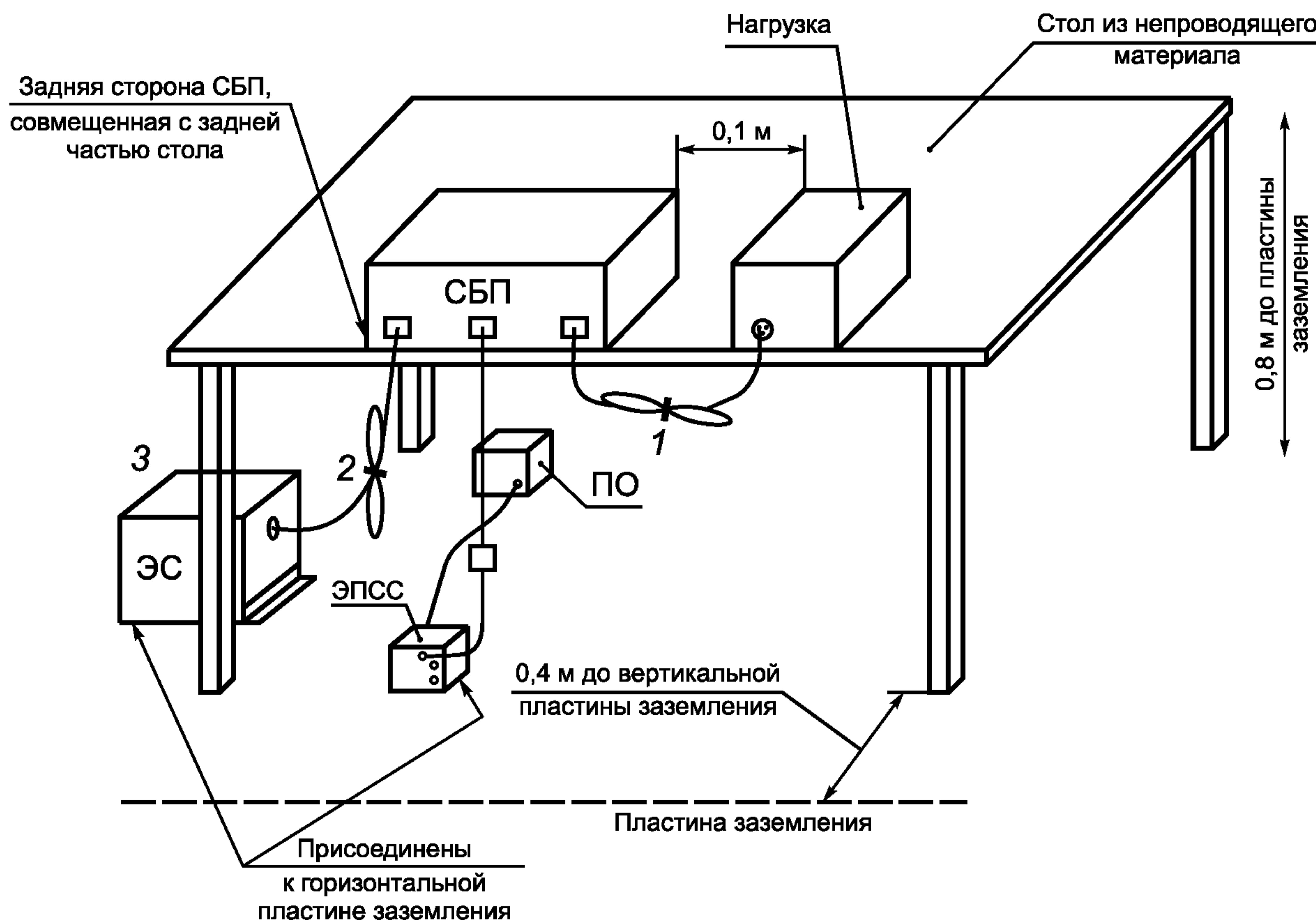
ЭС — эквивалент сети; ЭПСС — эквивалент полного сопротивления сети; ПО — подключаемое оборудование; 1 — соединительные кабели, проходящие на расстоянии менее 40 см от горизонтальной пластины заземления, которые не могут быть укорочены до подходящей длины, укладываются в связки длиной от 30 до 40 см; 2 — излишки сетевого шнура укладываются в связку, расположенную в центральной части, или шнур укорачивают; 3 — СБП подсоединяют к эквиваленту сети, размещенному на расстоянии 80 см от СБП
