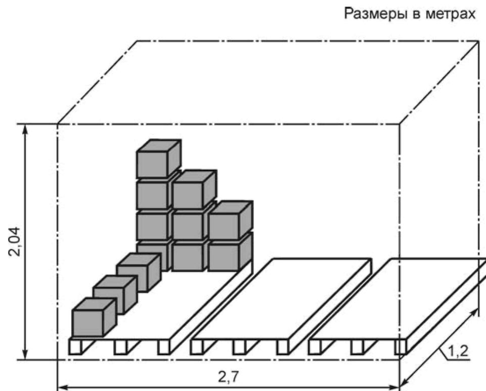
Рисунок В.1 — Схема зоны погрузки
