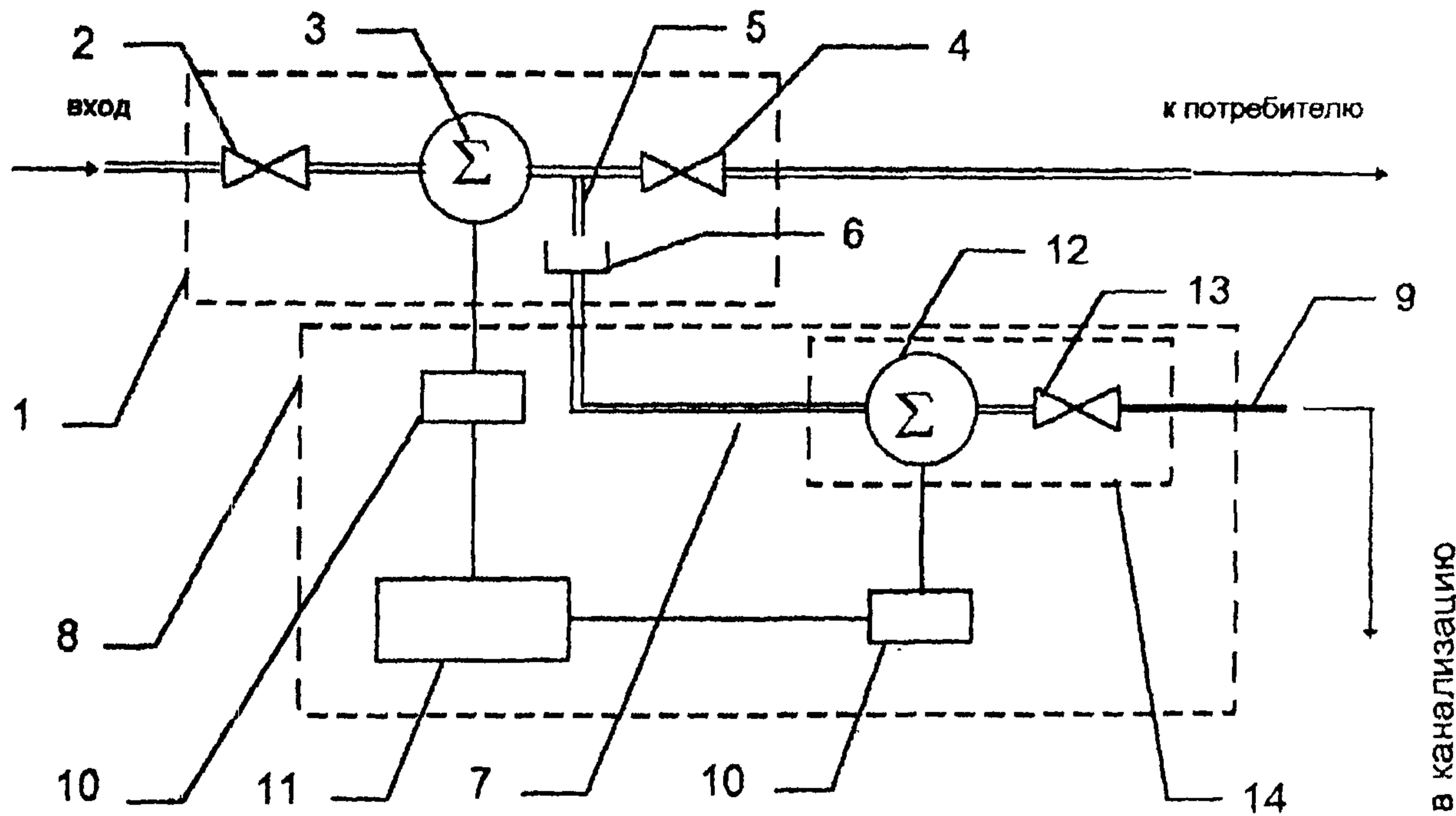
1. Узел установки счетчика воды.
