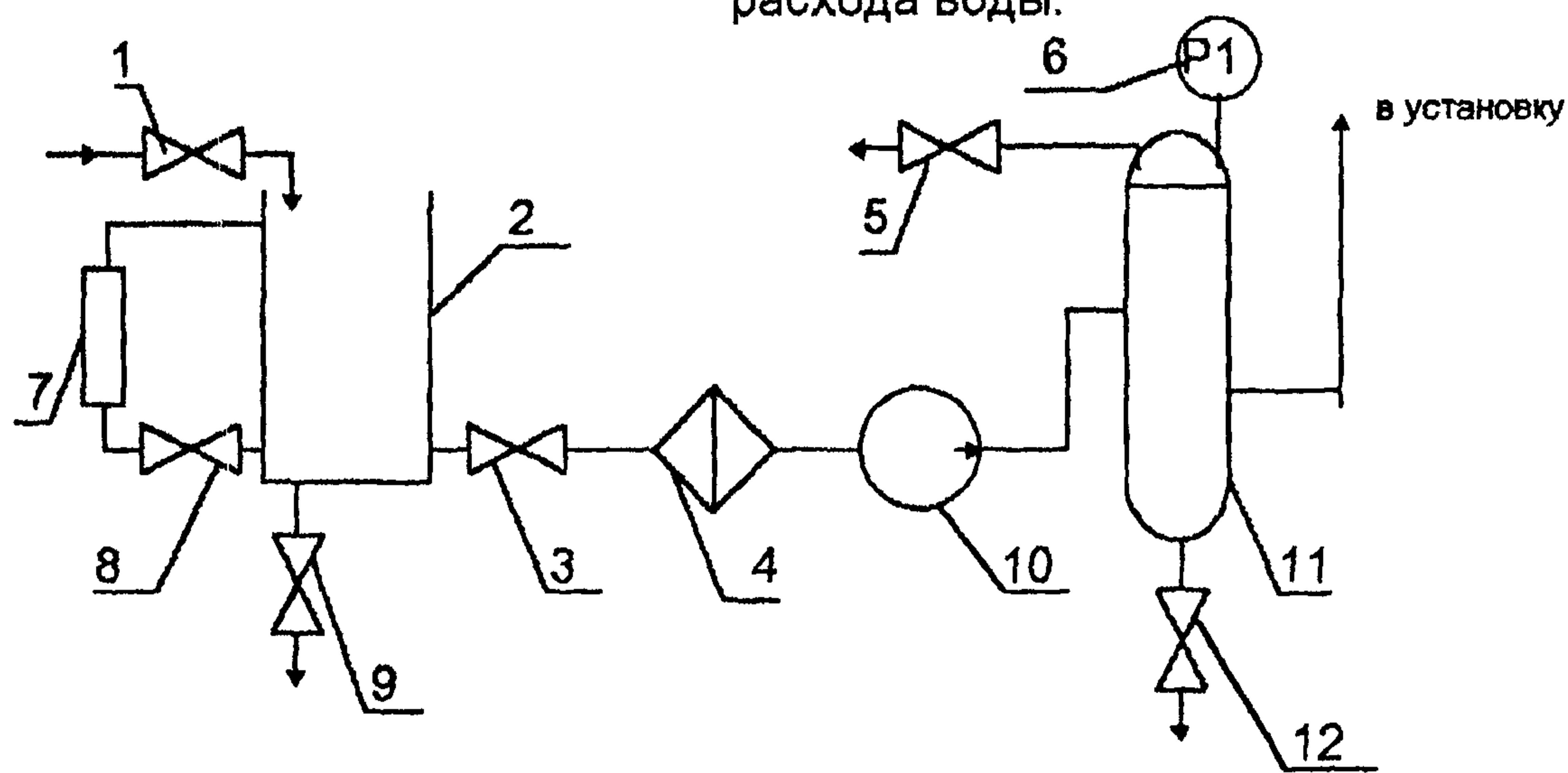
1,3,5,8,9,12 - вентиль; 2 - резервуар; 4 - фильтр; 6 - манометр;
