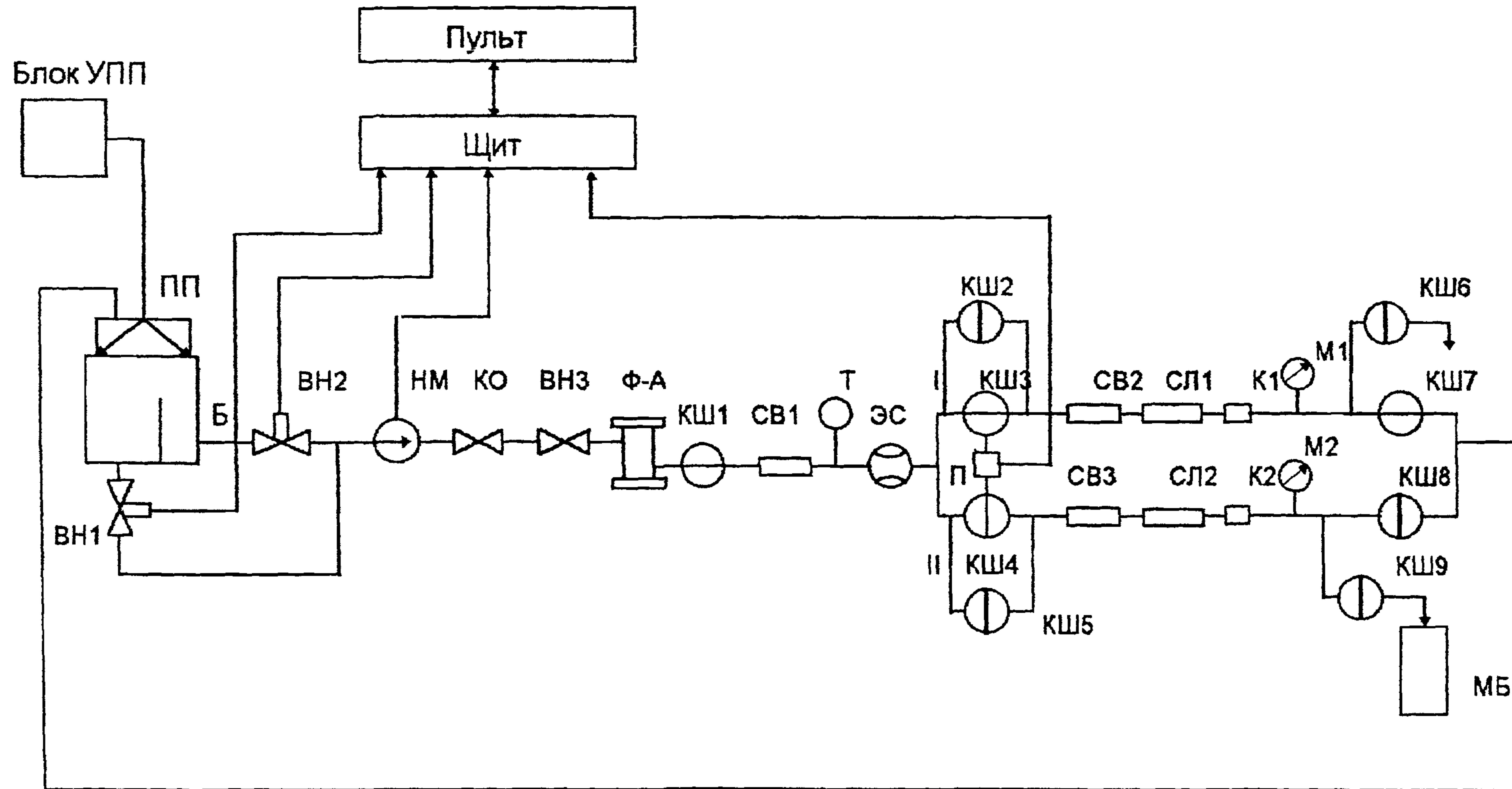
Б - измерительный узел; Блок УПП - блок управления переключателем потока; ПП- переключатель потока; НМ - насос;
