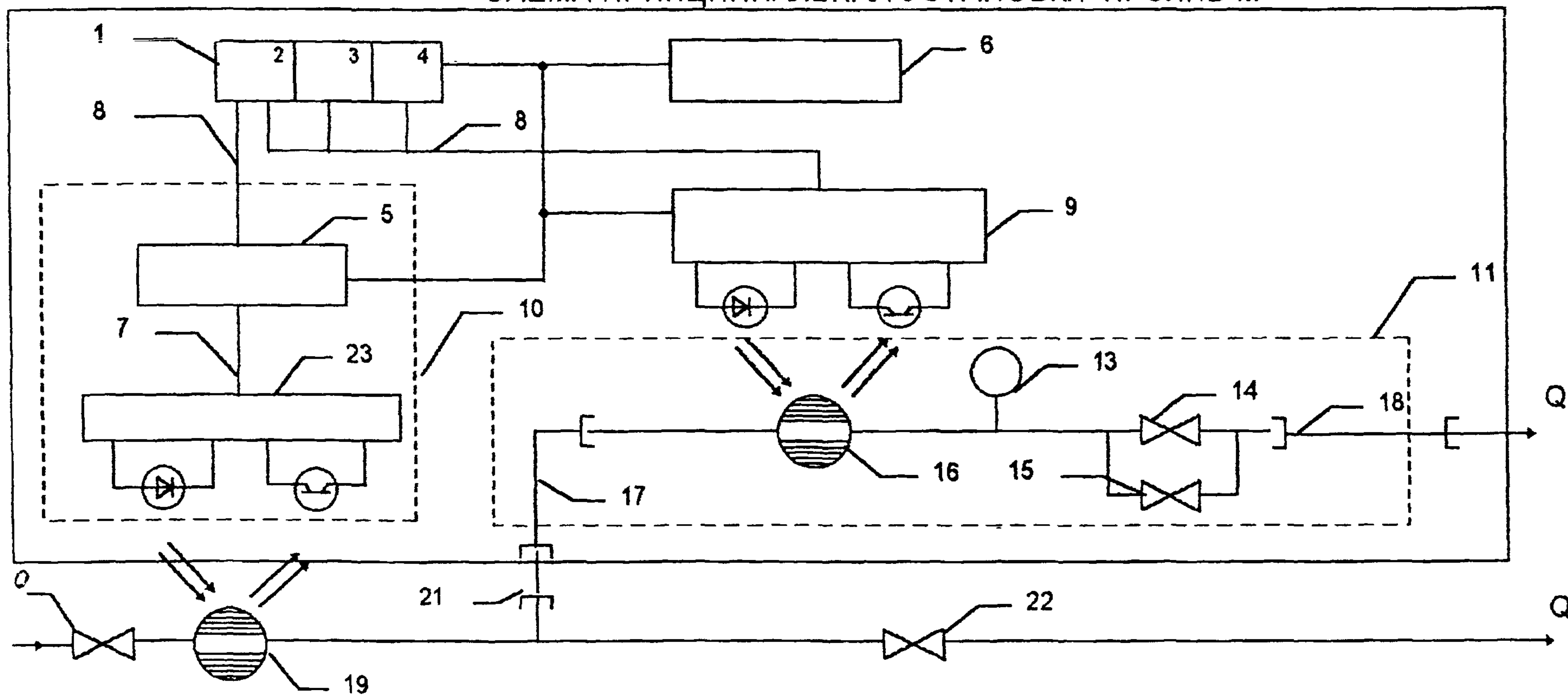
1- блок электронный; 2- счетчик импульсов (объема) ; 3- счетчик импульсов (объема) с предустановкой;
