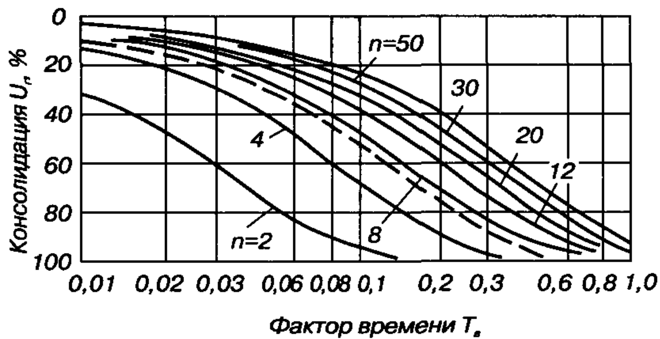
Рис. 10.2.2. Графики для определения степени консолидации грунта основания с вертикальными дренажами
