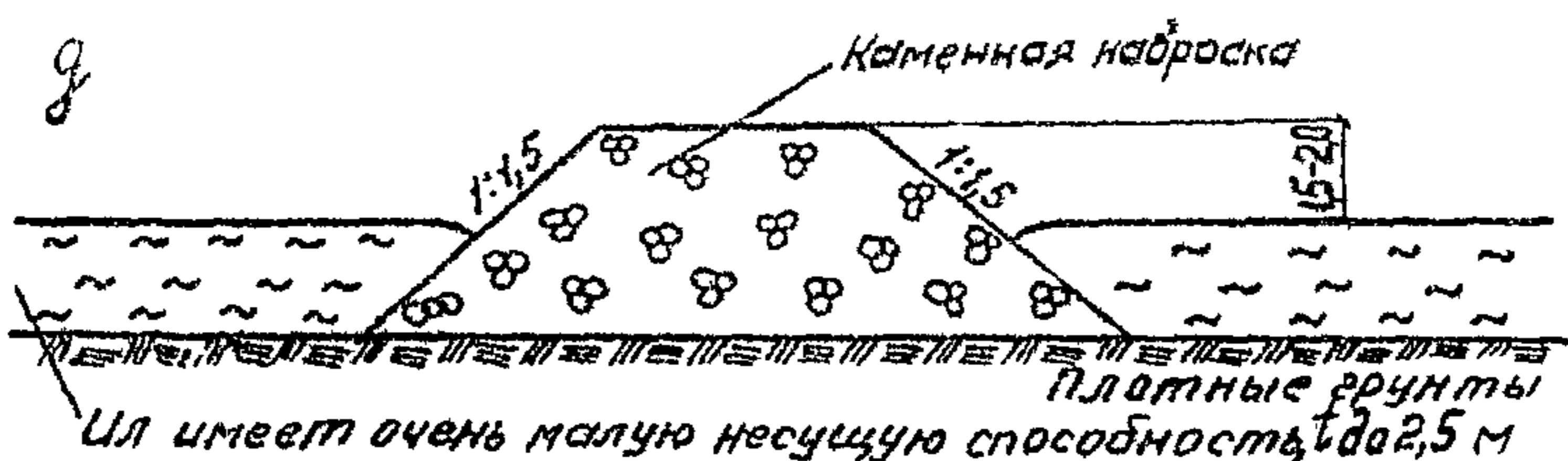
Рис.4.2. Схемы постелей измерительных стендов, применяемых на ильистых грунтах
