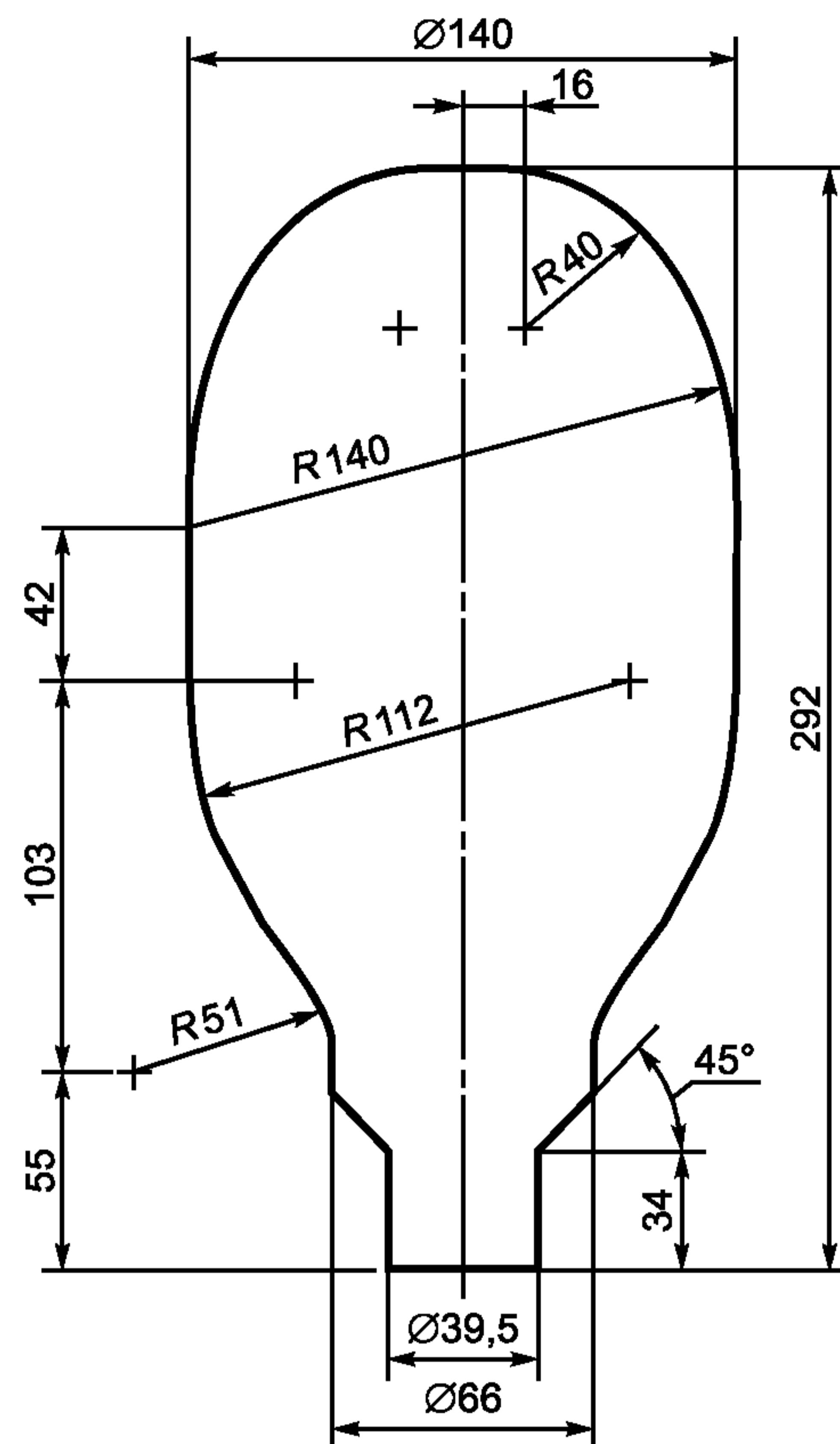
Рисунок G.4 — Эллипсоидная лампа мощностью 400 Вт
