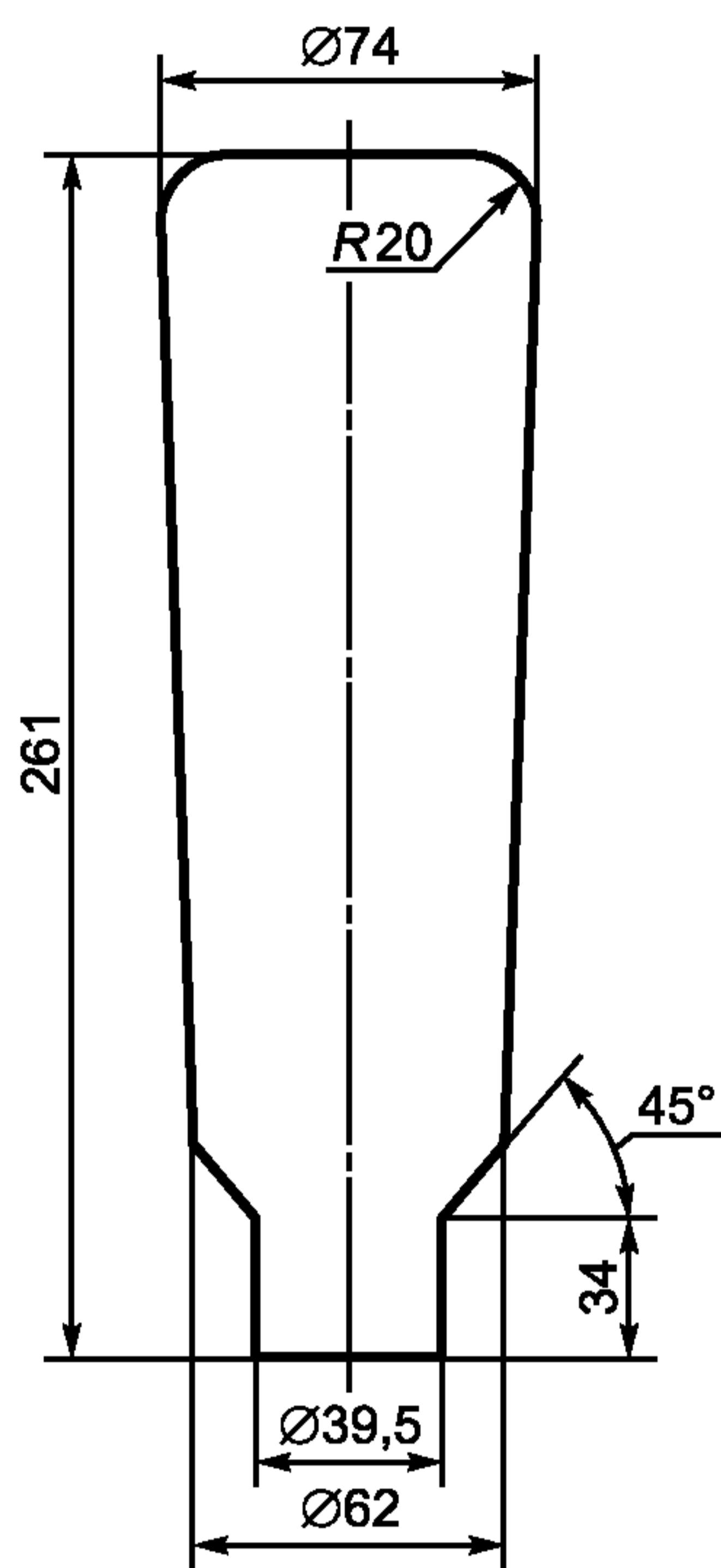
Рисунок G.1 — Трубчатая лампа
