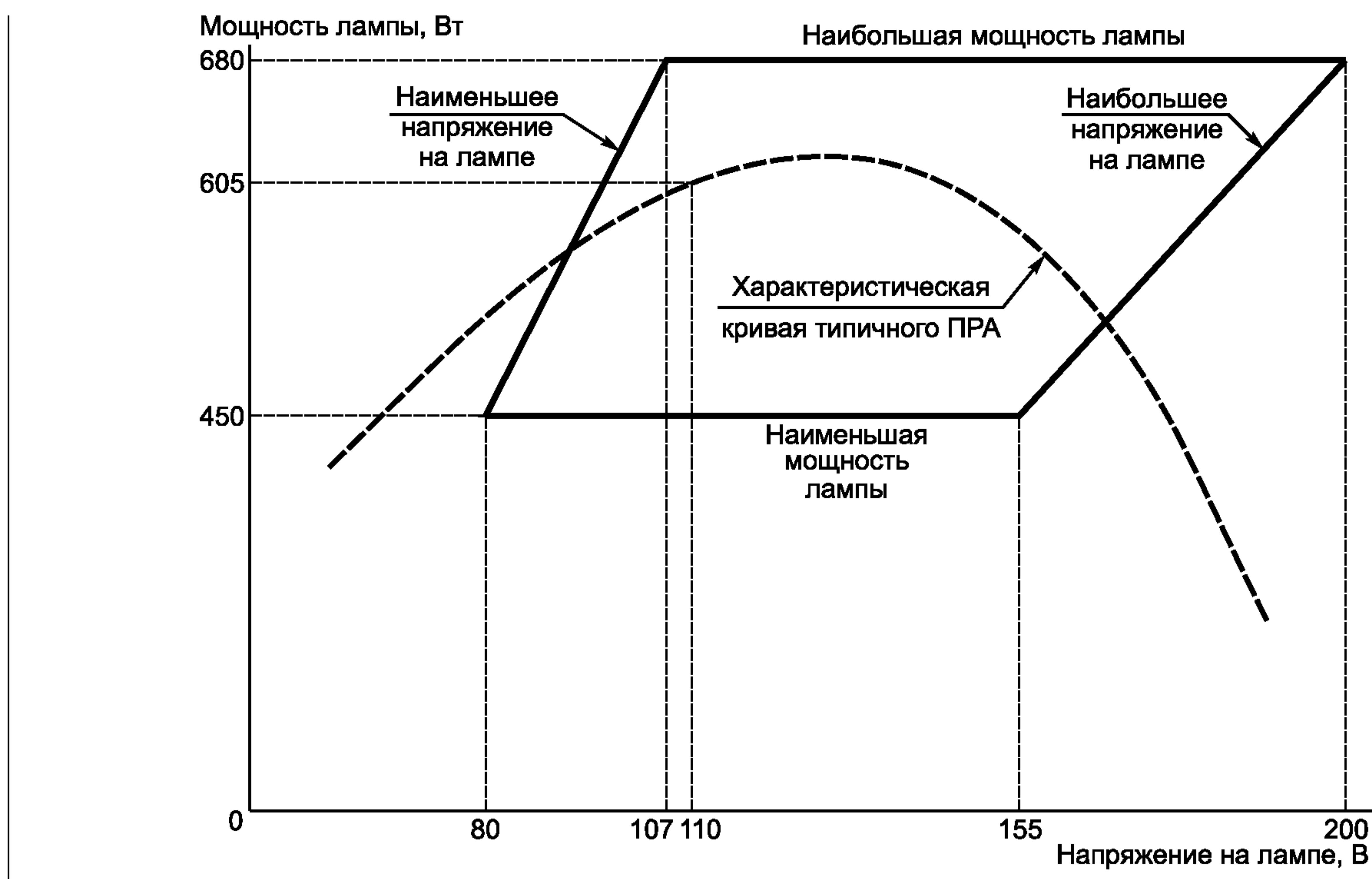
Рисунок Н.17 — Предельные рабочие характеристики ламп номинальной мощностью 600 Вт с трубчатой прозрачной колбой
