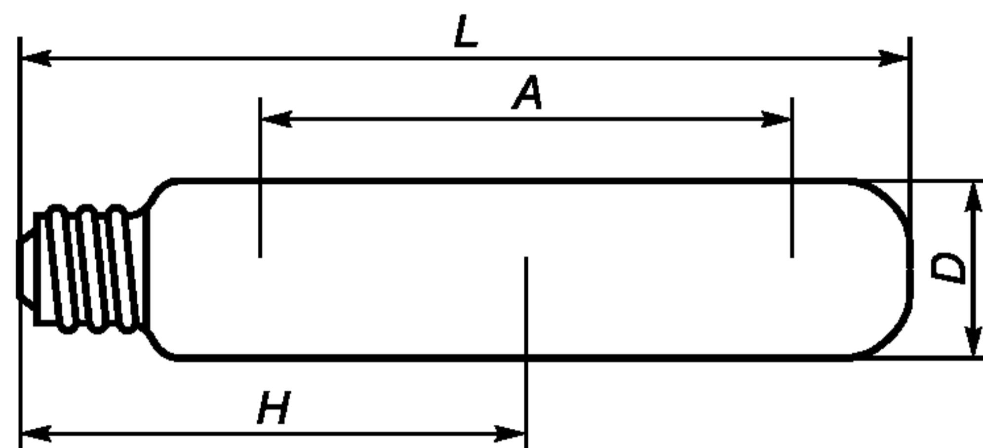
$A$  — длина дуги;  $H$  — высота светового центра;  $D$  — диаметр колбы;  $L$  — полная длина
