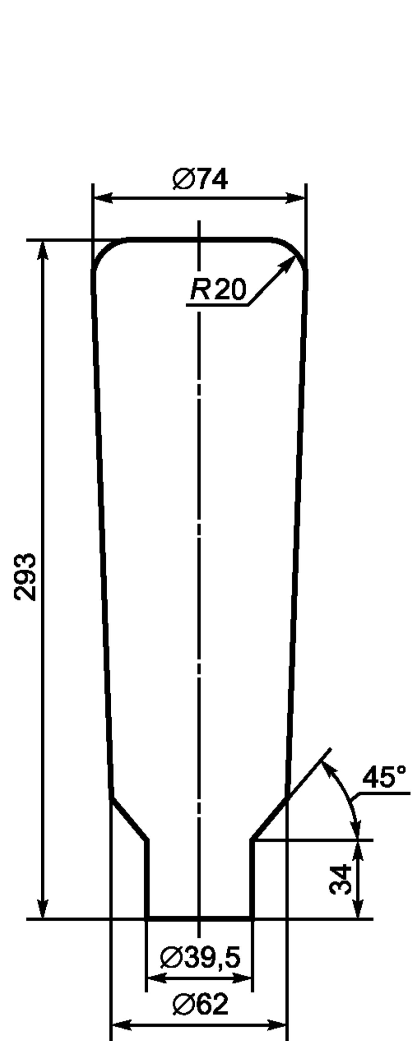
Рисунок G.3 — Трубчатая лампа мощностью 400 Вт
