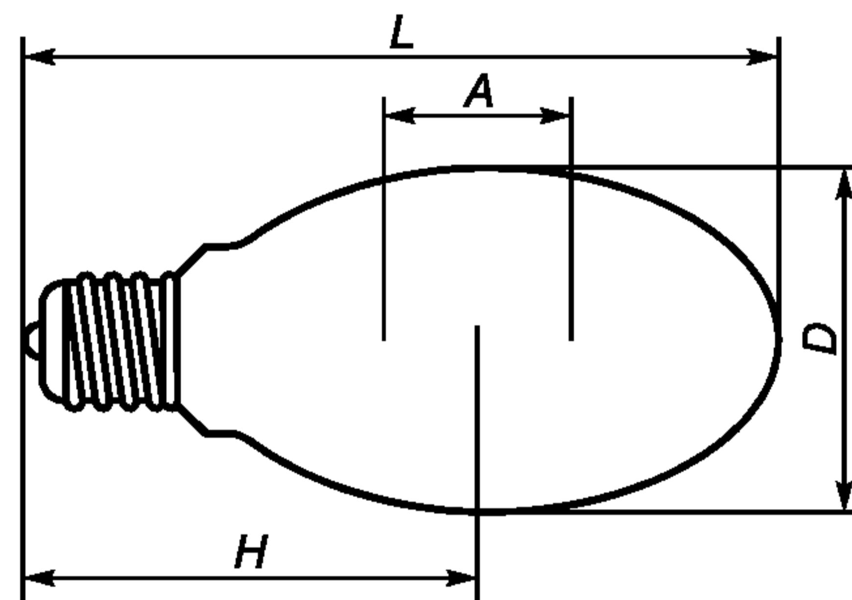
$A$  — длина дуги;  $H$  — высота светового центра;  $D$  — диаметр колбы;  $L$  — полная длина
