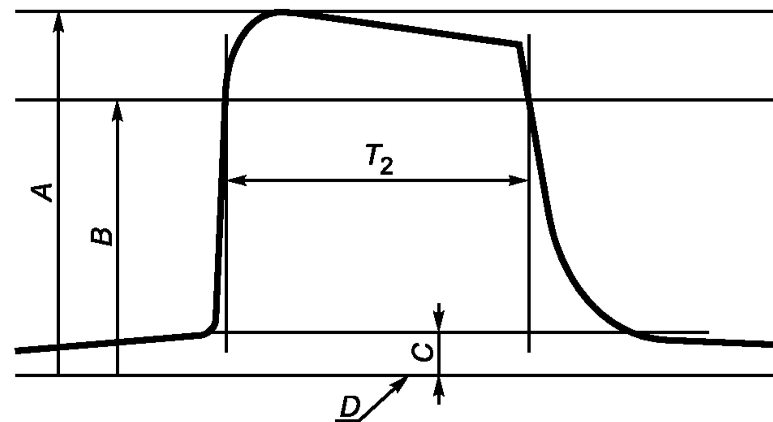
$A$  — разница потенциалов между максимальной амплитудой импульса и нулевым уровнем  $D$  напряжения холостого хода;
