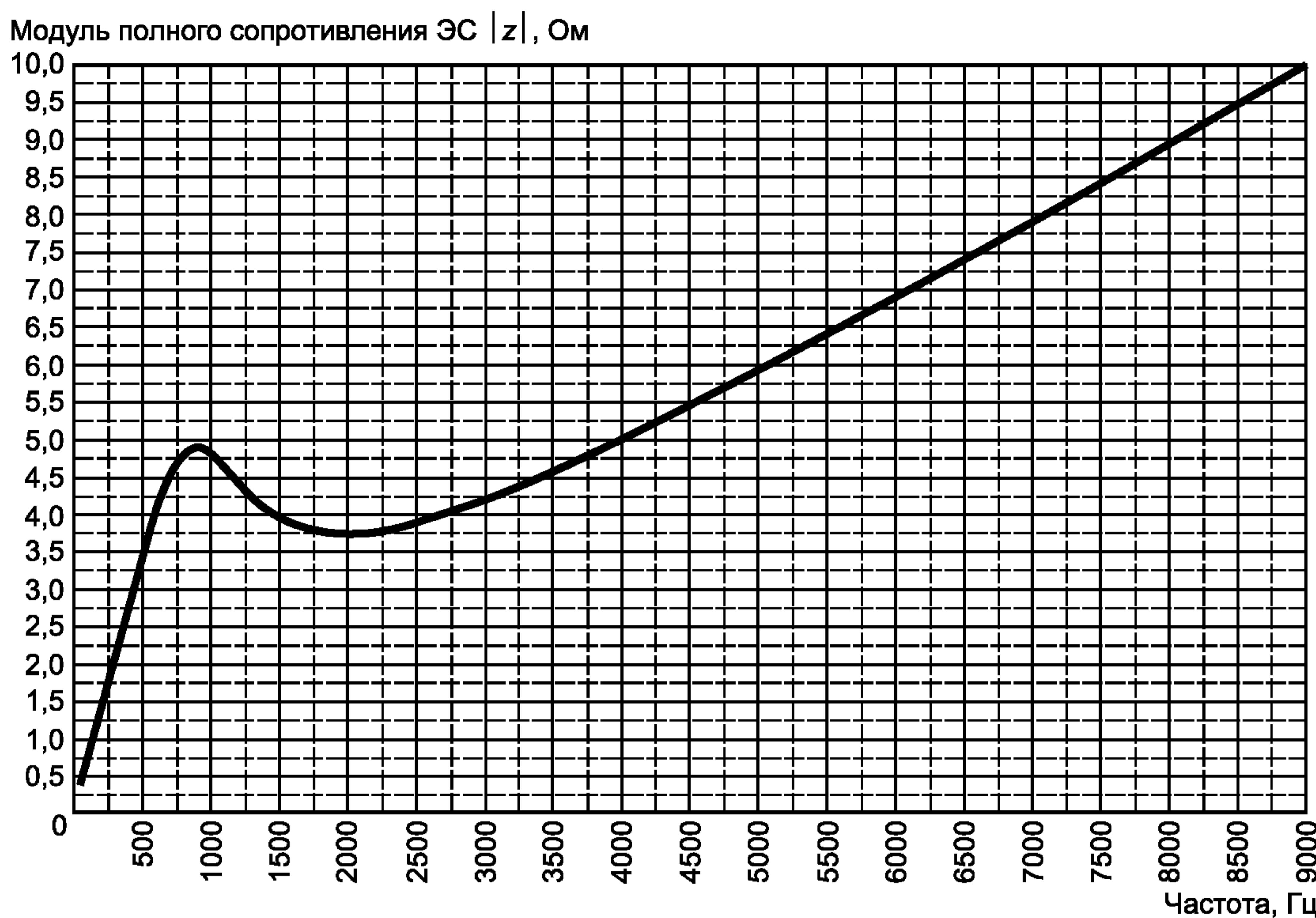
Рисунок В.5 — Модуль полного сопротивления эквивалента сети
