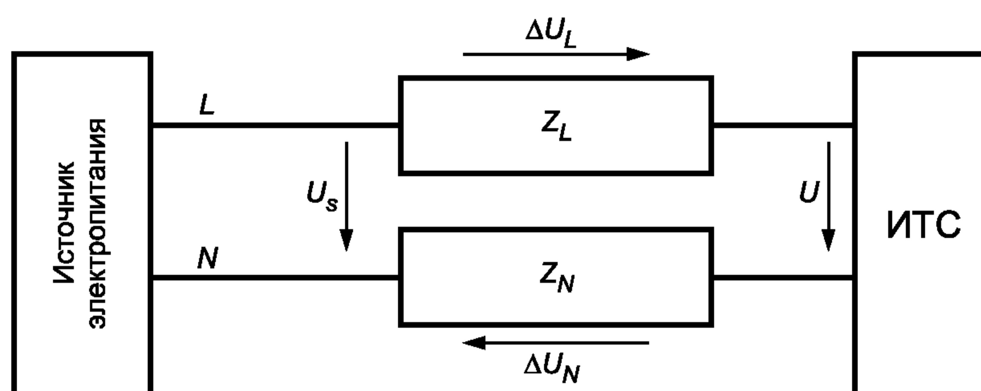
$U_s$  — напряжение «фаза — нейтраль» источника электропитания;  $U$  — напряжение на зажимах ИТС;  $Z_L, Z_N$  — полные сопротивления проводов и входной цепи измерения тока;  $\Delta U$  — падение напряжения на сопротивлениях  $Z_L, Z_N$  ( $\Delta U = \Delta U_L + \Delta U_N$ );
