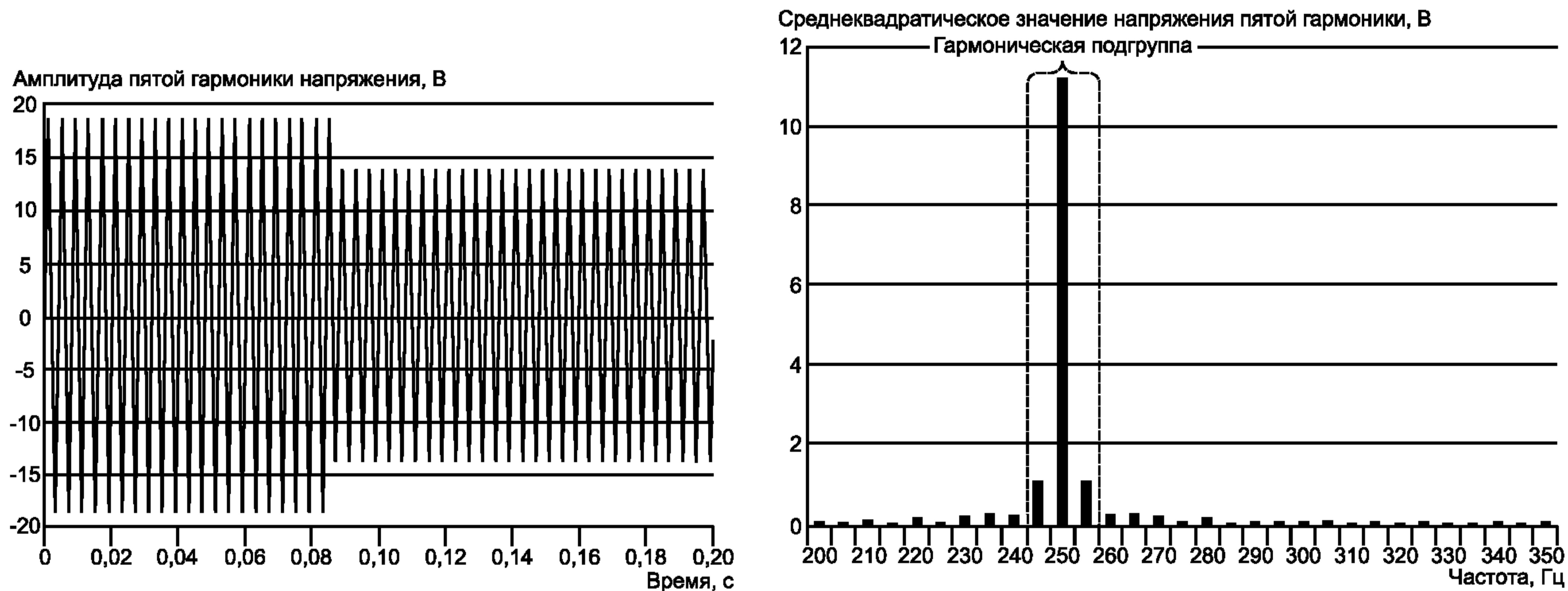
Рисунок С.2 — Колебания напряжения пятой гармоники
