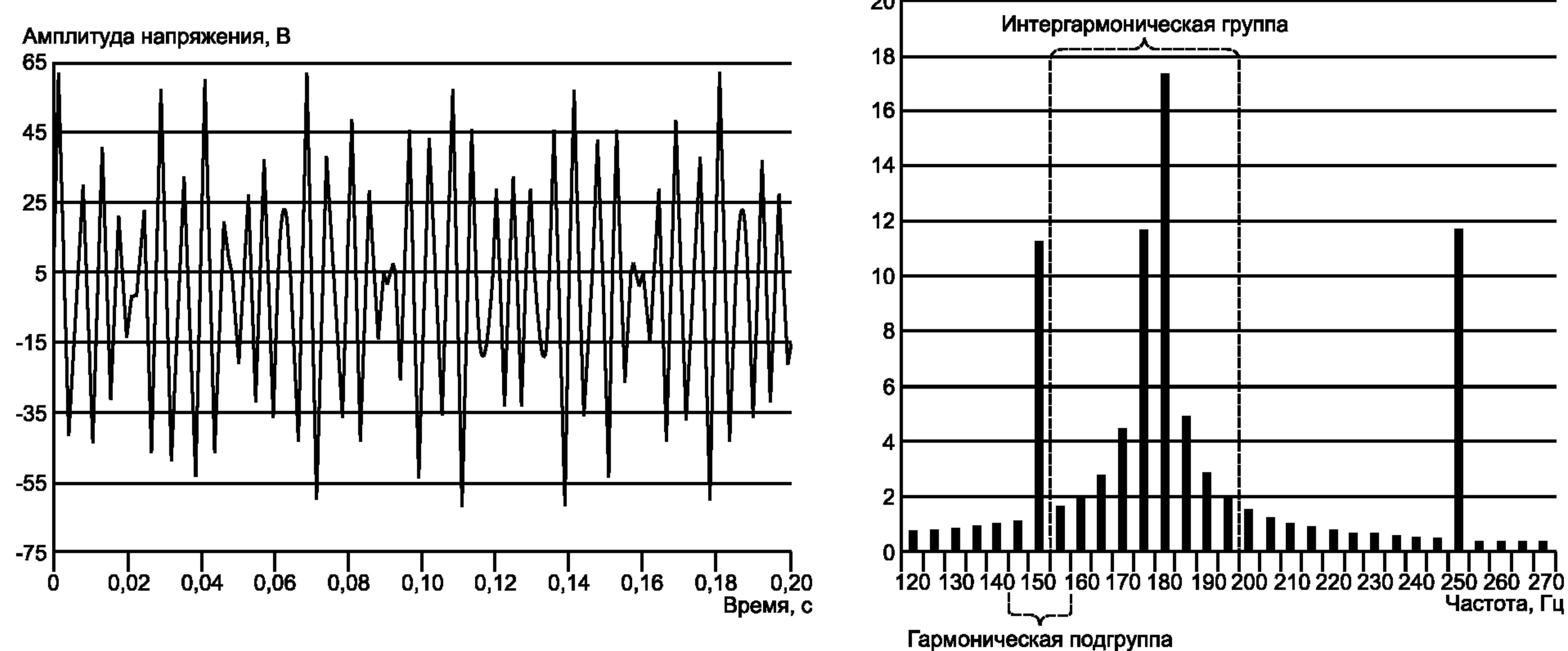
Рисунок С.4 — Передаваемый сигнал на частоте 178 Гц совместно с третьей и пятой гармониками
