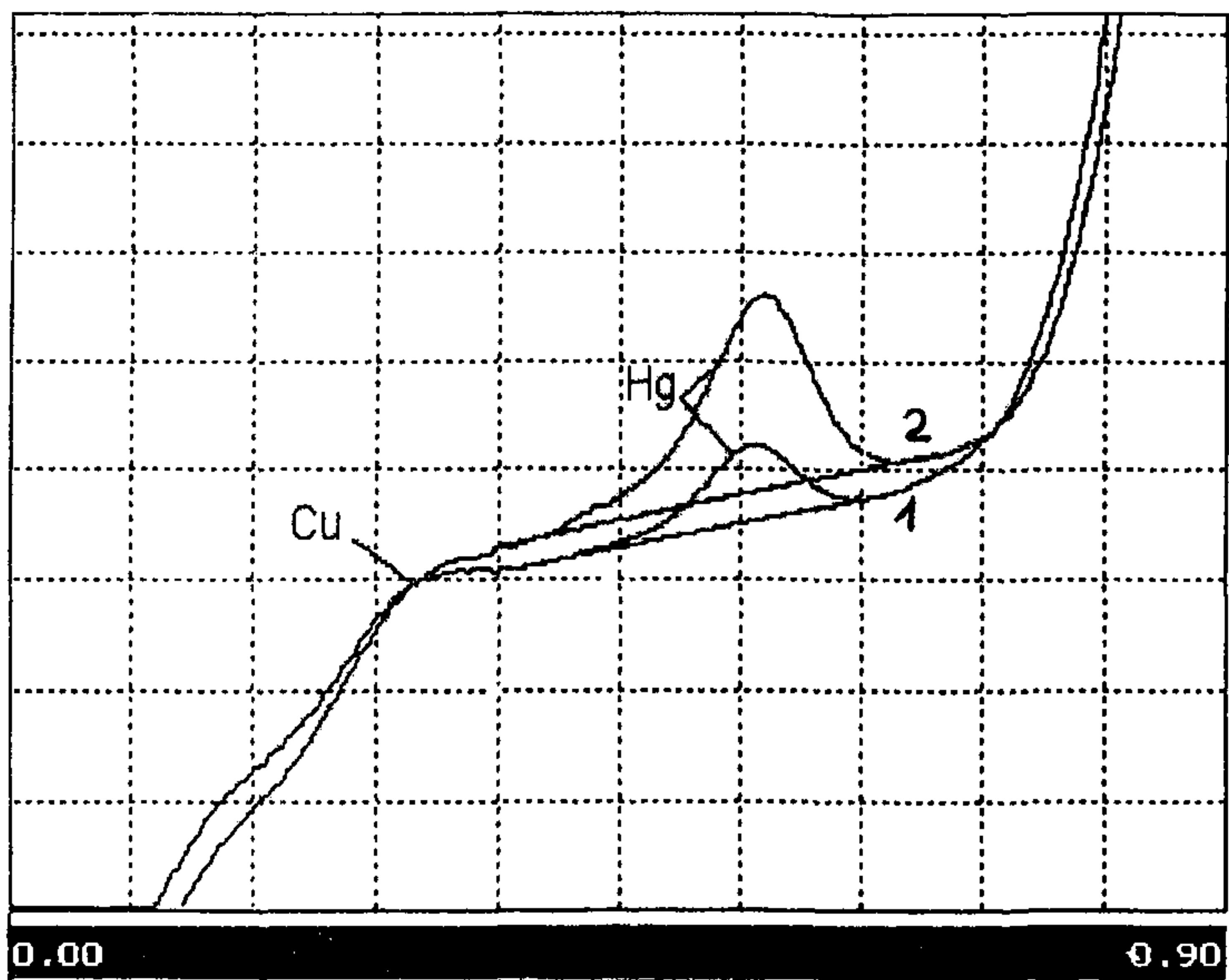
Рисунок 5. Вольтамперограмма ртути в пробе (1) и в пробе с добавкой стандартных растворов (2)
