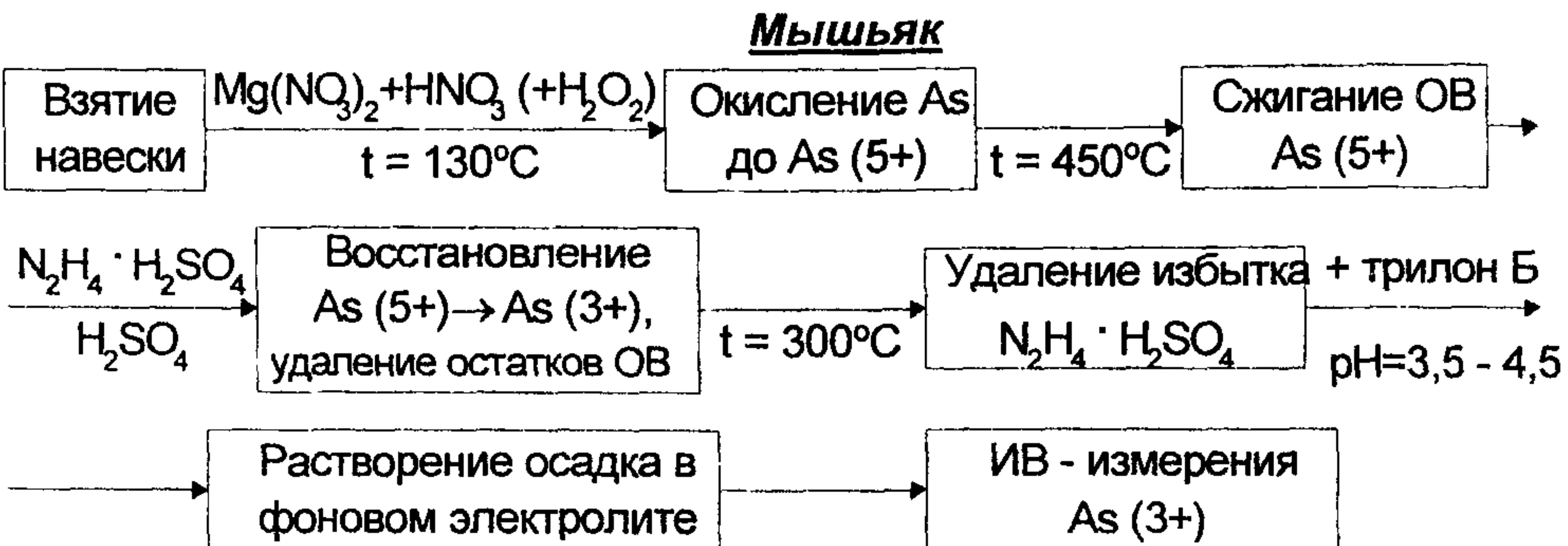
*Рисунок 2. Основные этапы пробоподготовки при анализе проб овощей, фруктов и продуктов их переработки на содержание мышьяка*
