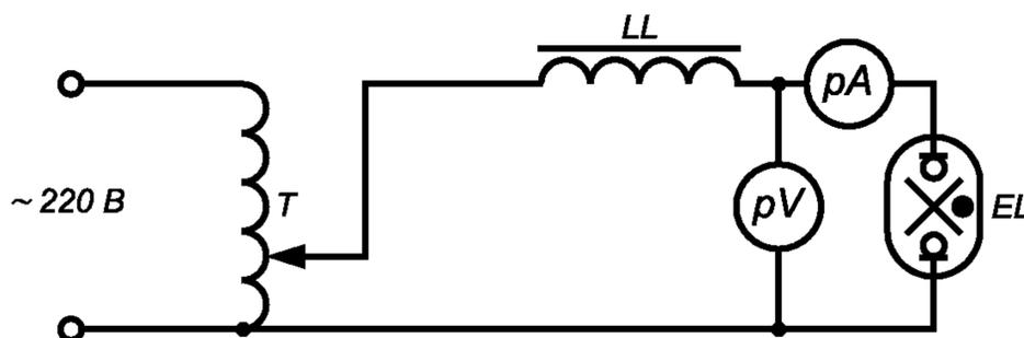
*EL* — лампа; *pV* — вольтметр 0 — 300 В, класс 0,5; *pA* — амперметр до 10 А, класс 0,5;
