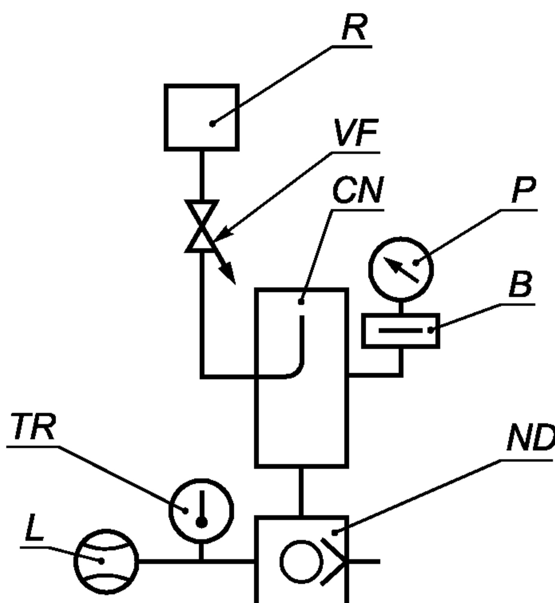
*CN* — измерительная камера; *ND* — испытуемый насос; *P* — вакуумметр; *B* — охлаждаемая ловушка; *VF* — клапан-натекатель; *R* — устройство для измерения потока; *L* — измеритель расхода воды; *TR* — датчик измерения температуры
