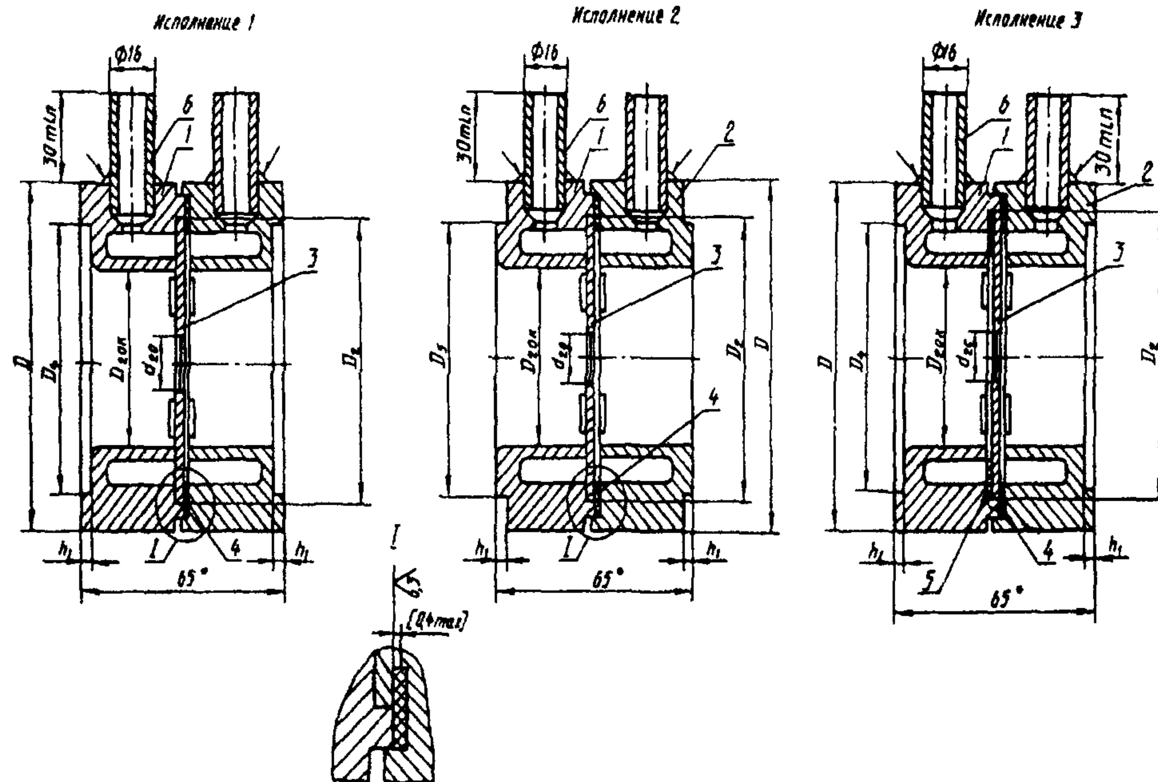
1 - корпус плюсовой камеры, 2 - корпус минусовой камеры, 3 - диафрагма, 4 и 5 - прокладка, 6 - патрубок
