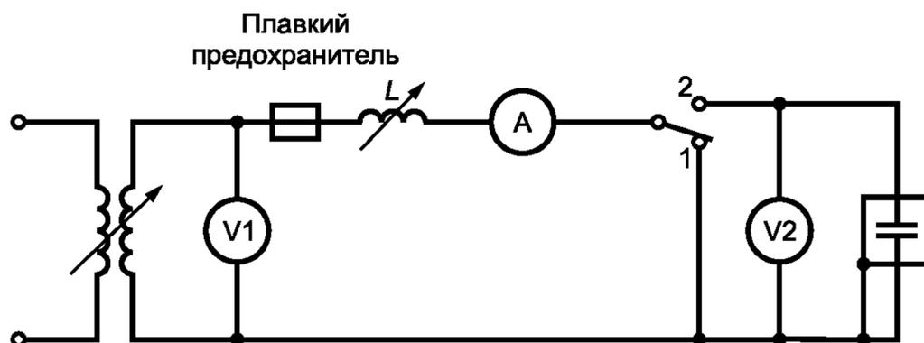
Рисунок 2 — Испытательная установка для разрушающего испытания переменным напряжением
