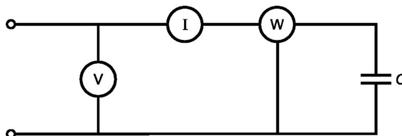
$V$  — вольтметр;  $I$  — амперметр;  $W$  — ваттметр для работы точно при  $\cos \varphi = 0,1$ ;  $C$  — испытуемый конденсатор
