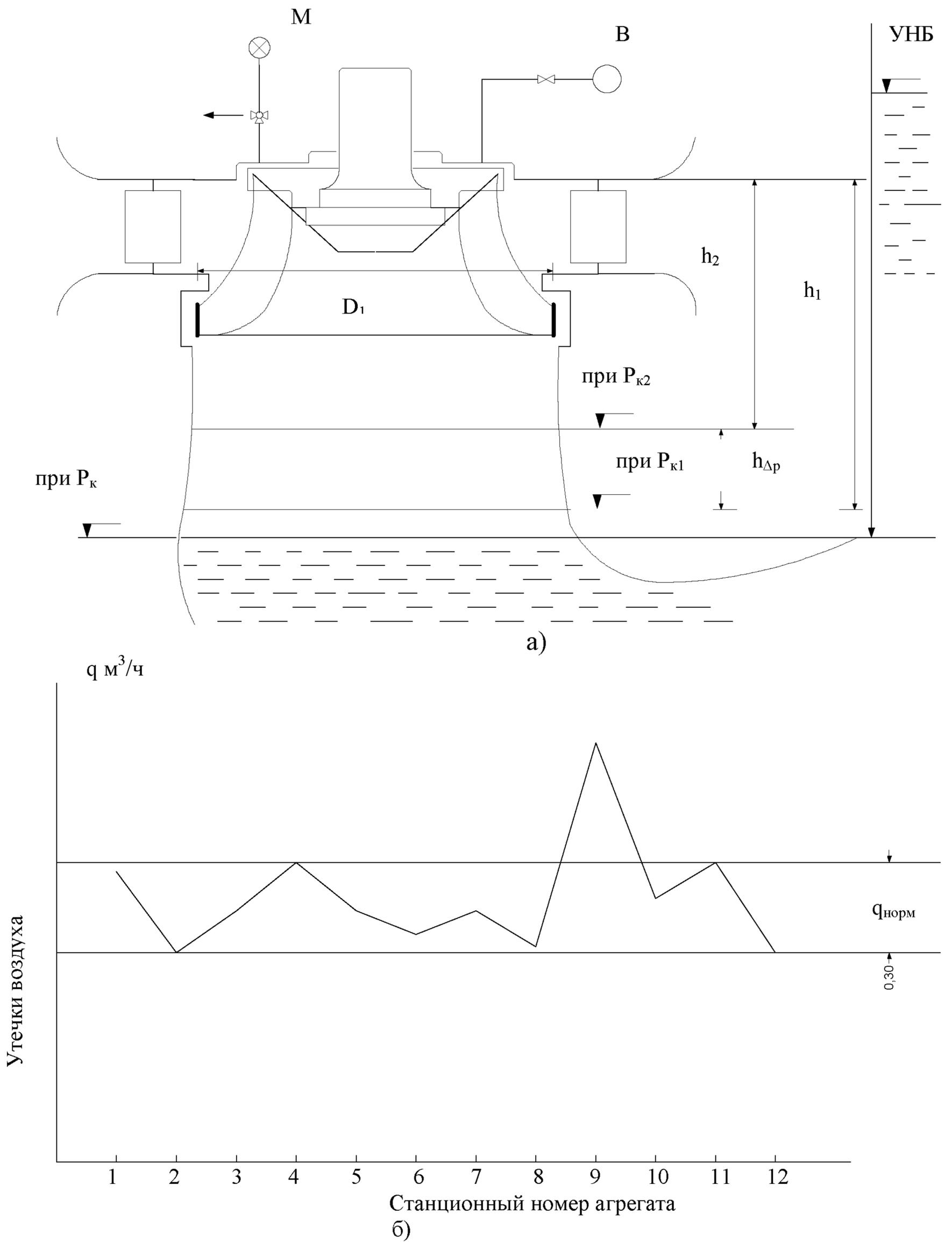
Рисунок В.4. Контроль утечки воздуха из камеры рабочего колеса турбины при работе в режиме СК:
