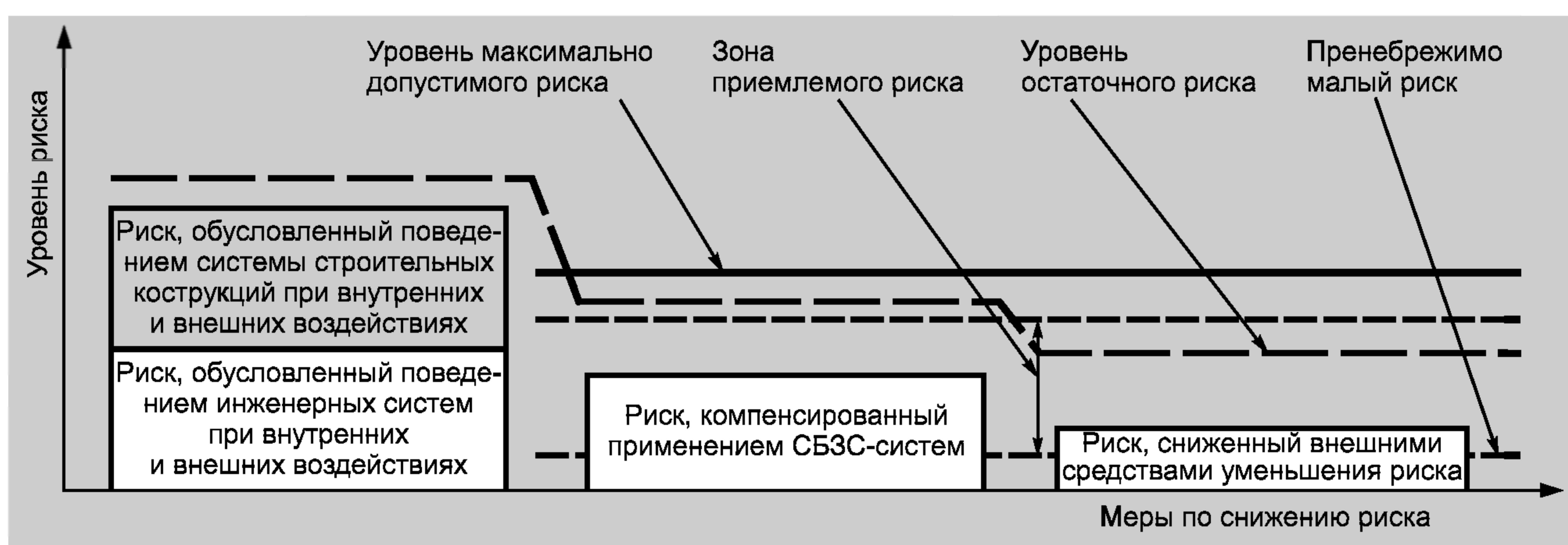
Рисунок 1 — Снижение риска до уровня приемлемого риска
