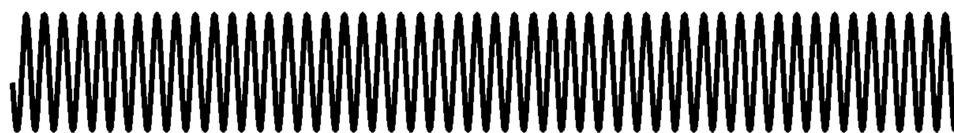
Сетевая ПОМЕХА с частотой 50 Гц и амплитудой 25 мкВ
