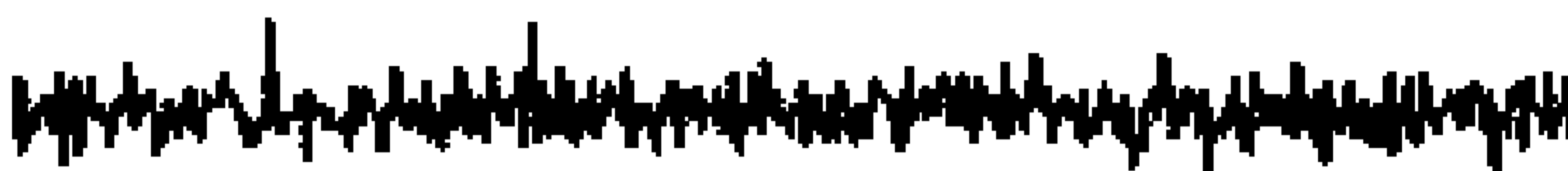
Высокочастотный ШУМ со среднеквадратическим значением напряжения 25 мкВ
