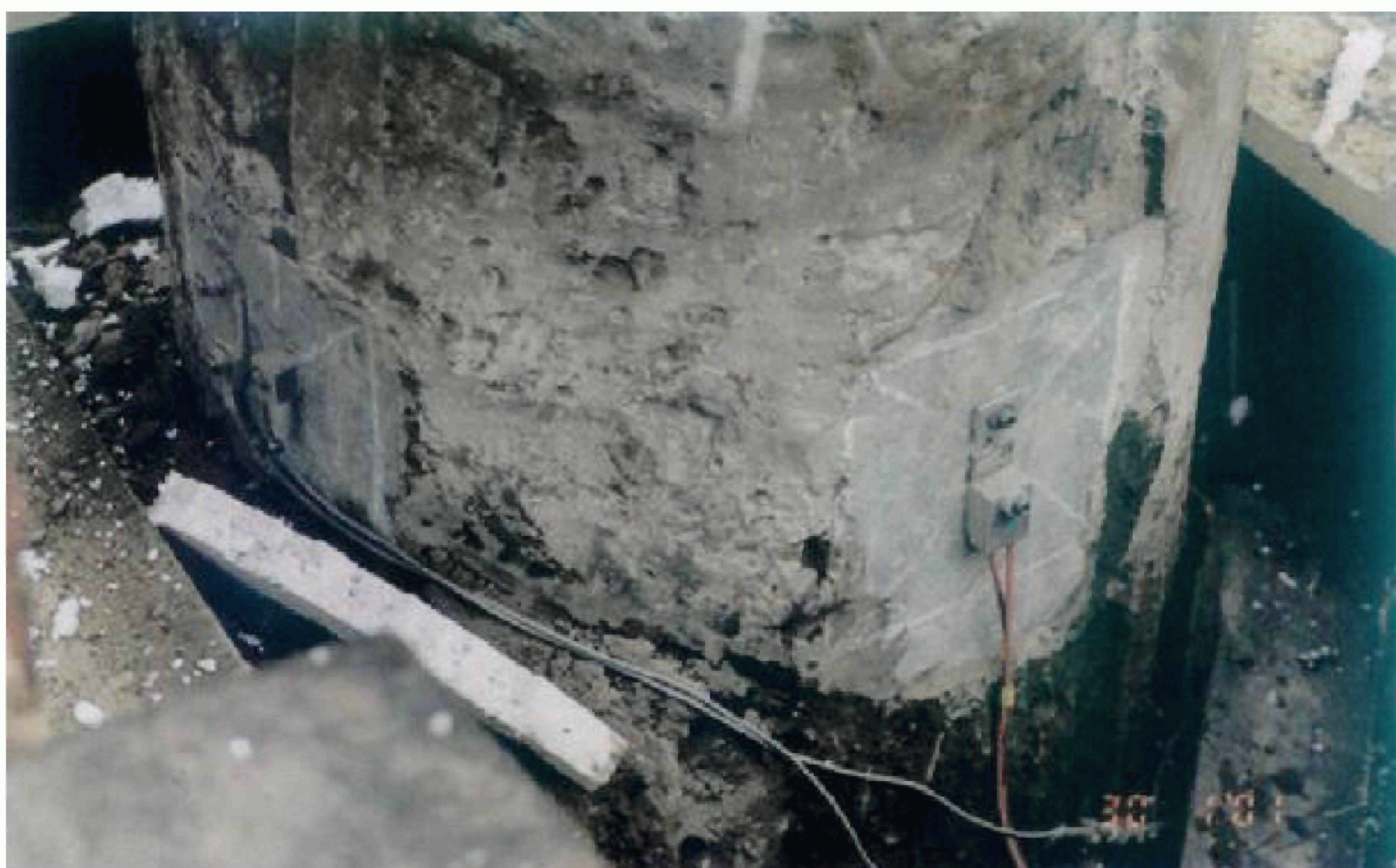
Рис.5. Нагружающее устройство и измерительные приборы для динамических испытаний по методу ЭЛДИ
