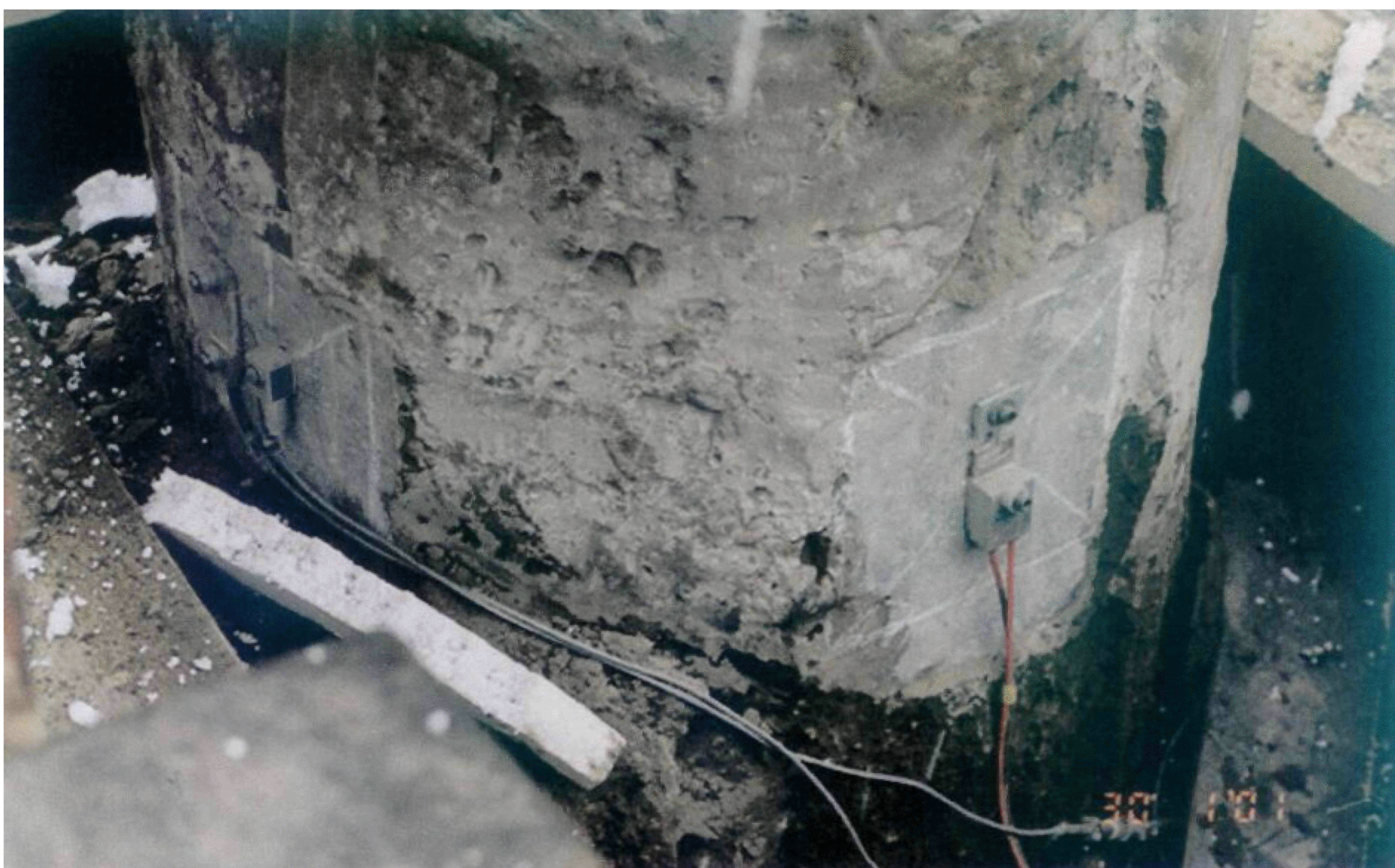
Рис. 2. Нагружающее устройство и измерительные приборы для испытания свай в методе ЭЛДИ
