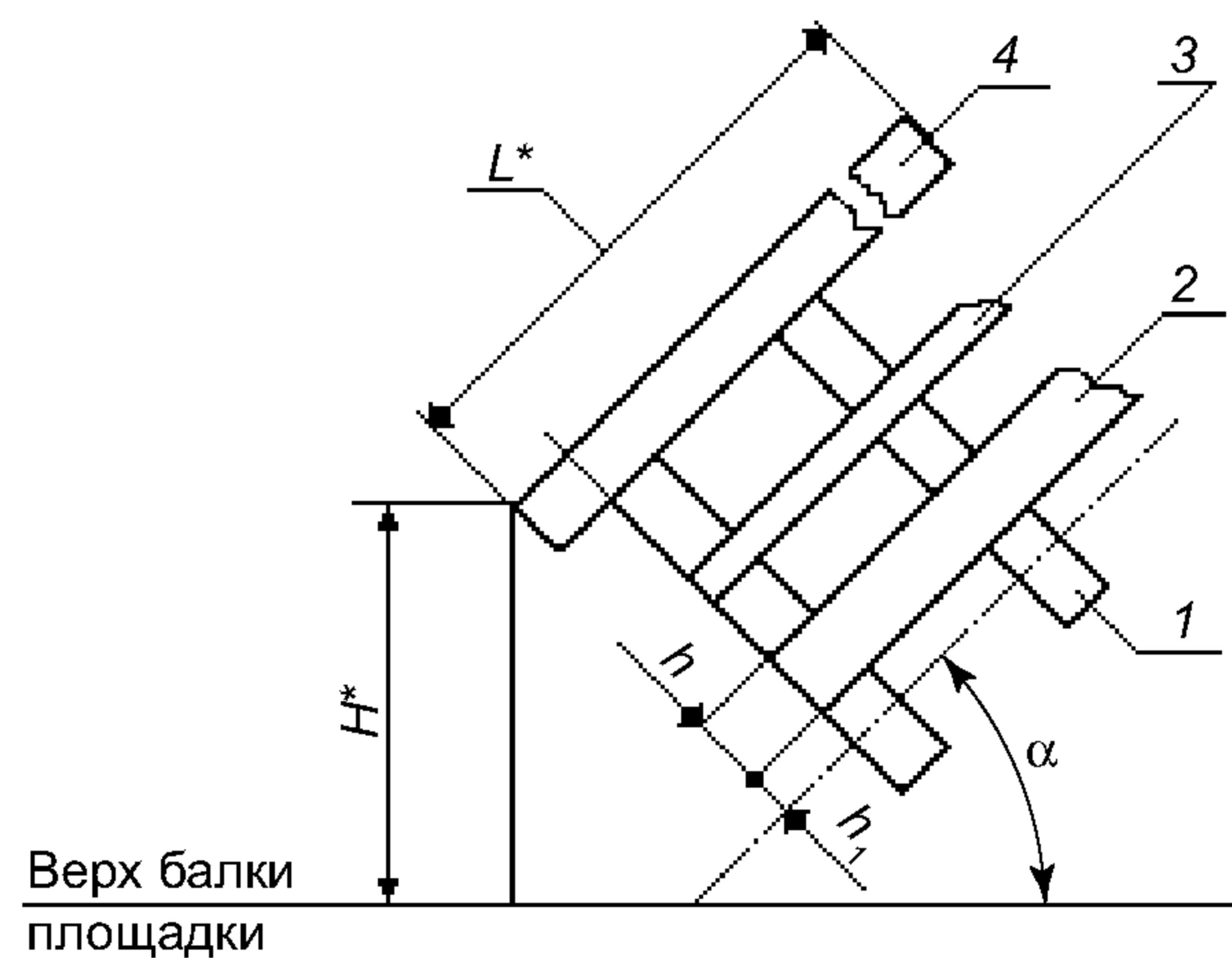
1 — стойка; 2 — бортовой элемент; 3 — средний ограждающий элемент; 4 — поручень
