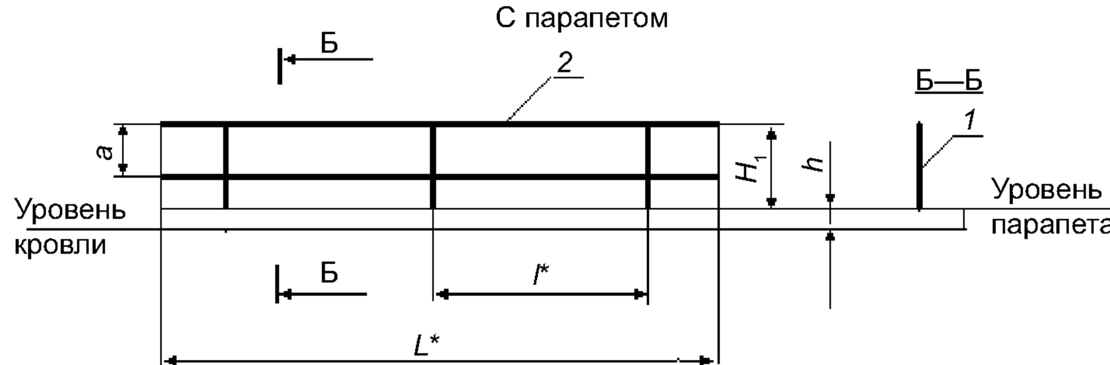
1 — вертикальный ограждающий элемент; 2 — горизонтальный ограждающий элемент
