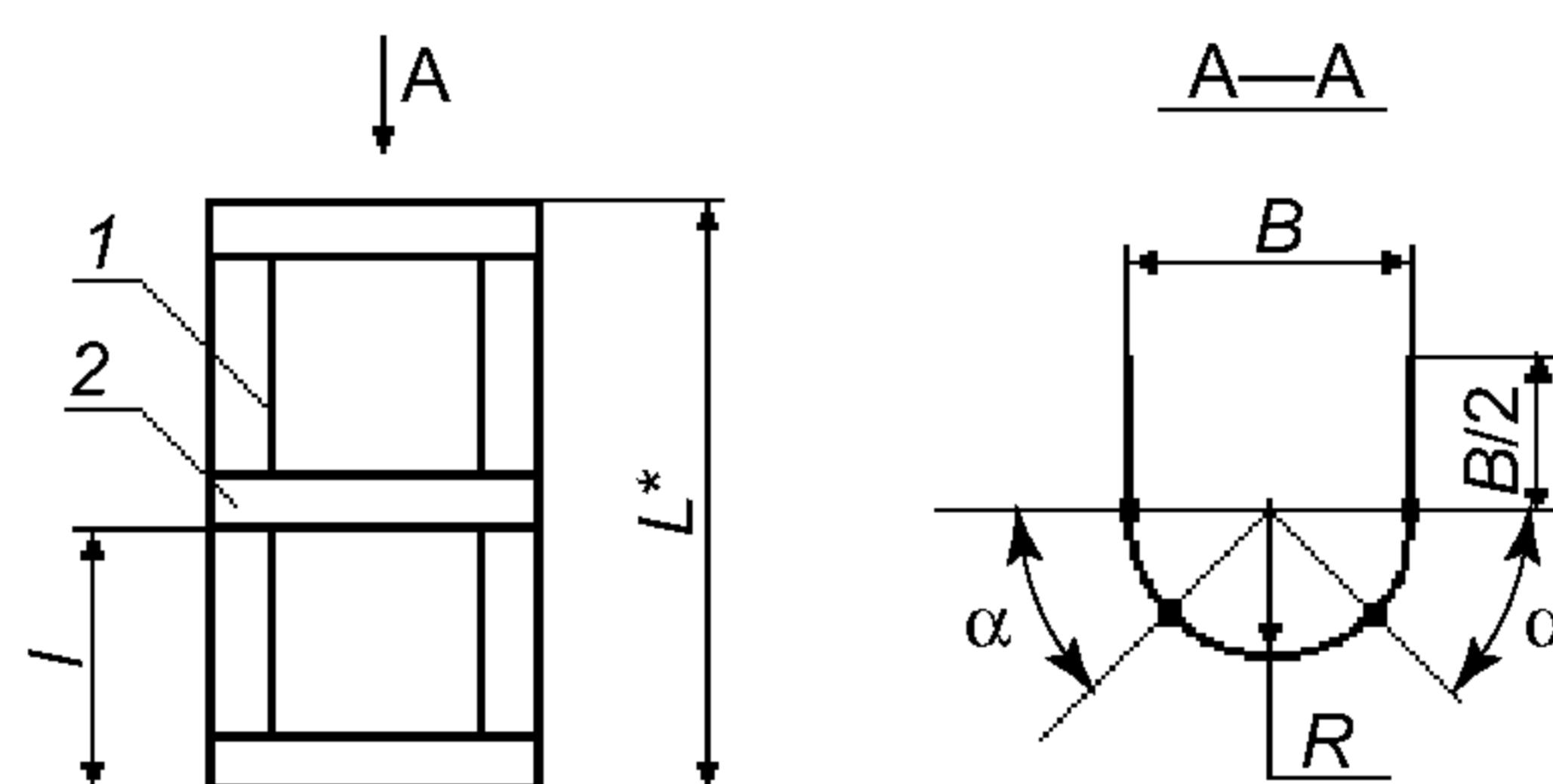
1 — вертикальный ограждающий элемент; 2 — горизонтальный ограждающий элемент
