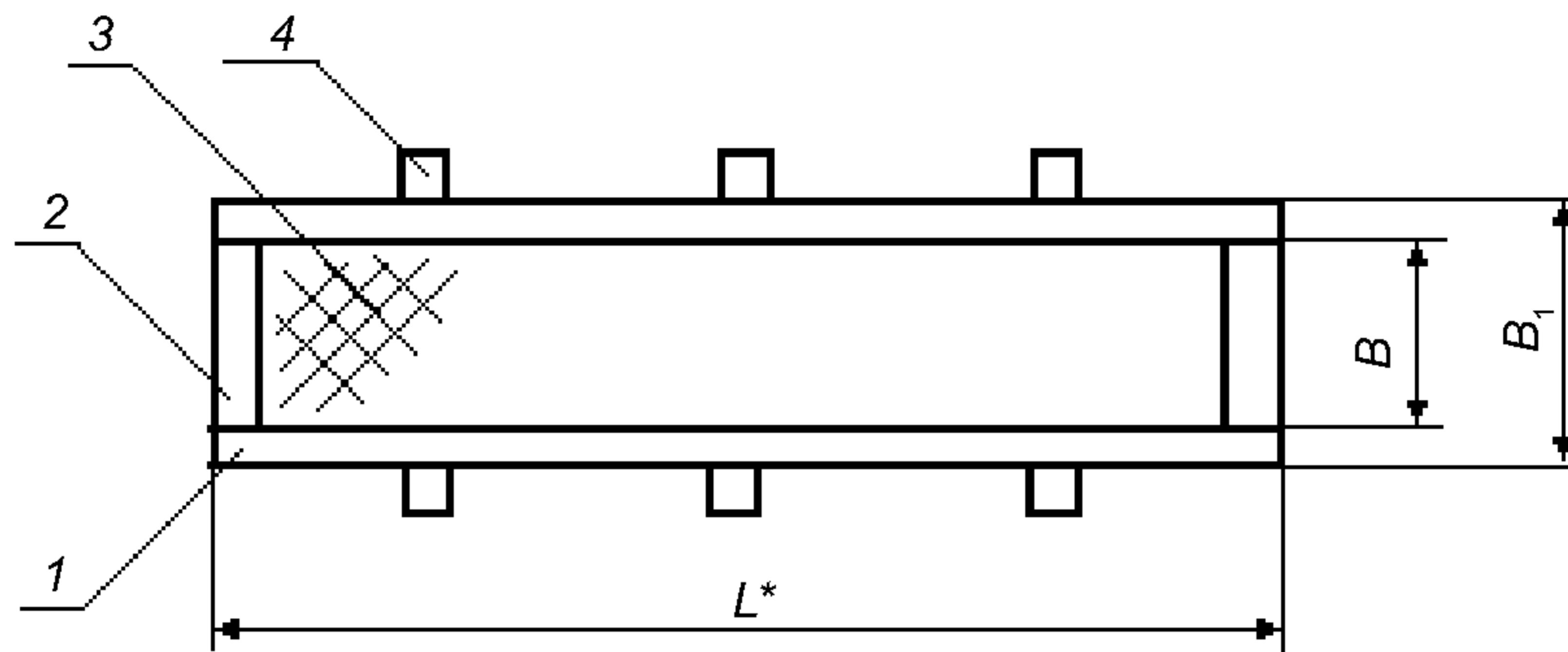
1 — балка; 2 — окантовочный элемент; 3 — настил; 4 — ребро
