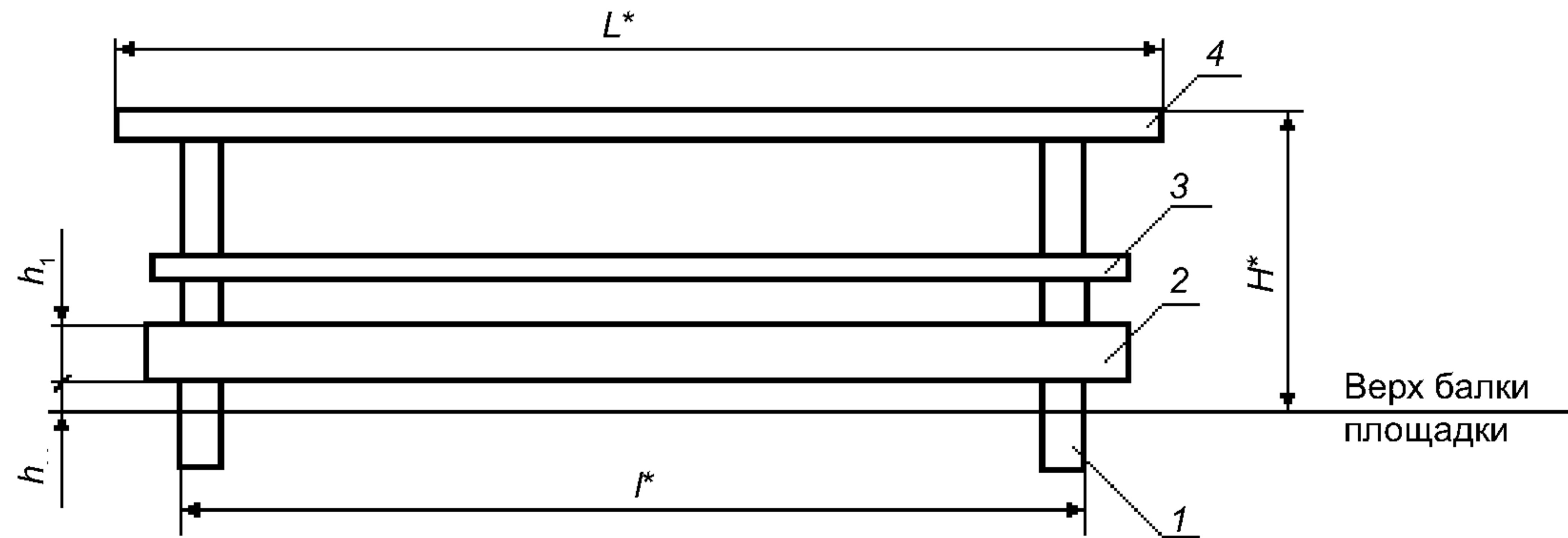
1 — стойка; 2 — бортовой элемент; 3 — средний ограждающий элемент; 4 — поручень
