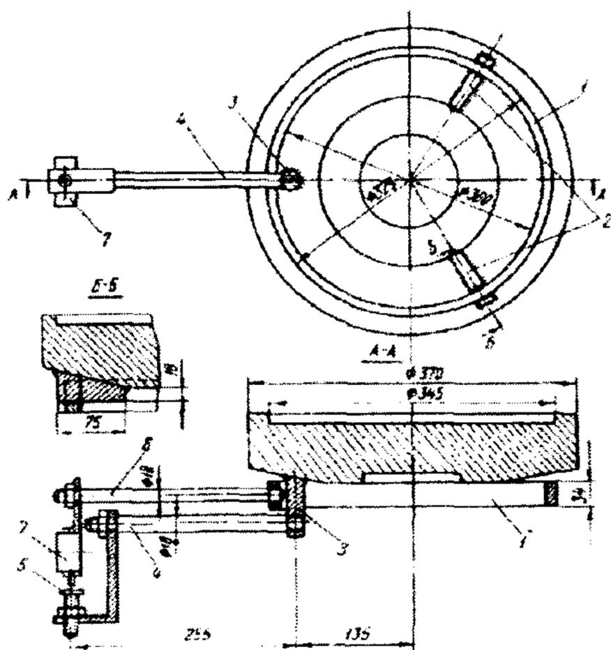
Рис. Д.2 Рычажно-индикаторное устройство для определения нагрузки на сегмент подпятника по прогибу опорной тарелки: 1 - кольцо; 2 - рёбра-приварыши; 3 - стержень; 4 - нижний рычаг с уголком; 5 - винт с опорной поверхностью; 6 - верхний рычаг; 7 - индикатор
