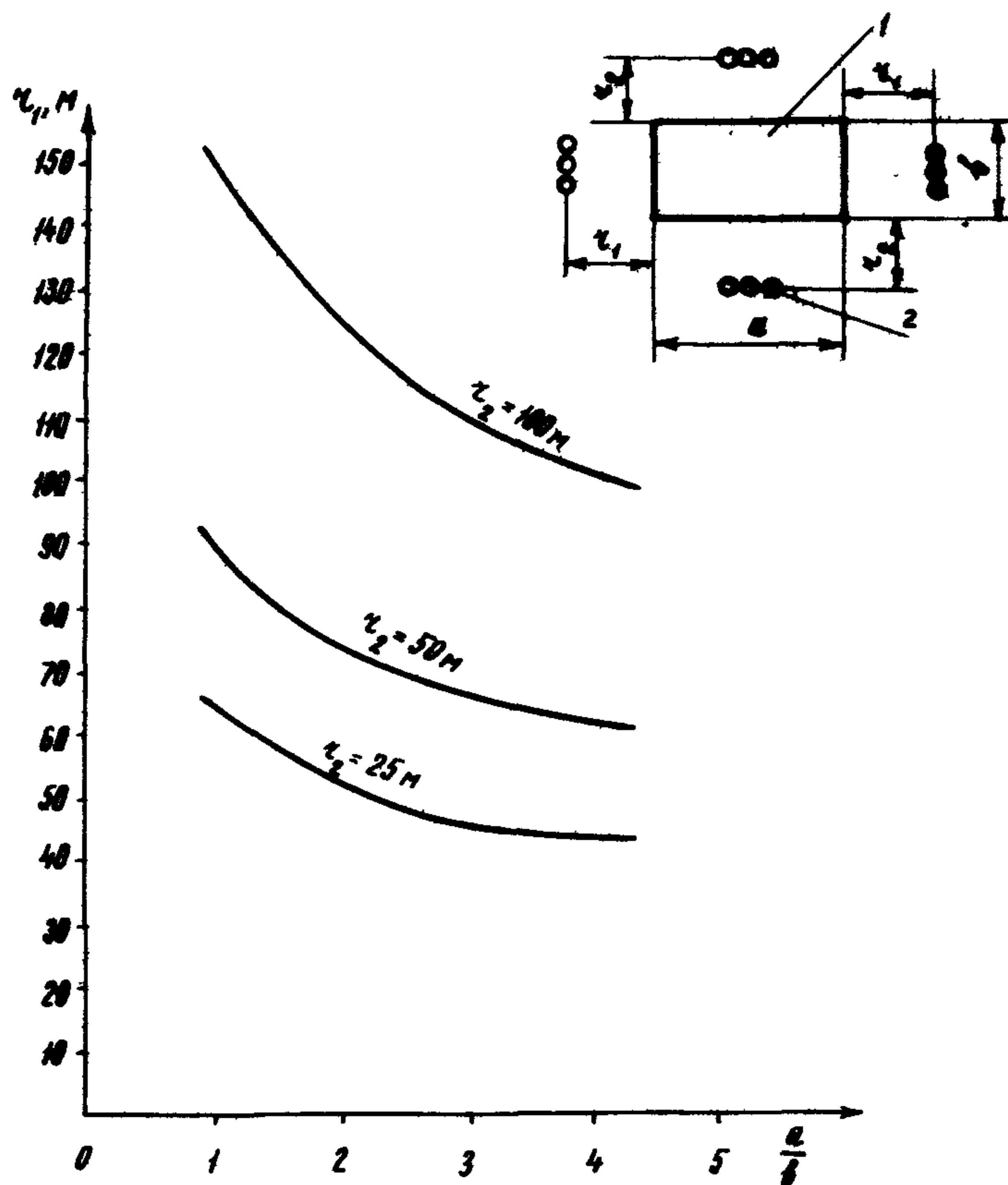
Рис.5. Зависимость величины относа сосредоточенных анодных заземлений от соотношения сторон площадки:
