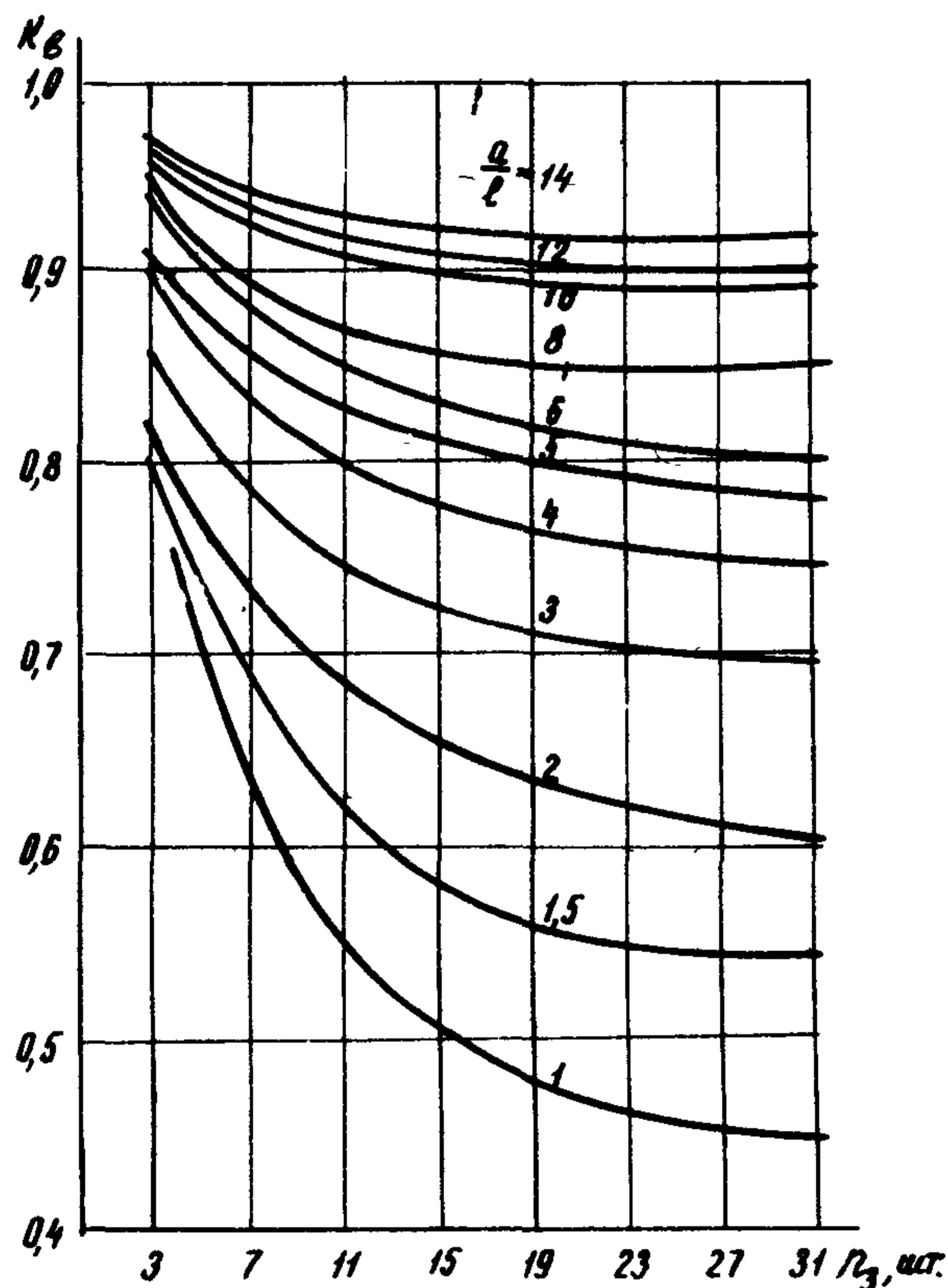
Рис.8. Зависимость коэффициента экранирования горизонтальных заземлителей в коксовом активаторе  $K_B$  от числа электродов  $n_3$  при различных отношениях  $\frac{a}{l}$ :
