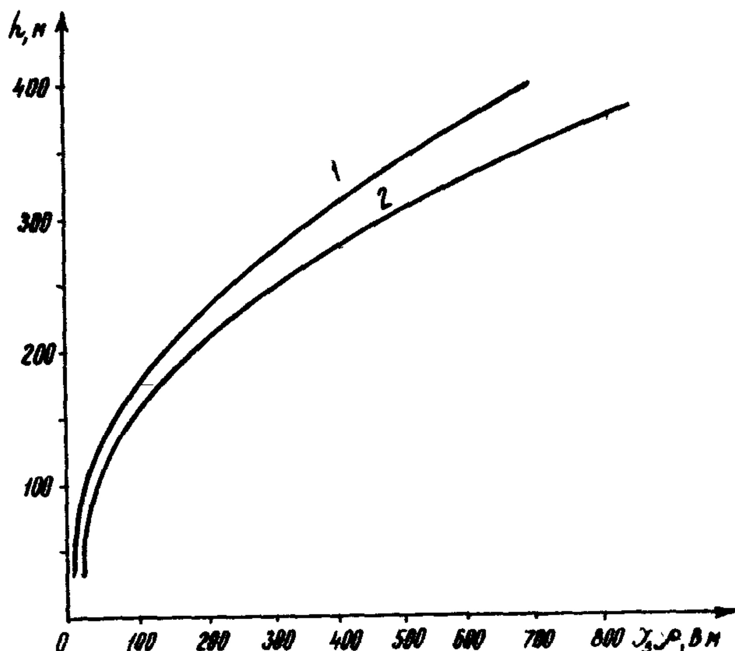
Рис.10. Зависимость глубины заложения анодного заземления  $h$  от напряженности поля у анодного заземления  $J_3, \Omega$  для площадки 250 x 180 м:
