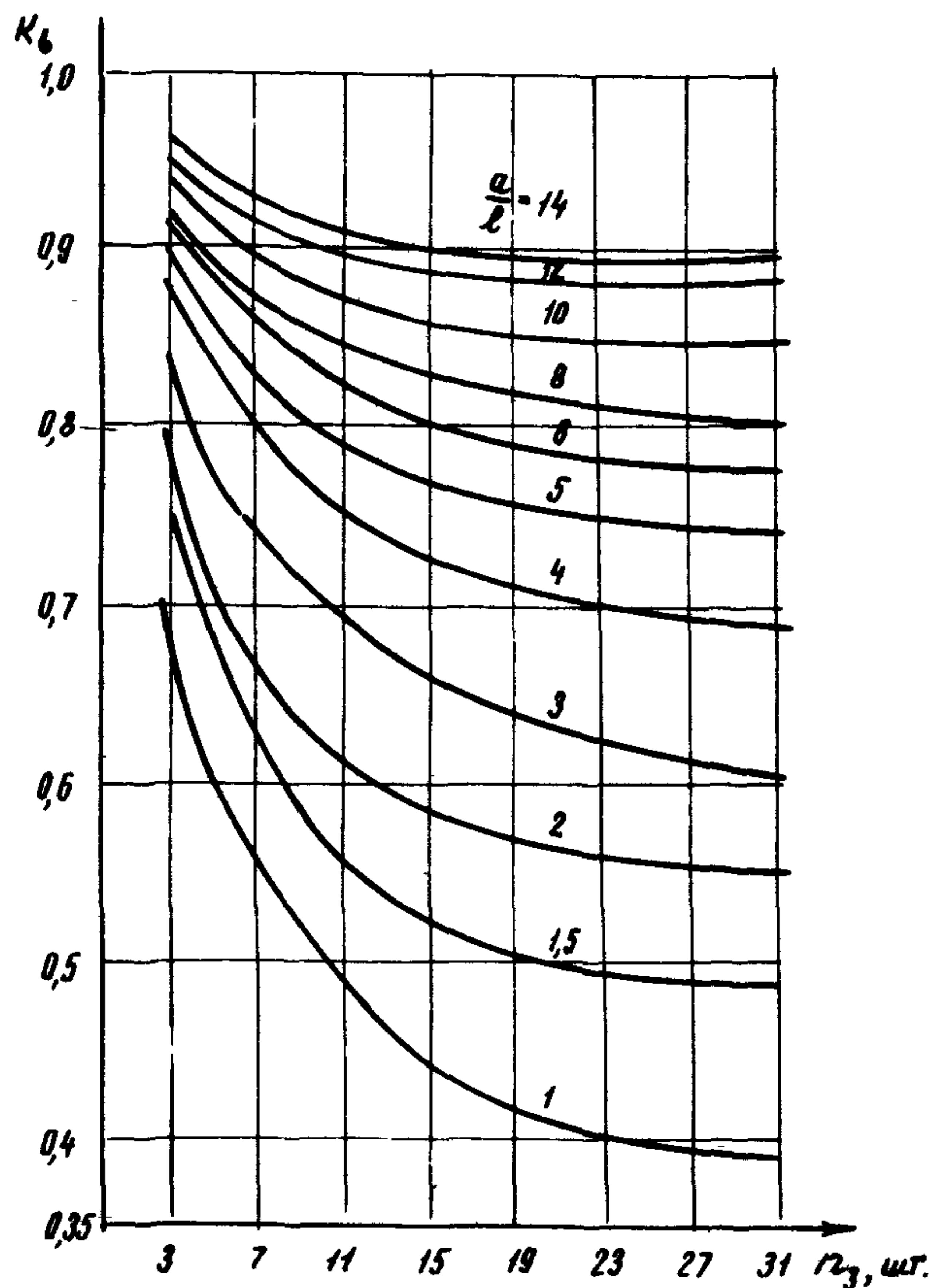
Рис.6. Зависимость коэффициента экранирования вертикальных заземлителей в коксовом активаторе  $K_d$  от числа электродов  $N_3$  при различных отношениях  $\frac{a}{e}$ :
