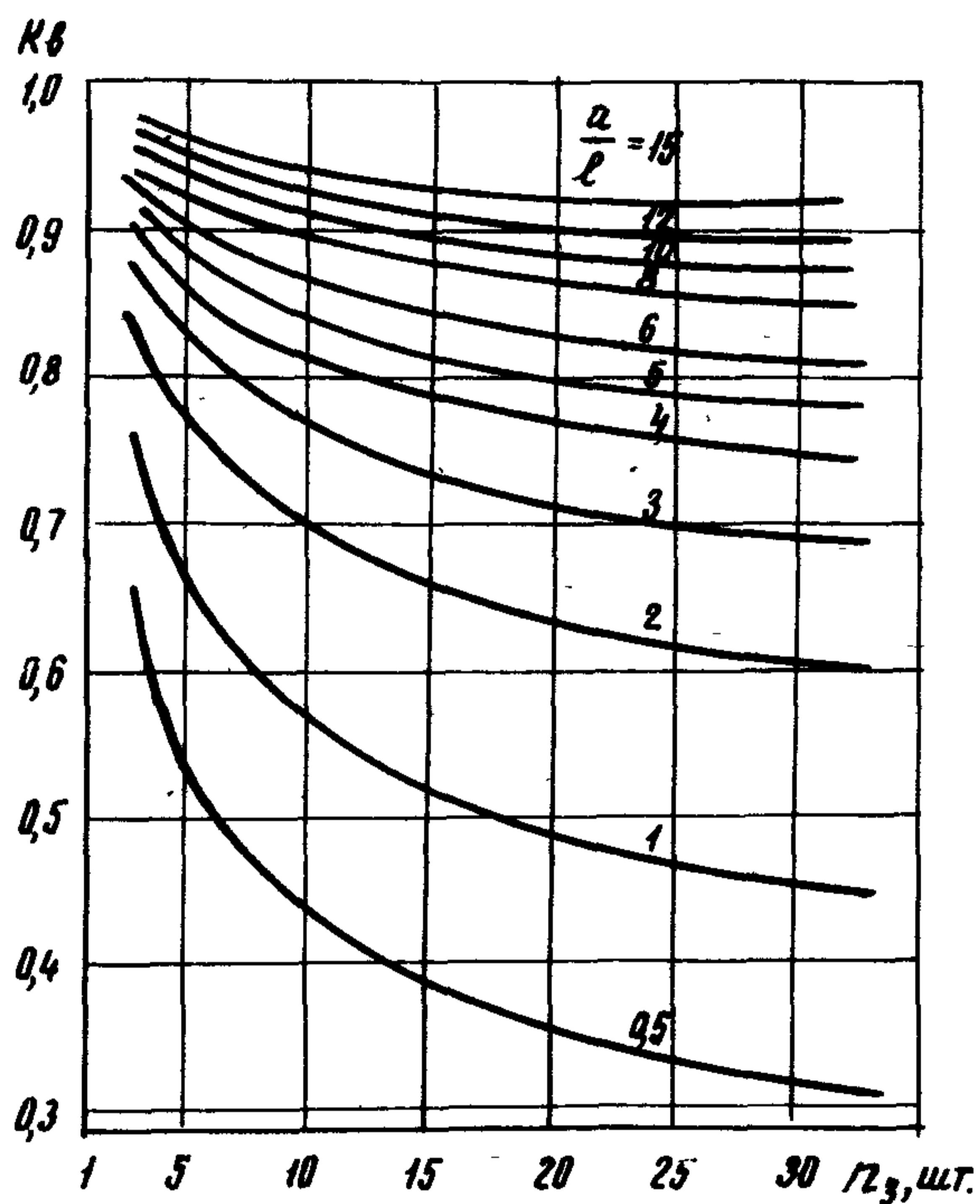
Рис.7. Зависимость коэффициента экранирования вертикальных заземлителей  $K_B$  от числа электродов  $N_3$  при различных отношениях  $\frac{a}{l}$ :
