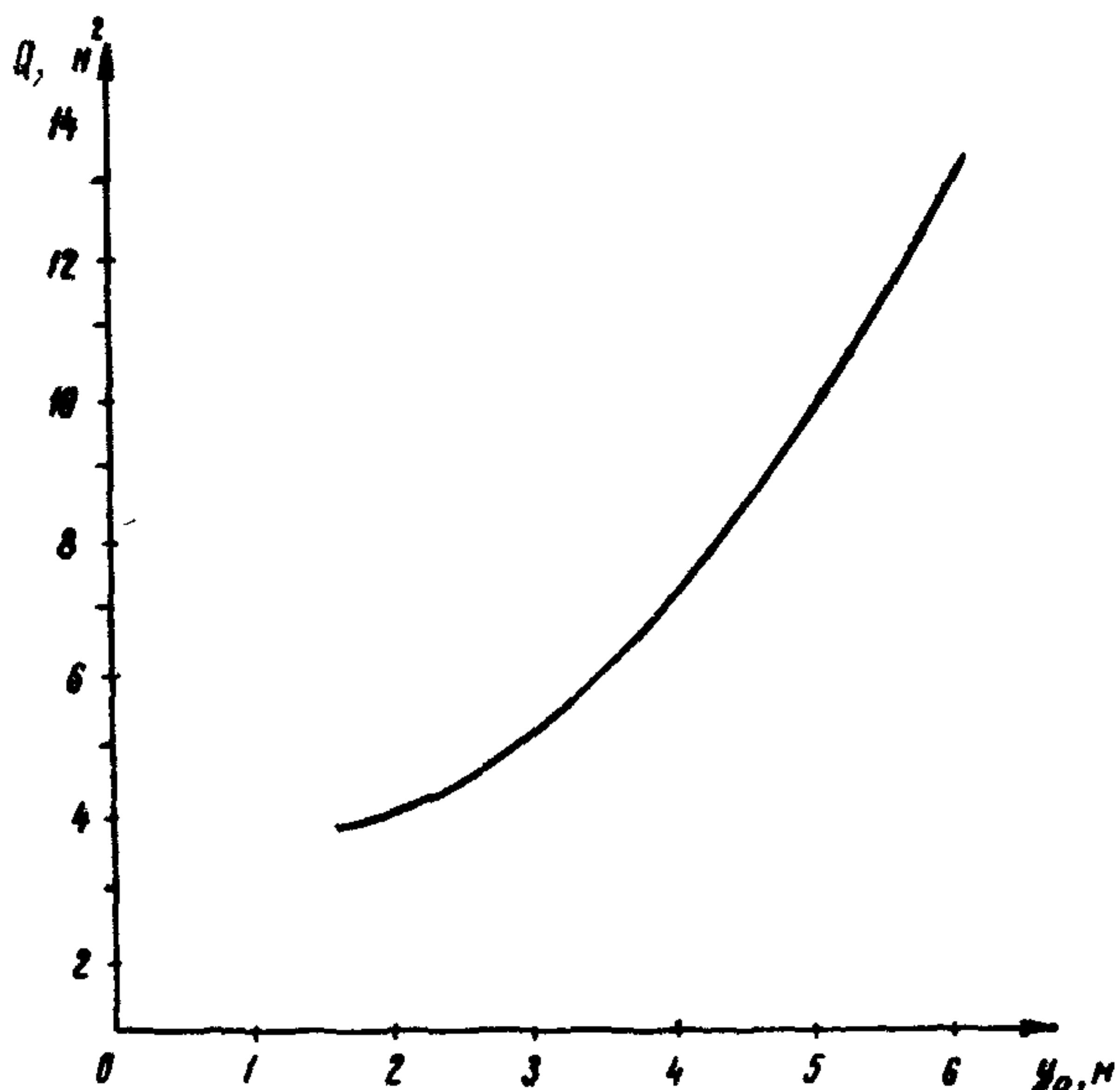
Рис. II. Зависимость коэффициента удаления заземления от расстояния до распределенного заземления
