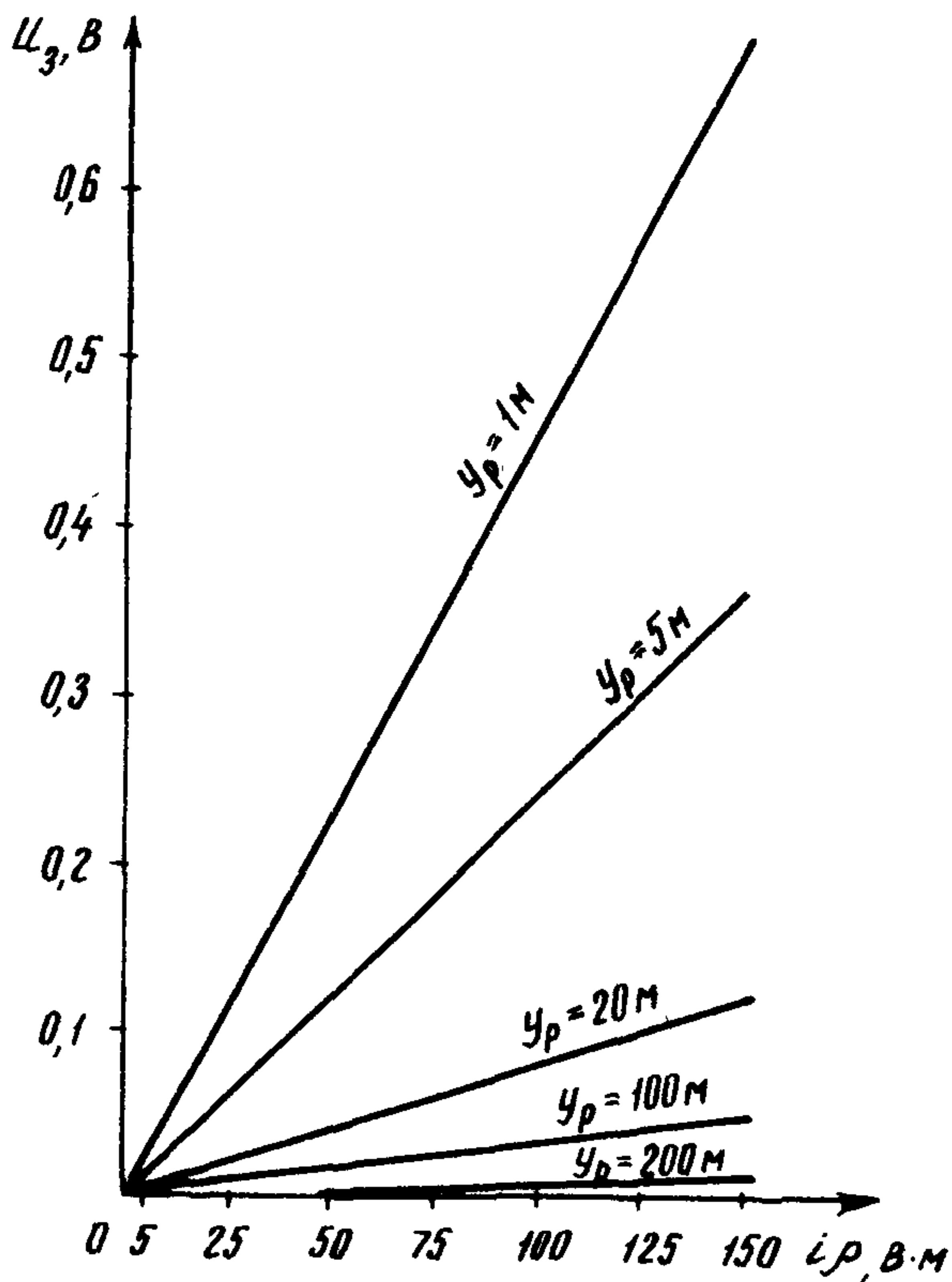
Рис.3. Зависимость потенциала земли  $U_3$  от напряженности поля  $\rho_s$  сооружения длиной 20 м в точке, удаленной от сооружения на расстоянии  $Y_p$
