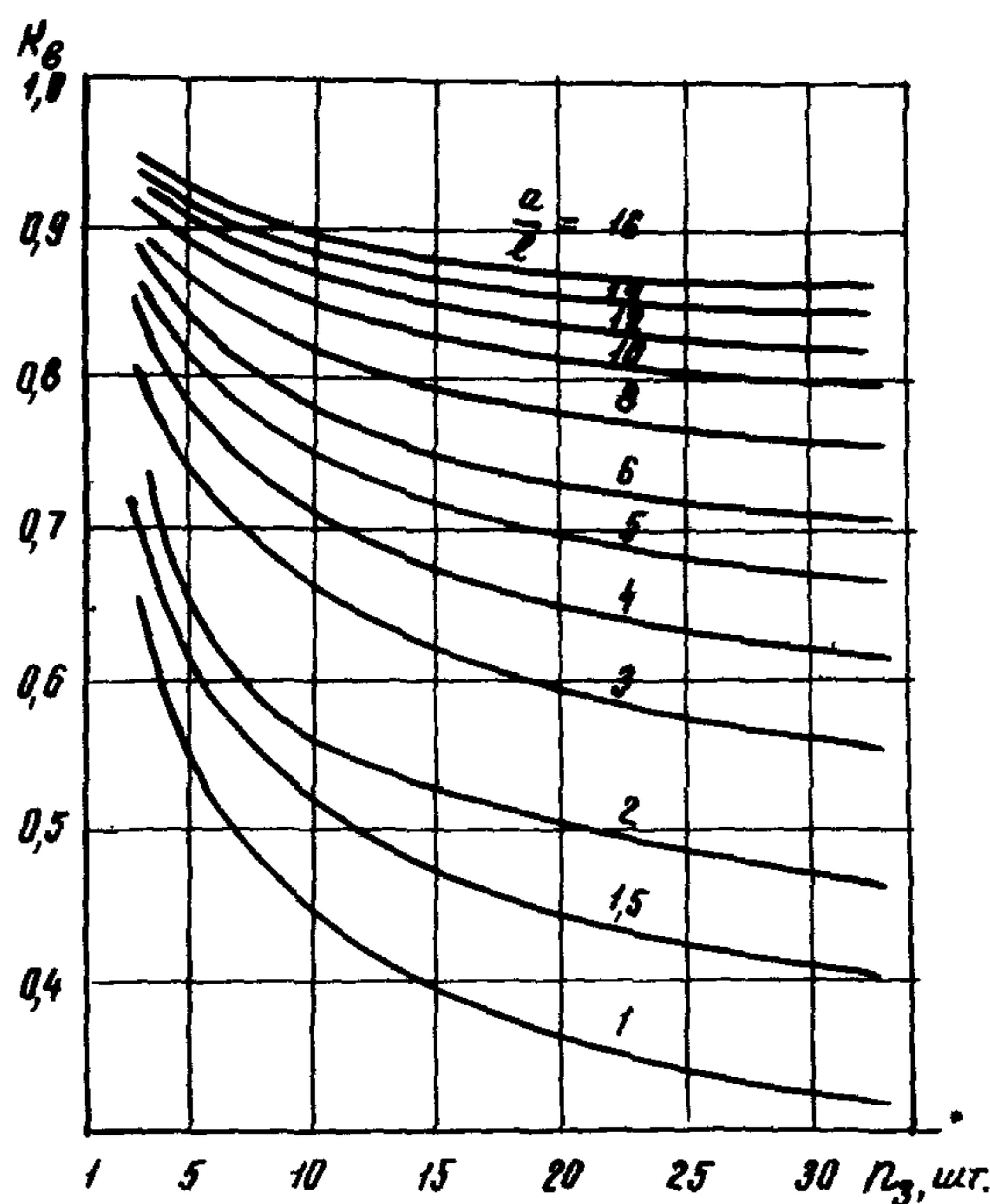
Рис.9. Зависимость коэффициента экранирования горизонтальных заземлителей  $K_B$  от числа  $\frac{a}{l}$ :
