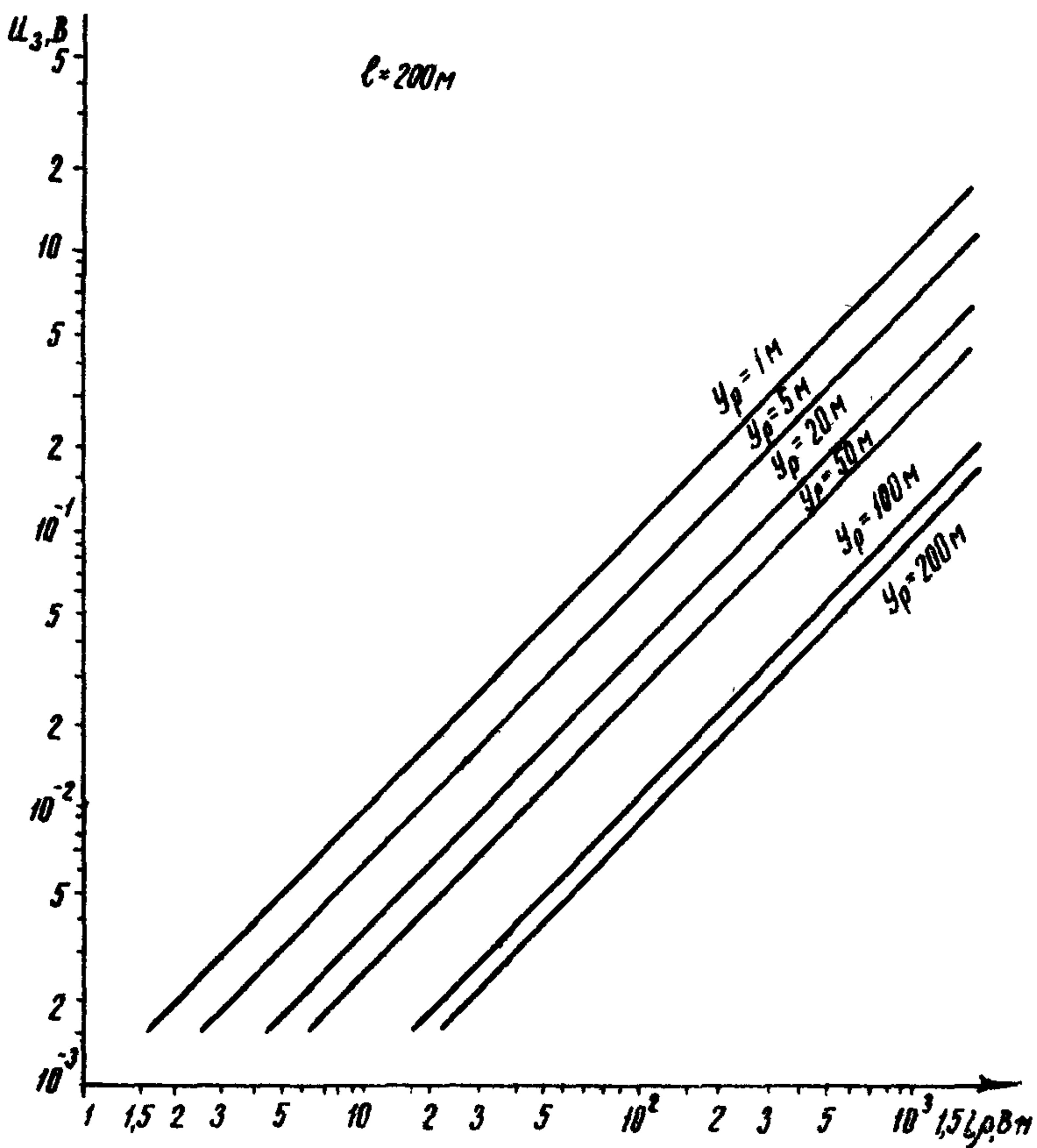
Рис.2. Зависимости потенциала земли  $U_3$  от напряженности поля  $i\rho$  сооружения длиной  $\ell$  в точках, удаленных от сооружения на расстояниях  $y_p$
