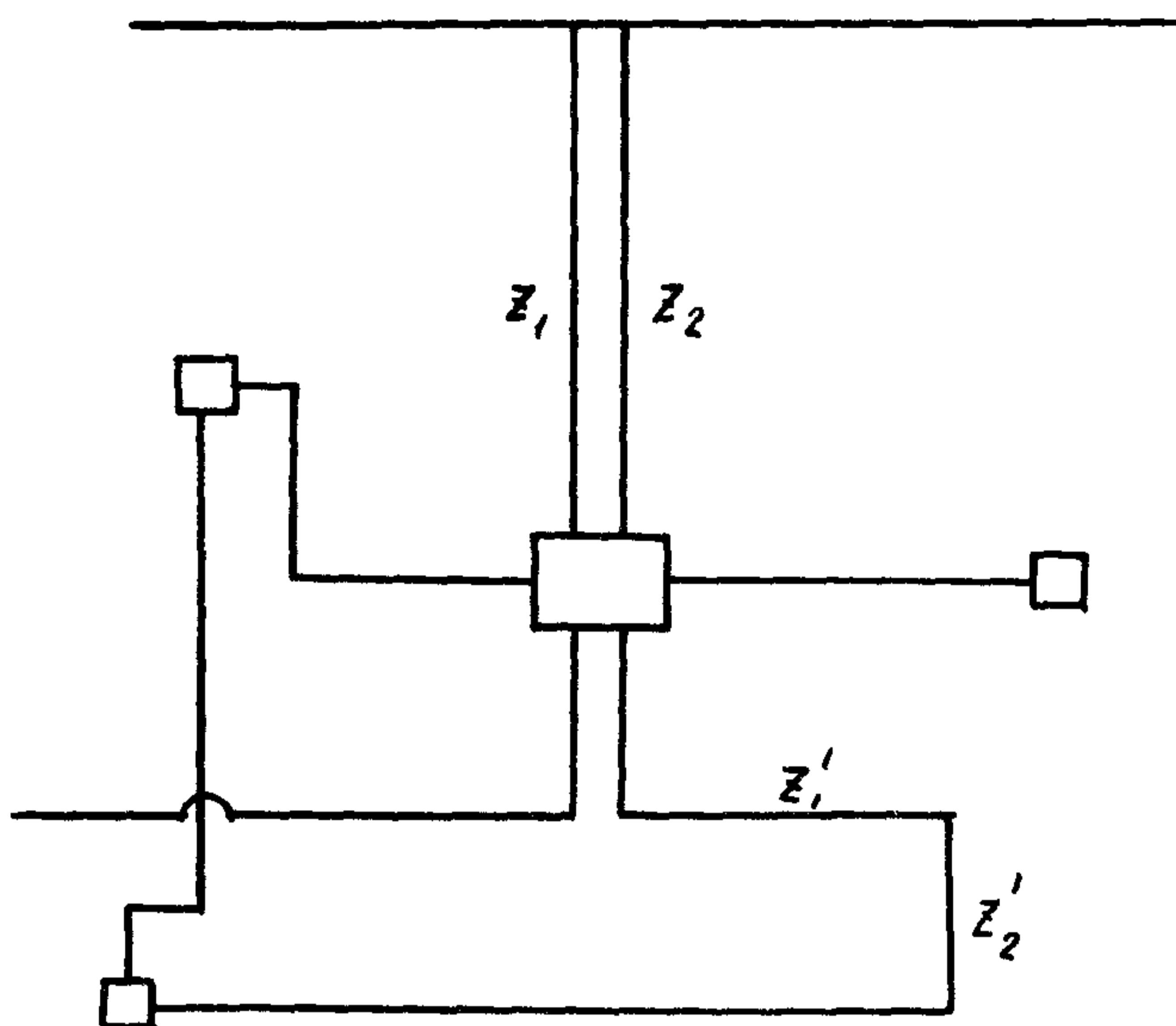
Рис. I. Схема коммуникаций компрессорной станции с обозначением входных сопротивлений параллельно и последовательно расположенных коммуникаций
