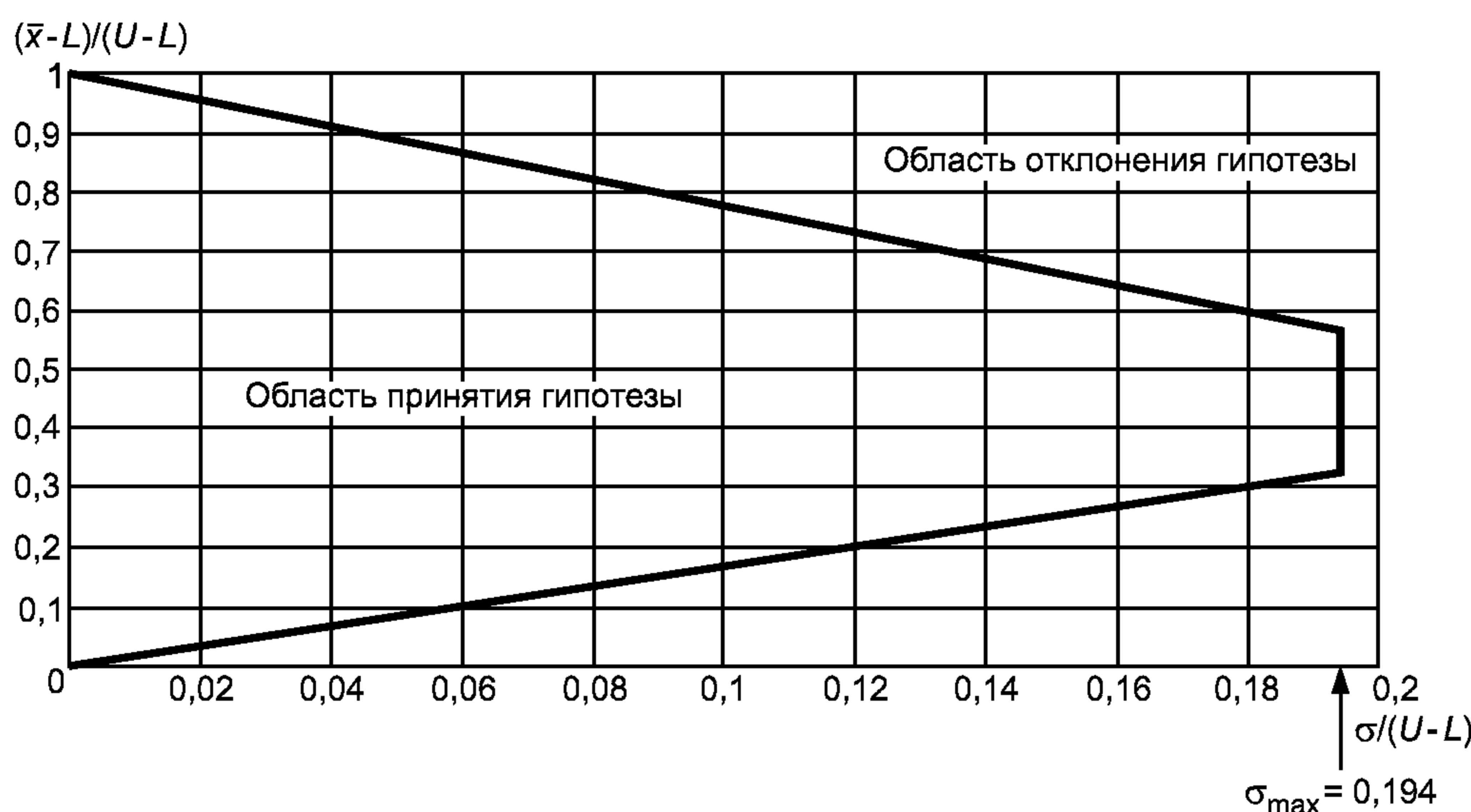
Рисунок 13 — Области принятия и отклонения гипотезы для сложного контроля двусторонних пределов поля допуска,  $s$ -метод, код объема выборки M, объединенный AQL = 1,5 %, для верхнего предела AQL = 0,4 %
