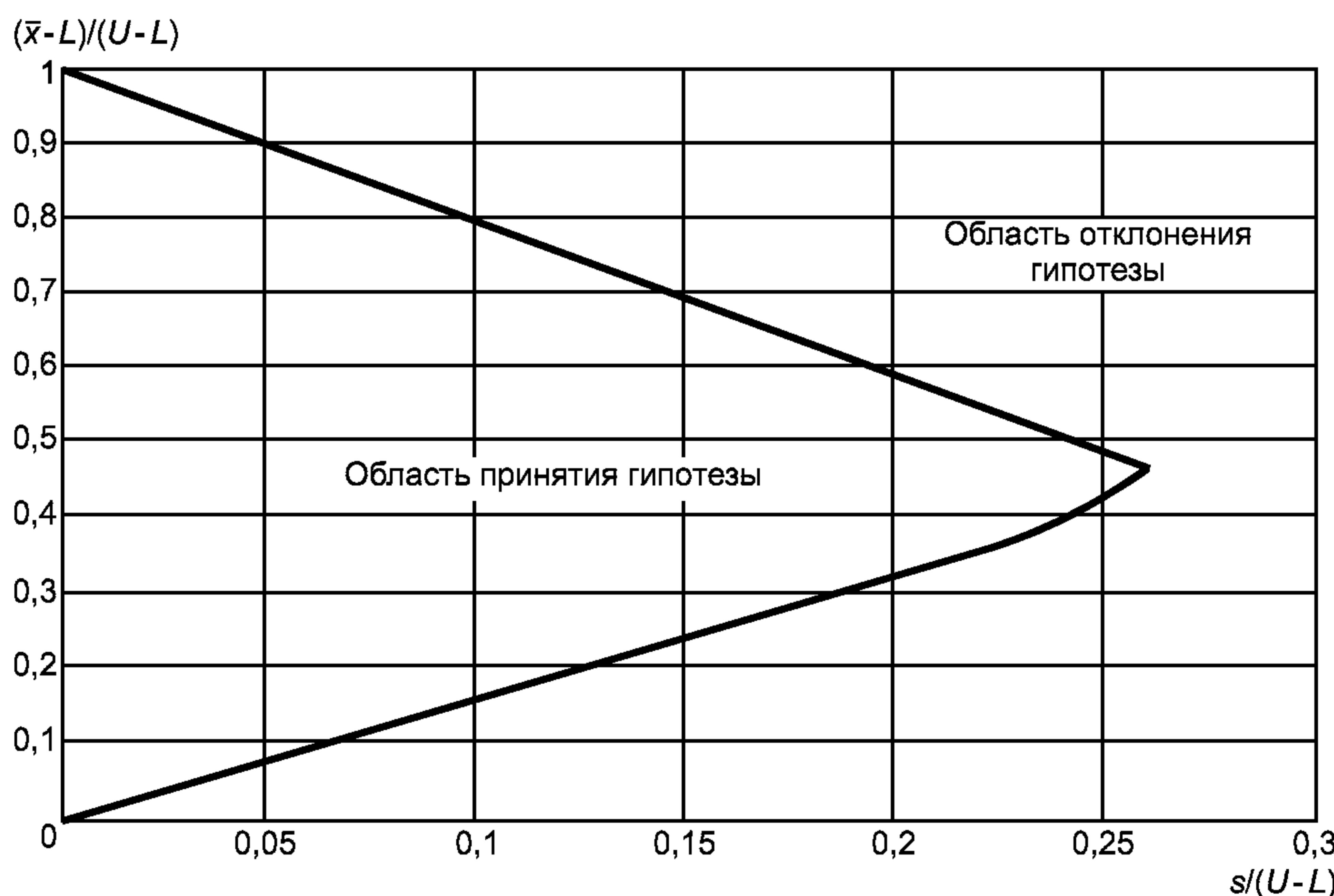
Рисунок 12 — Области принятия и отклонения гипотезы для сложного контроля двусторонних пределов поля допуска,  $s$ -метод, код объема выборки G, объединенный  $AQL = 1,5\%$ , для верхнего предела  $AQL = 0,4\%, n = 10, p^* = 0,03323$
