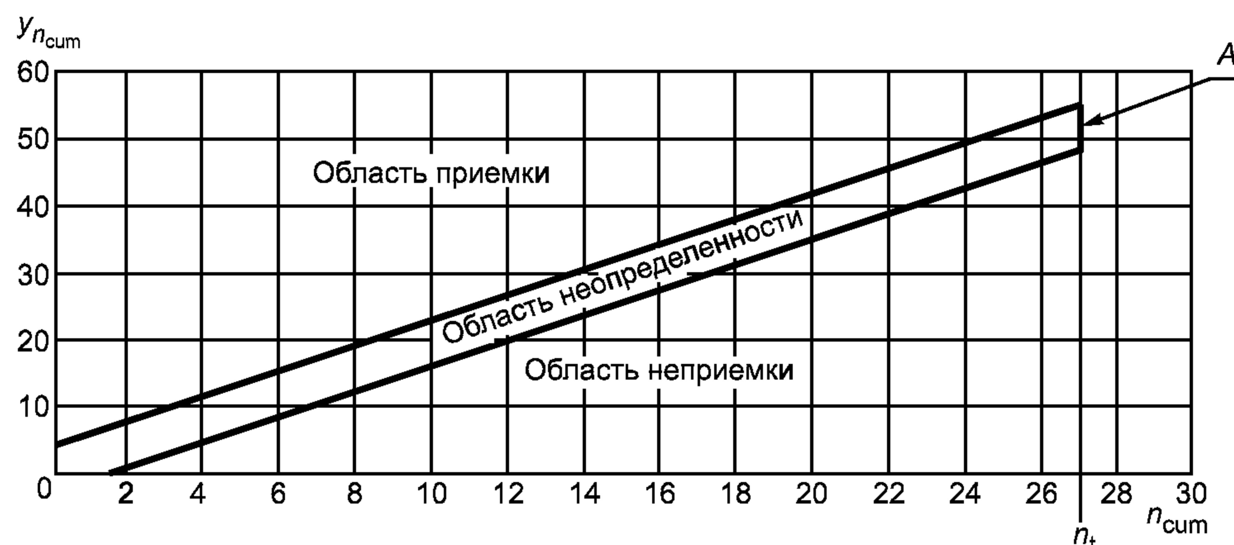
Рисунок 14 — Приемочная карта для последовательного выборочного контроля по количественному признаку для единственного предела поля допуска,  $s$ -метод, код объема выборки K,  $\sigma = 1,0$ , AQL = 1,0 %,  $h_A = 2,764$ ,  $h_R = 3,895$ ,  $g = 1,900$ ,  $n_t = 27$
