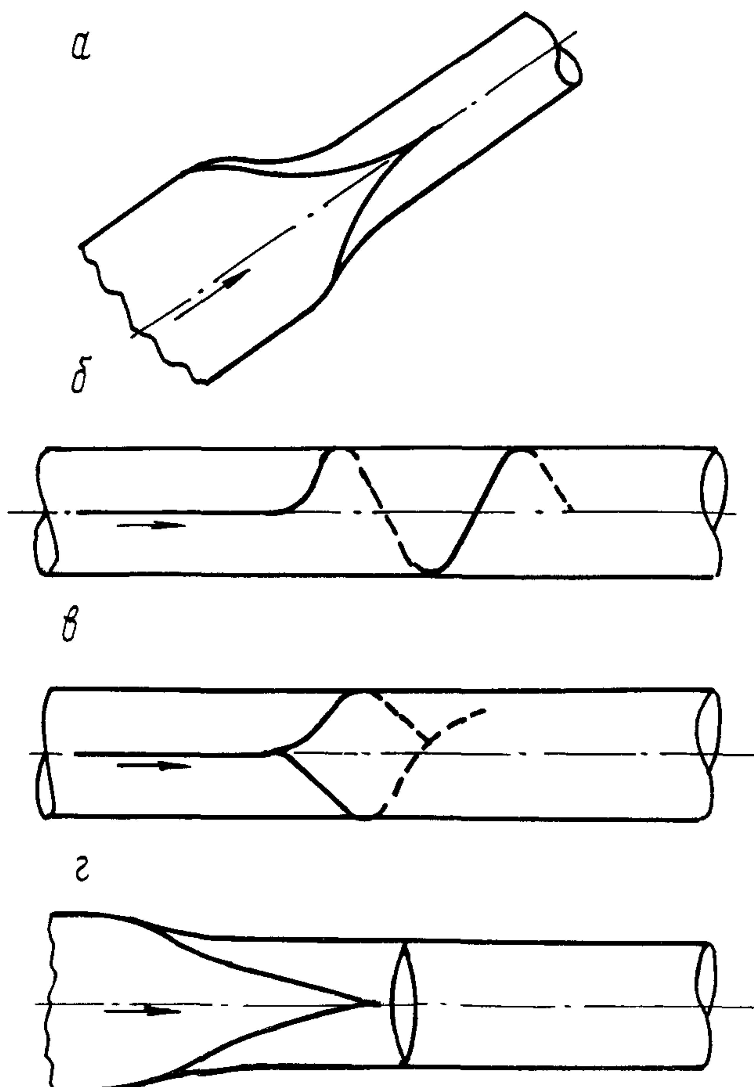
Рис.4. Типы остановок вязких разрушений трубопроводов:
