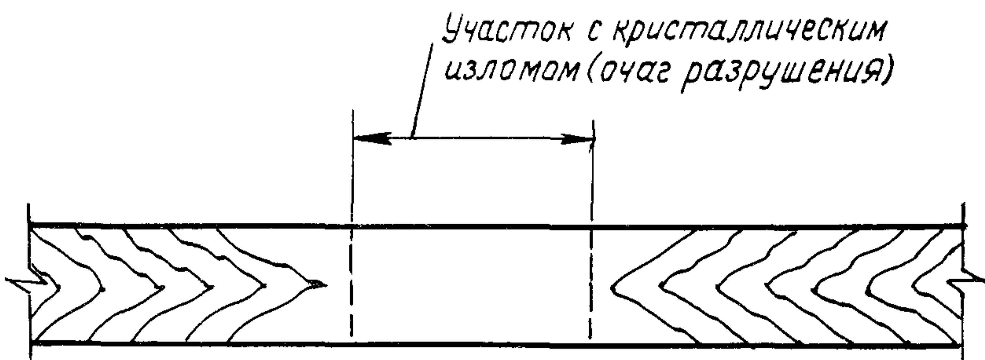
Рис.2. Схождение шевронного узора ("елочки") к очагу разрушения
