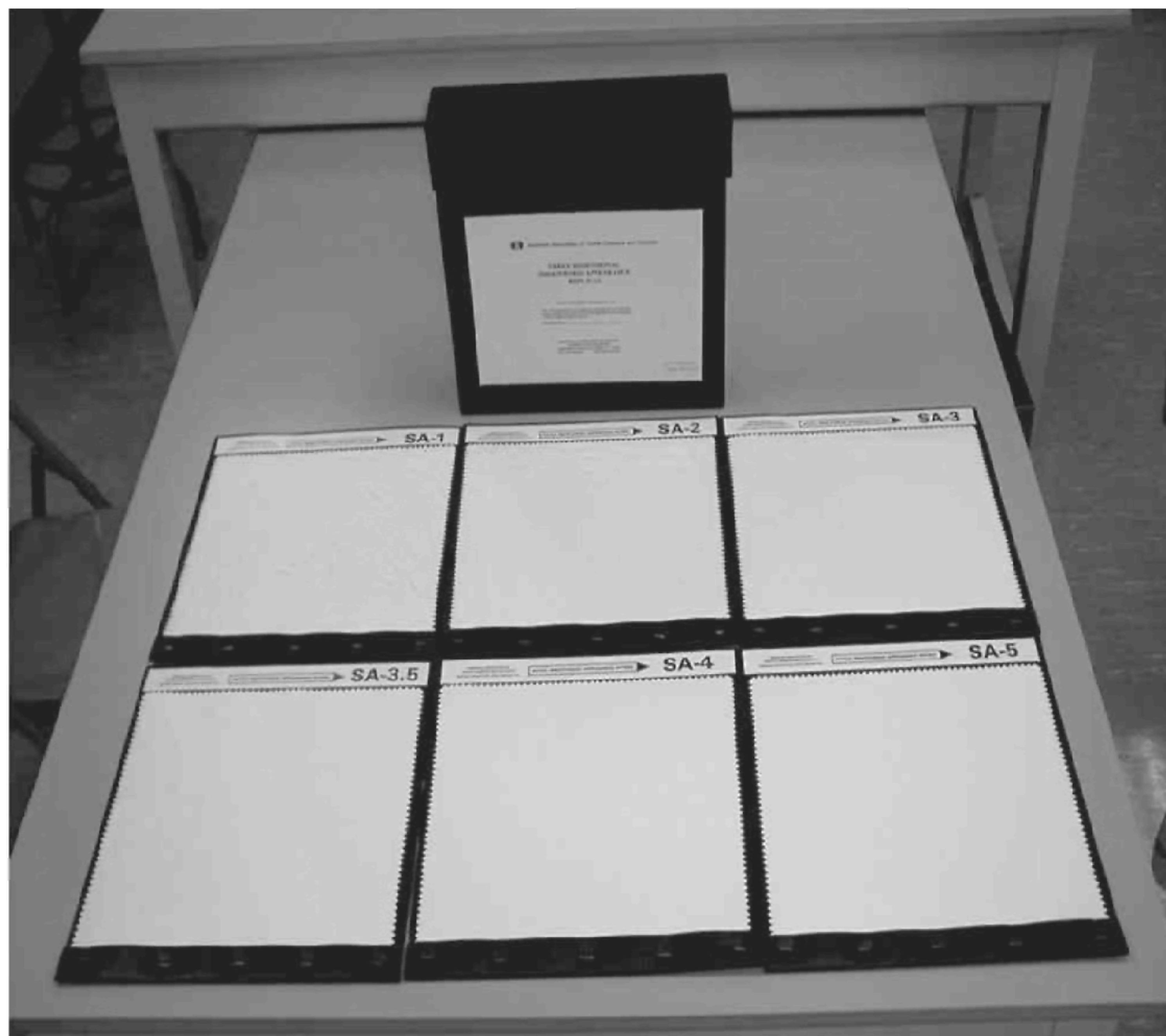
Рисунок 2 — Трехмерные эталоны гладкости
