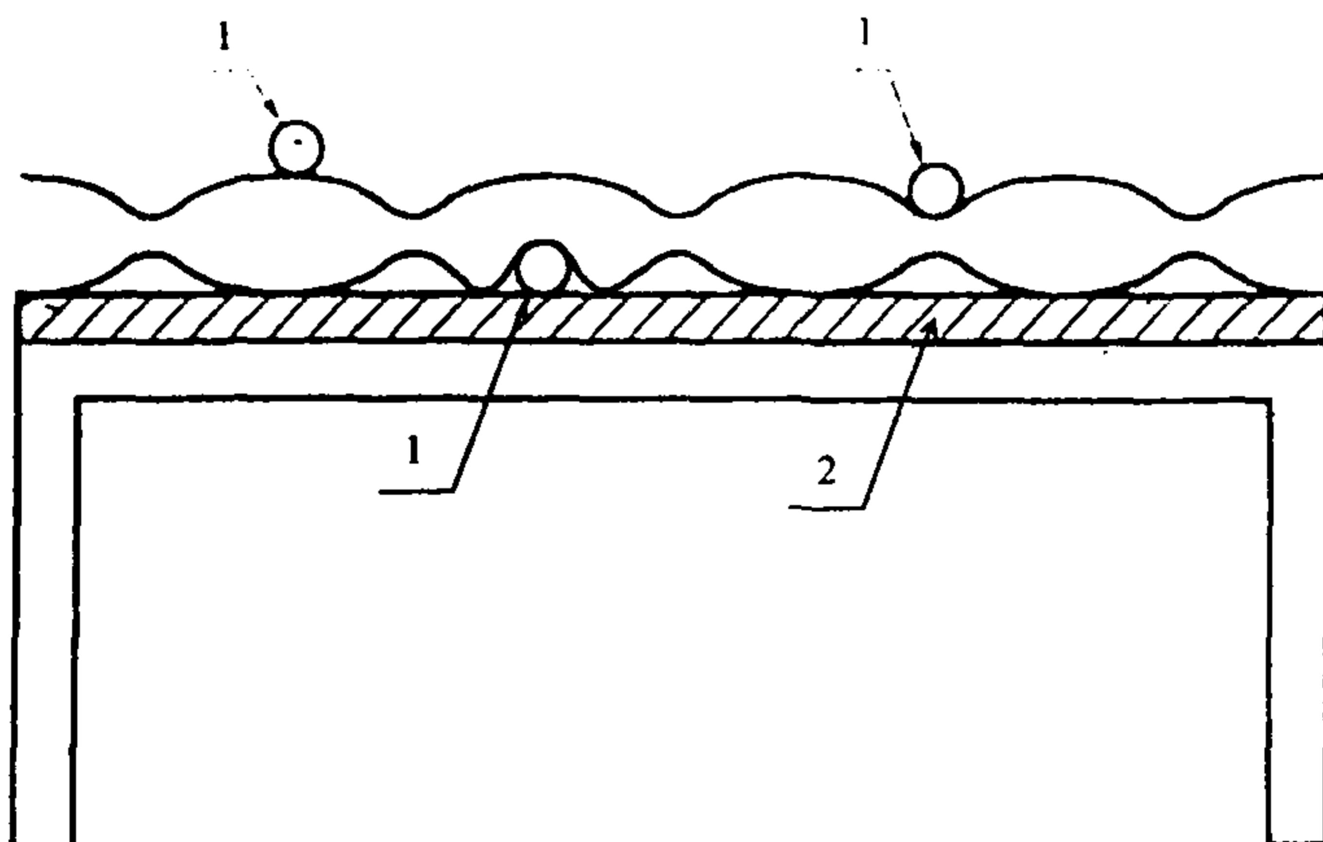
*Рисунок 3. Расположение источника зажигания при испытании стеганых одеял:*
