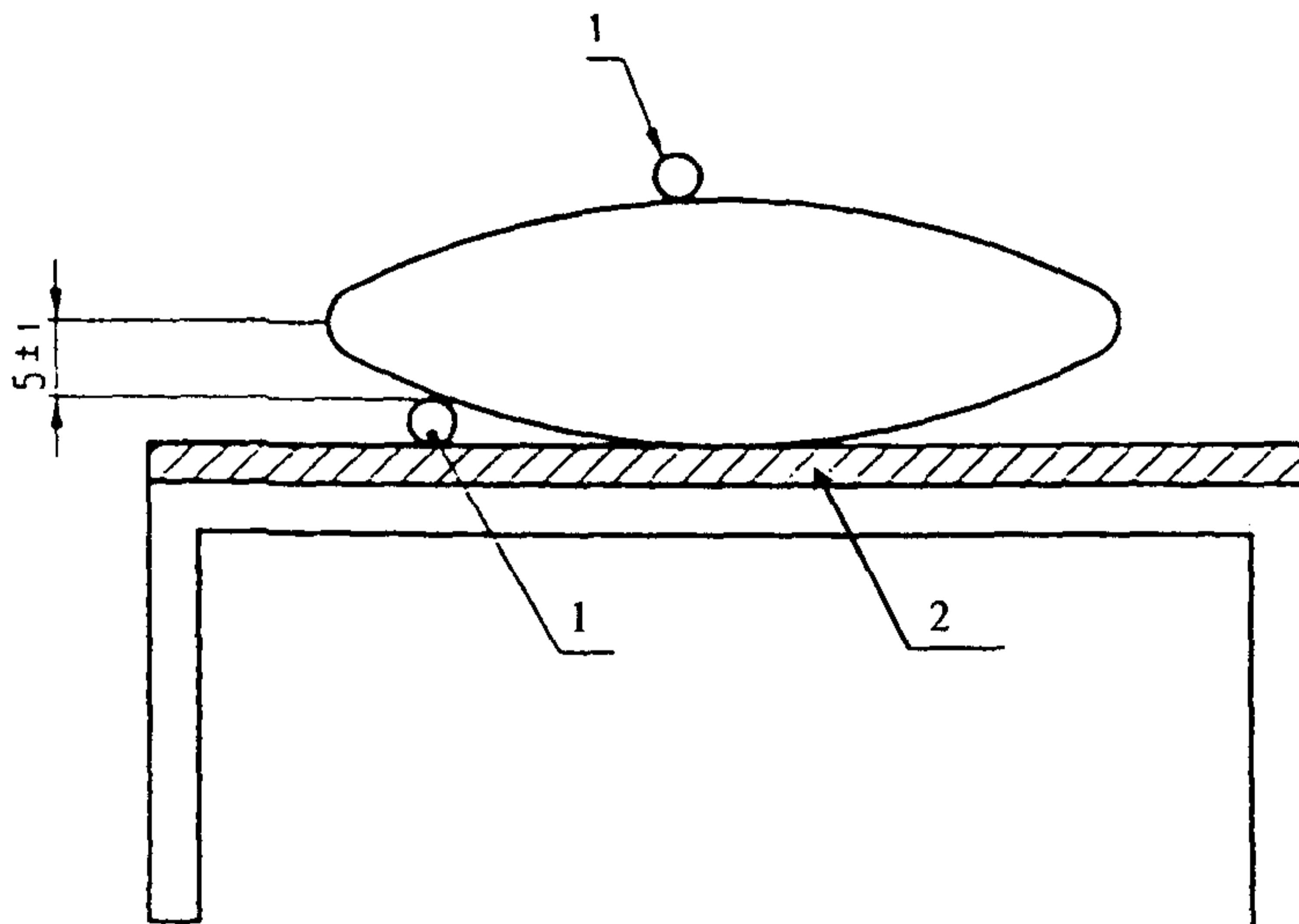
*Рисунок 4. Расположение источника зажигания при испытании подушек:*
