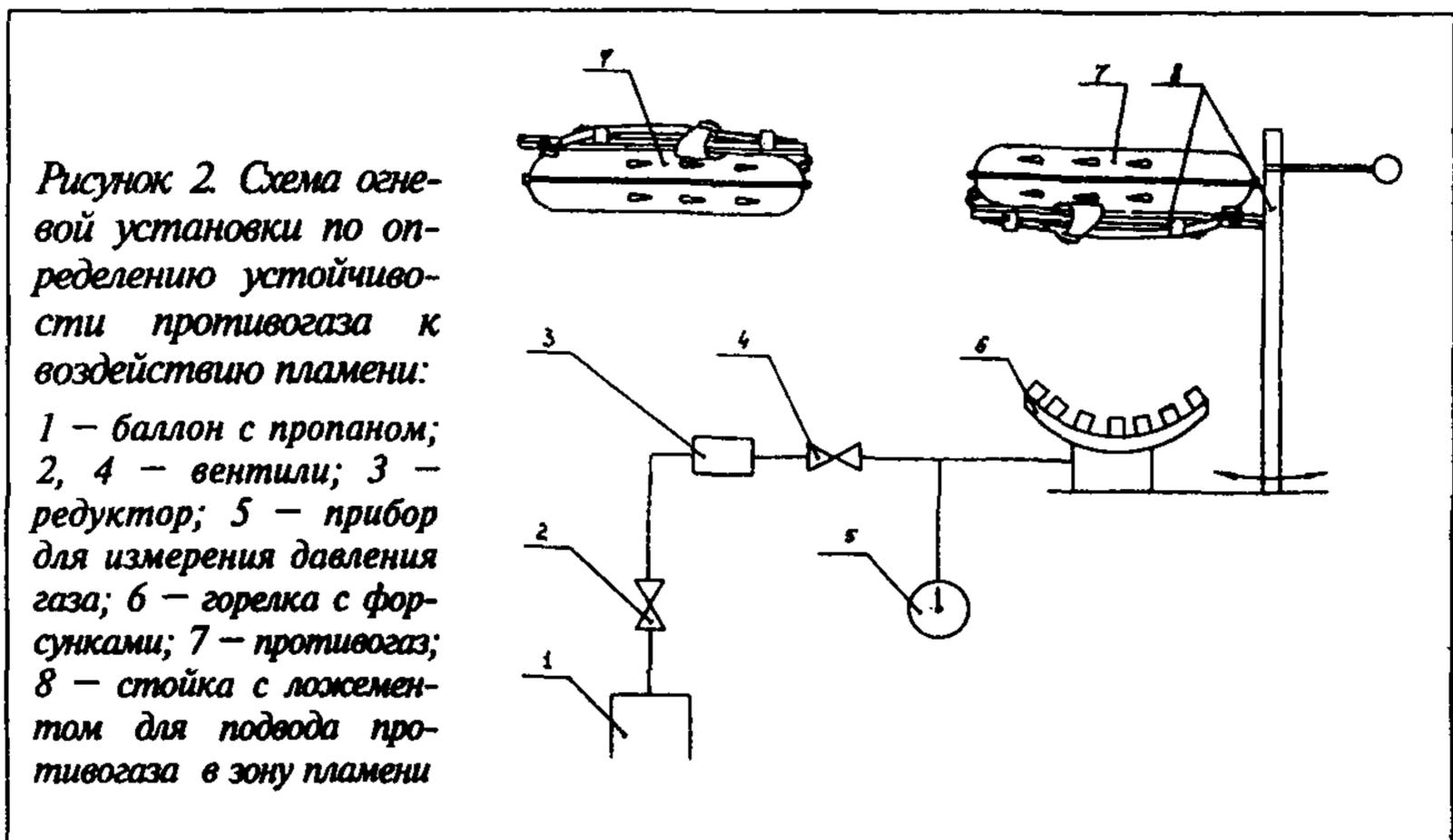
Включают прибор для измерения температуры пламени. Открывают запорный вентиль баллона с пропаном. Подносят запальное устройство к горелке с целью воспламенить газ. Устанавливают с помощью вентиля рабочее давление газа перед горелкой  $(2,4 \pm 0,2)$  кПа. Проводят замеры температуры пламени, определяют зону над горелкой, где температура пламени составляет  $(800 \pm 50)$  °С.
