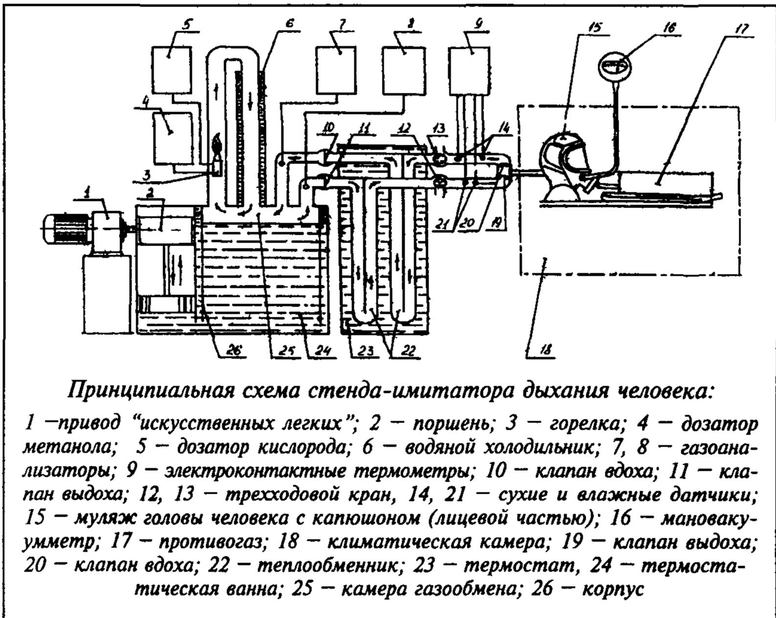
При испытании противогаза на стенде определяют время защитного действия, условия дыхания, параметры основных систем и устройств.
