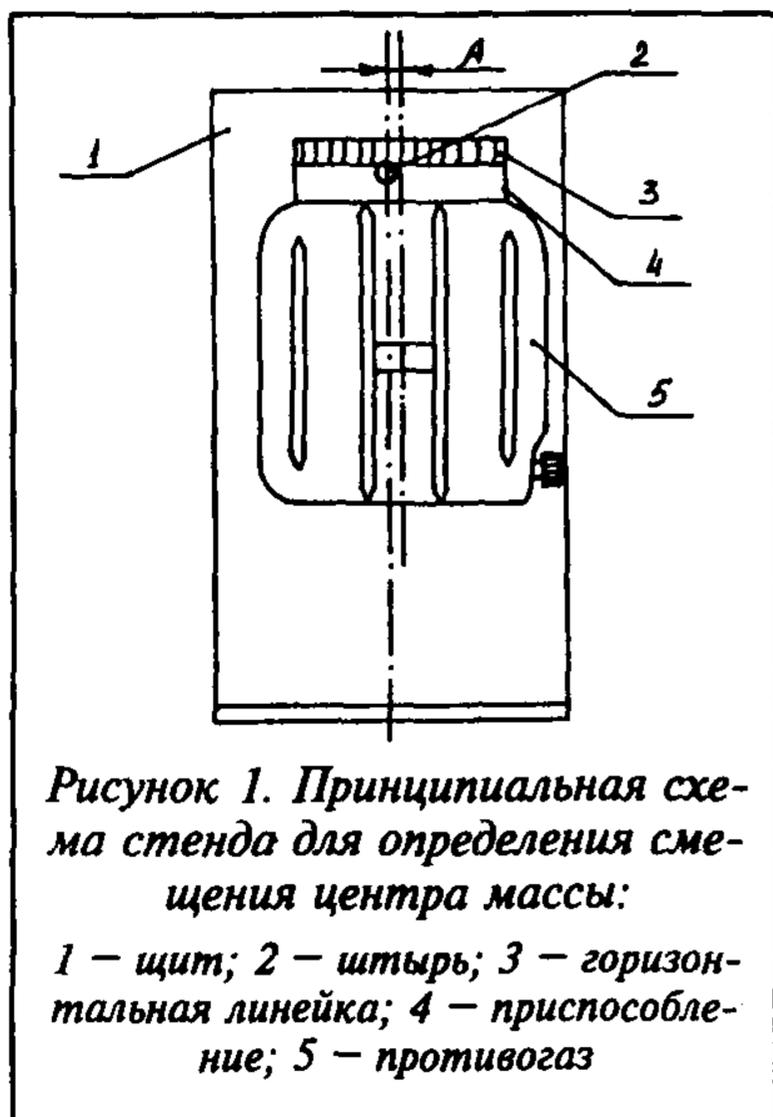
*Рисунок 1. Принципиальная схема стенда для определения смещения центра массы:
