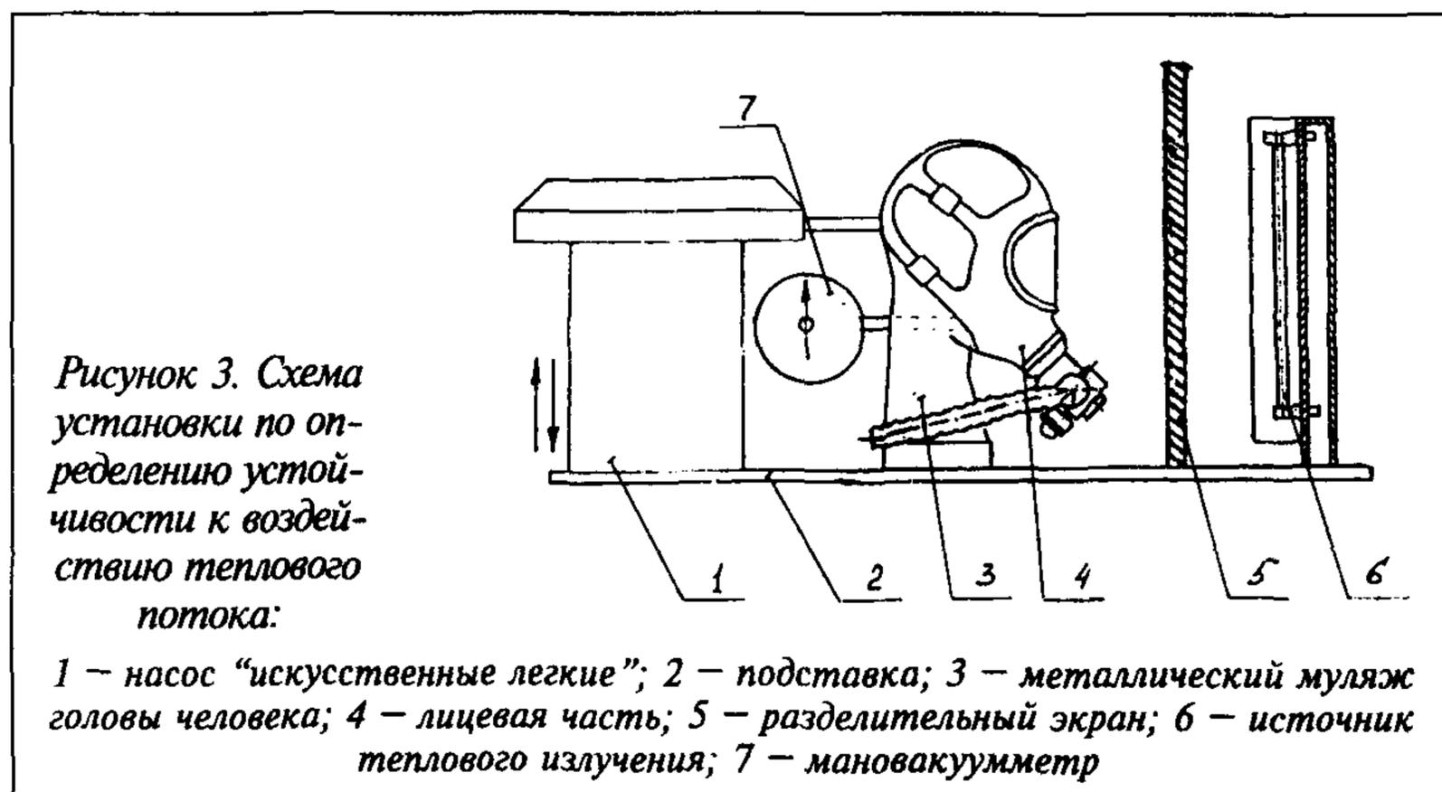
Включают источник теплового потока и с помощью датчика теплового потока определяют место, в котором плотность теплового потока составляет  $(8,5 \pm 0,5) \text{ кВт}/\text{м}^2$ , и отмечают данное место на подставке. Устанавливают на подставку разделительный экран. На отмеченное место ставят муляж головы человека с надетой лицевой частью противогаза.
