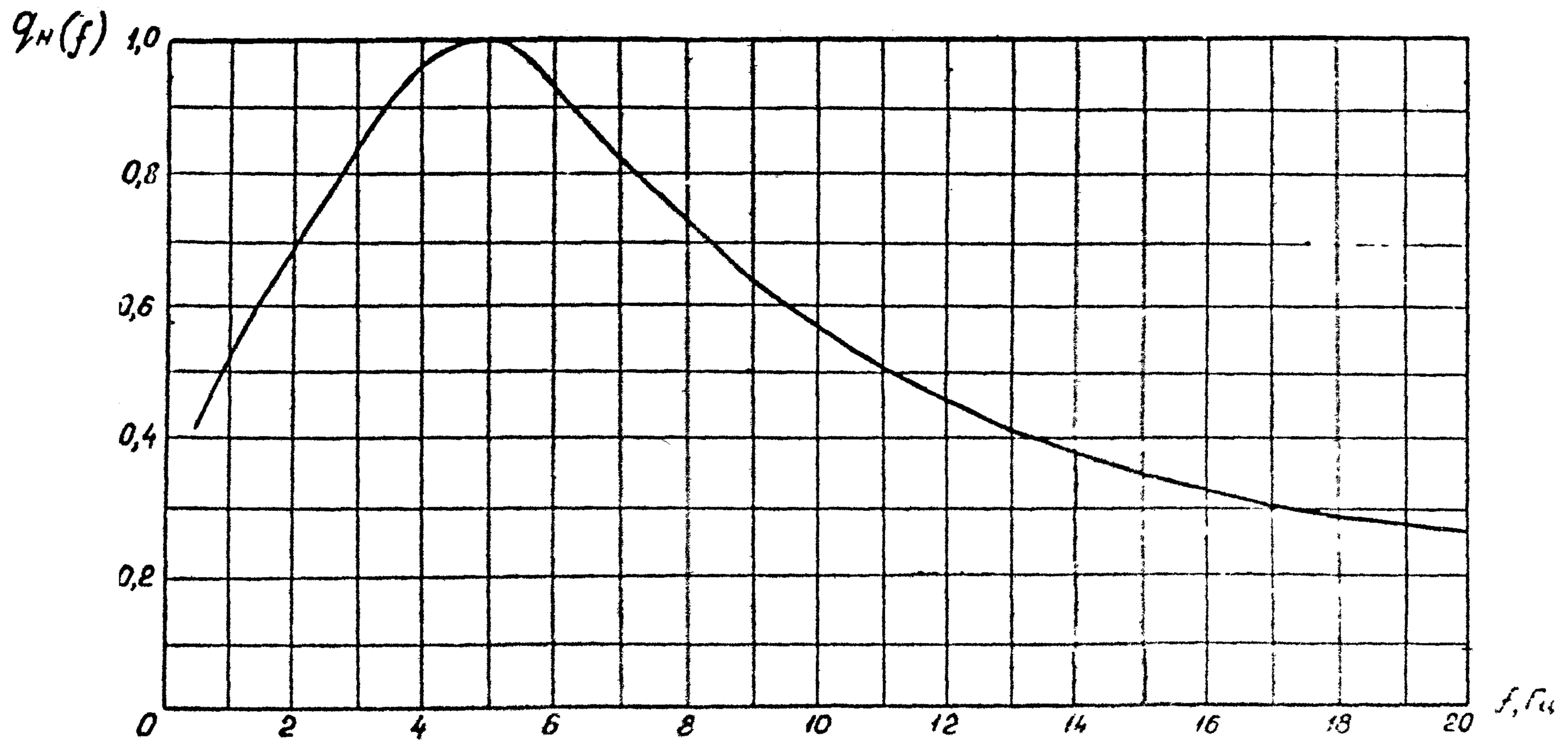
Черт.1 Амплитудно-частотная характеристика корректирующего фильтра
