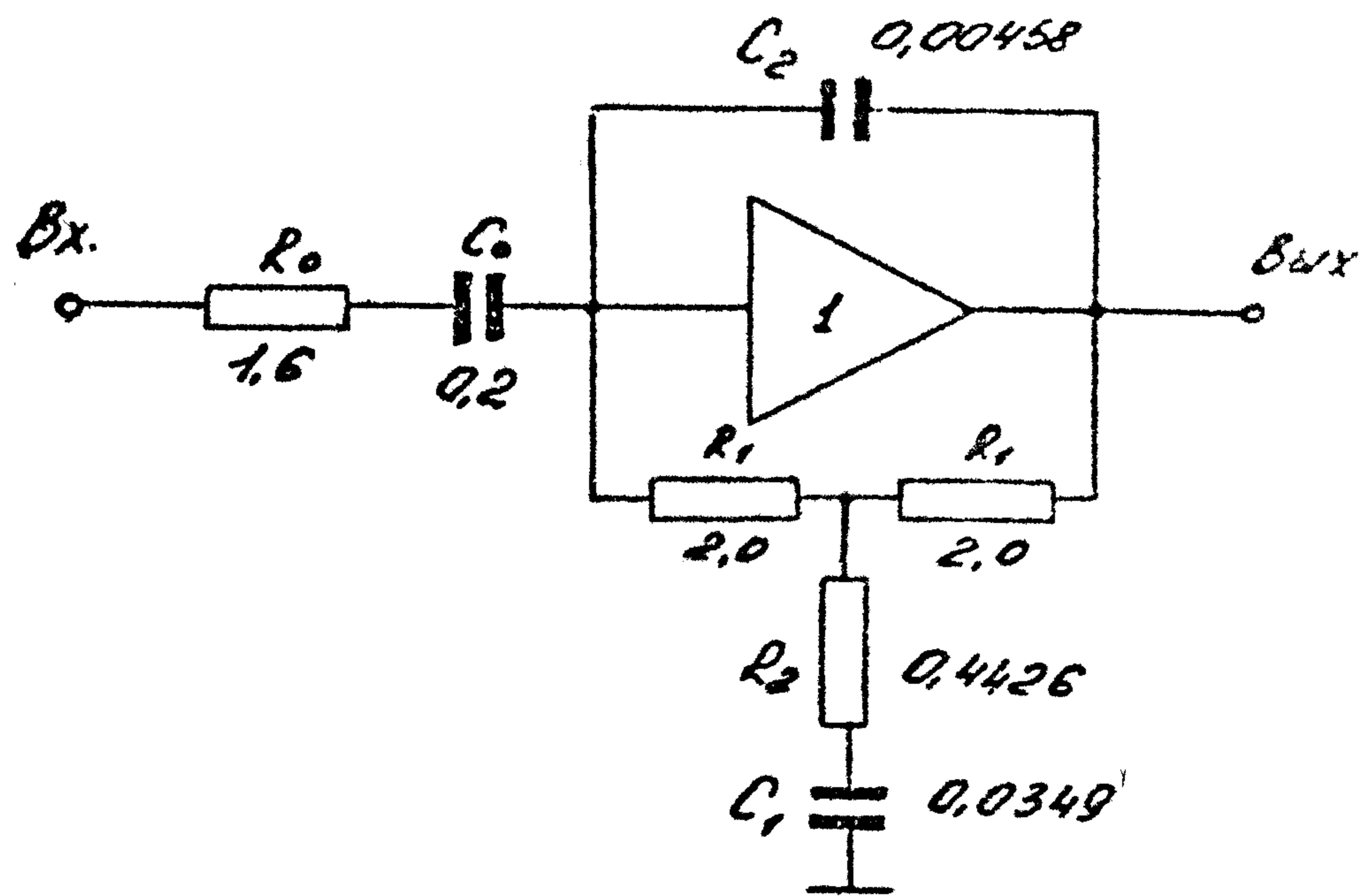
Принципиальная схема корректирующего фильтра
