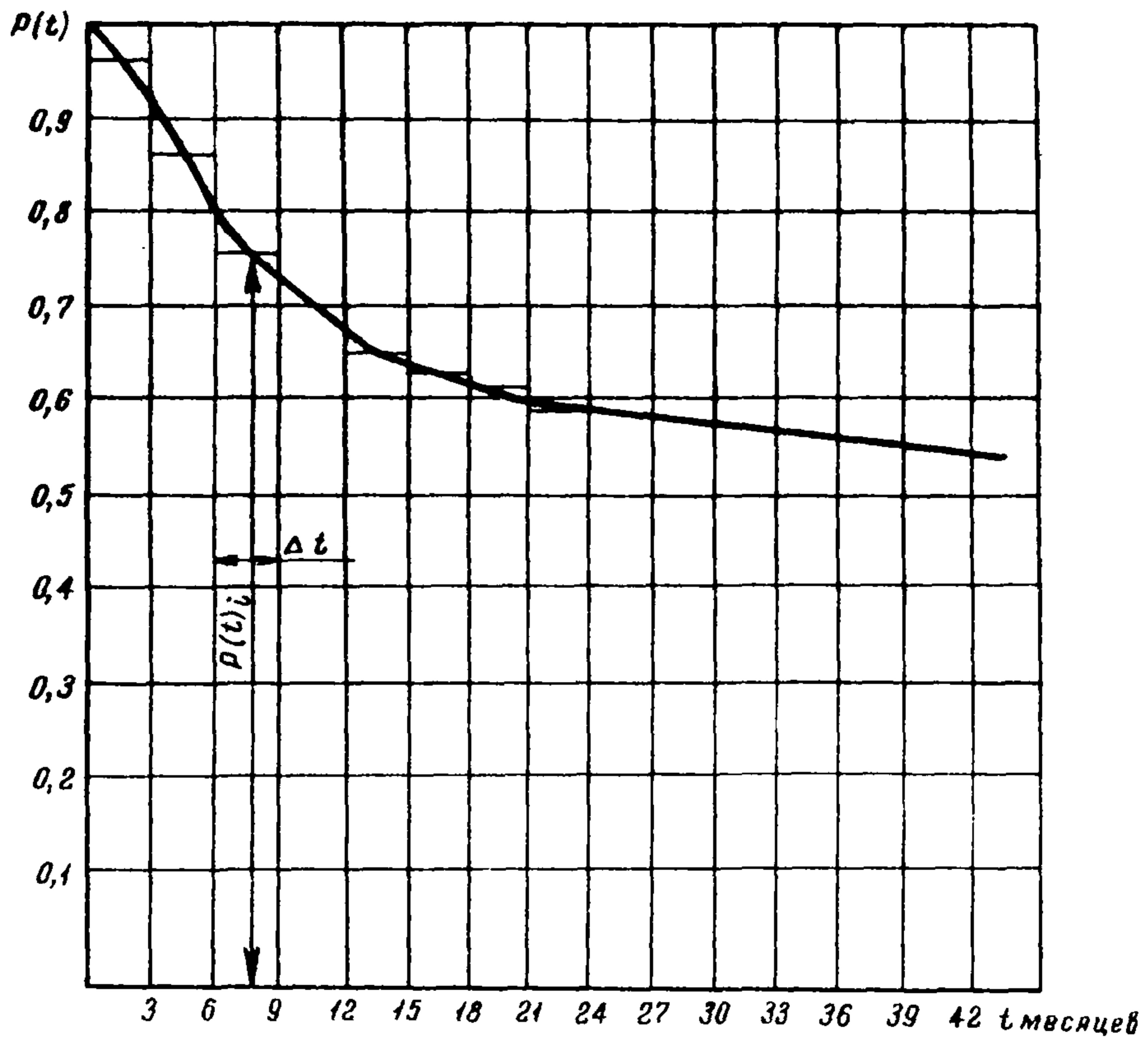
Кривая вероятности безотказной работы зубчатой муфты вентилятора ВОКД 1,5
