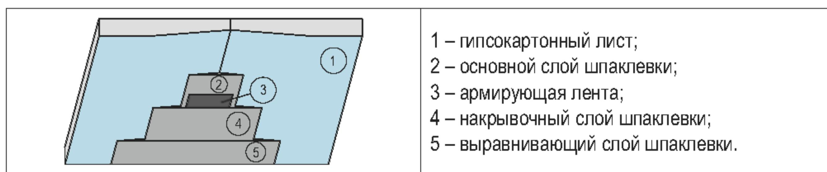
Последовательность действий при обработке стыка гипсокартонных листов, образованного обрезанными кромками гипсокартонных листов со снятой фаской под  $22,5^\circ$  на  $\frac{2}{3}$  толщины листа:
