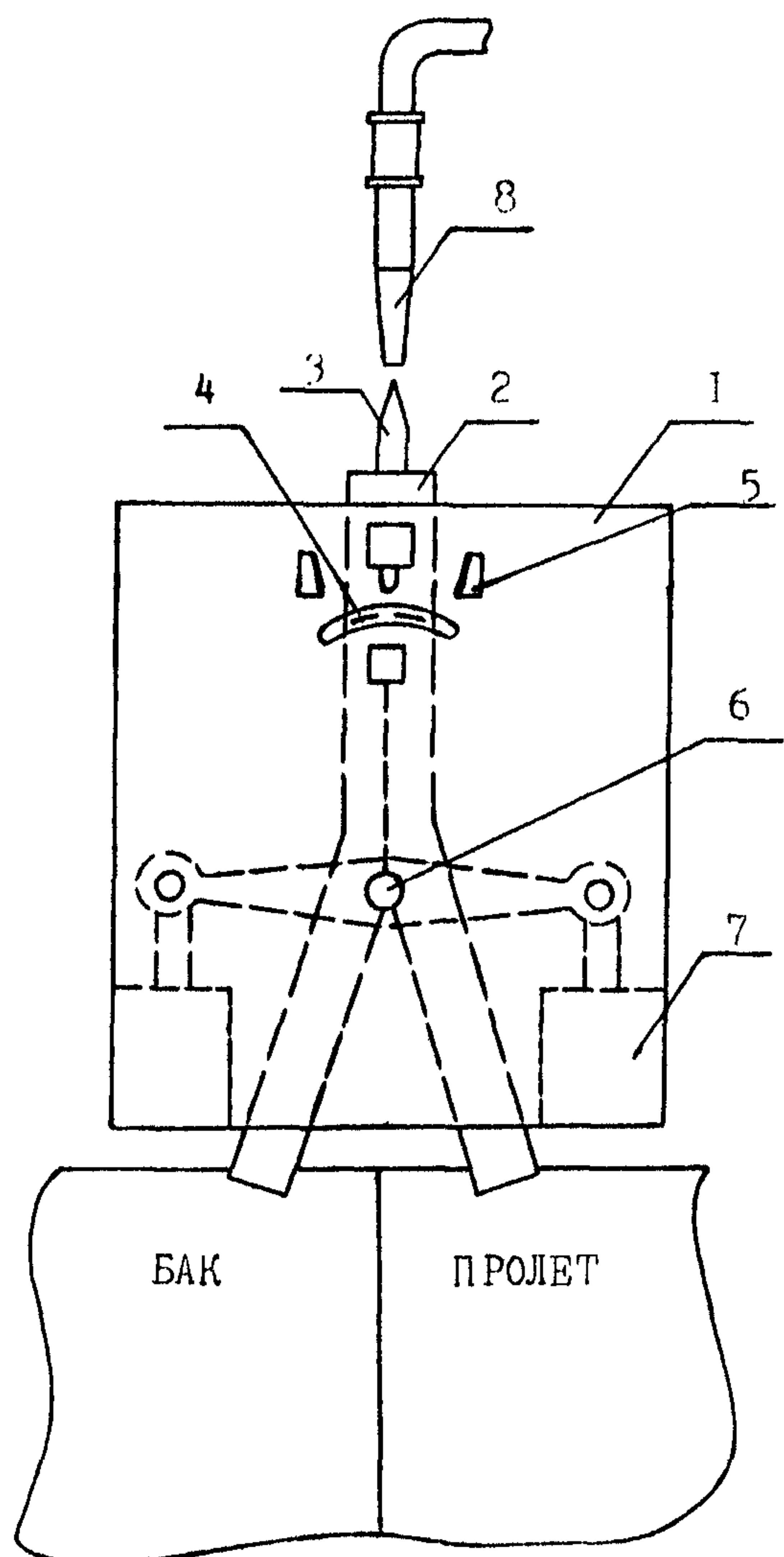
1-корпус; 2-поворотная заслонка; 3-рассекатель;
