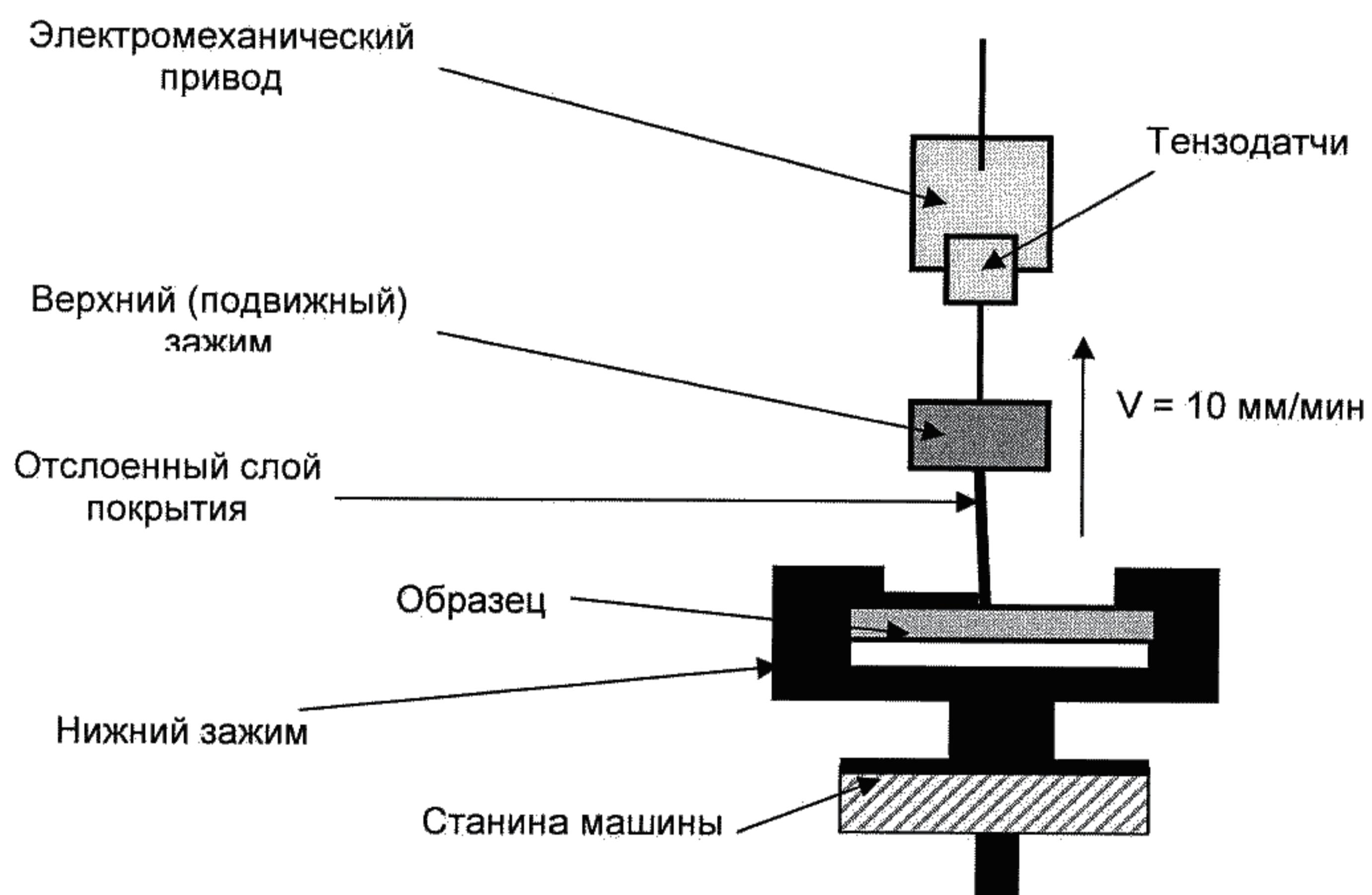
**Рисунок 2 - Схема измерения адгезии на плоских образцах**
