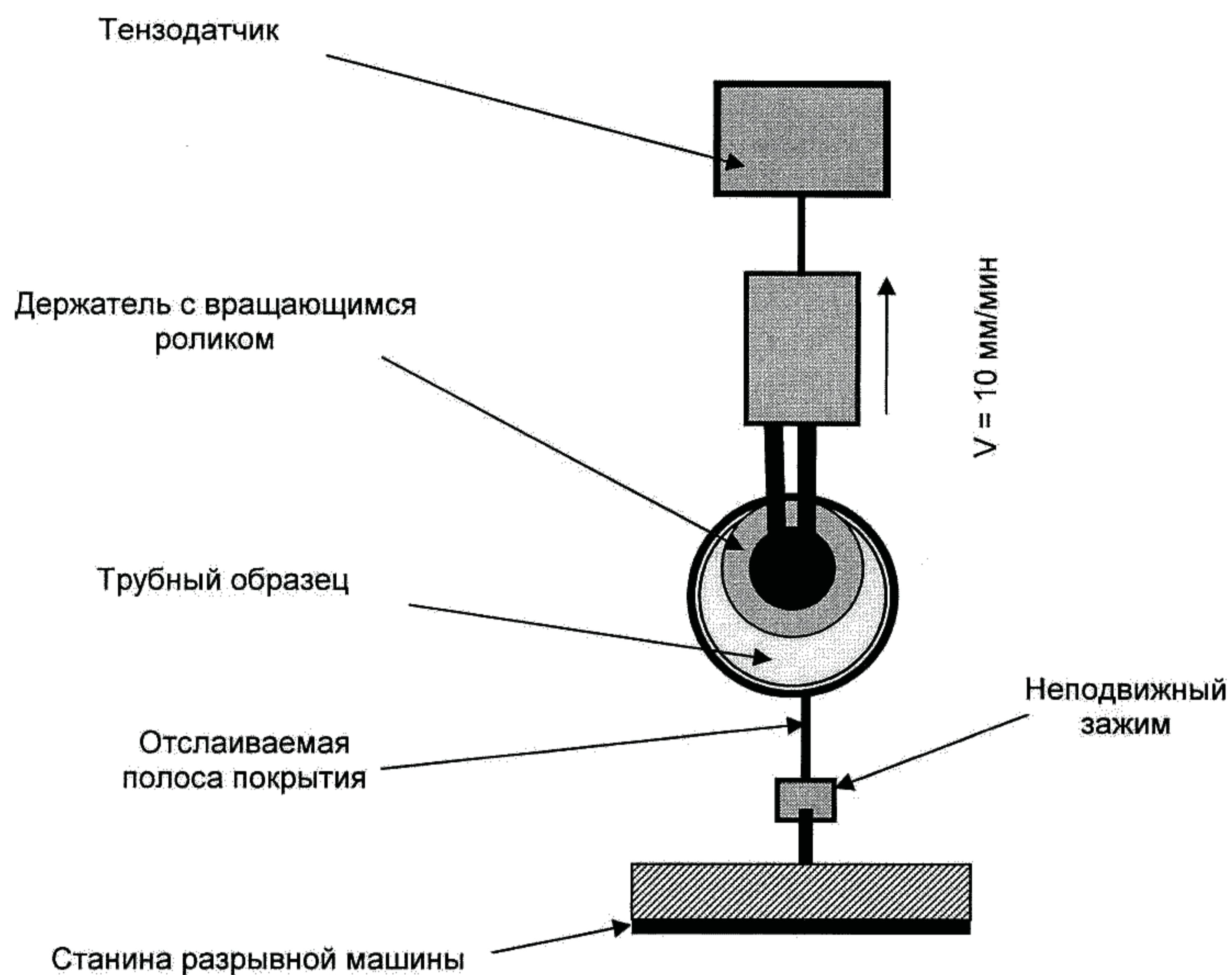
**Рисунок 3 - Схема измерения адгезии на стальных трубах**
