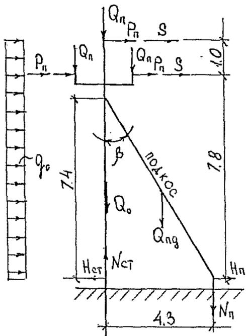
Максимальные нагрузки на фундаменты угловых промежуточных опор имеют место в нормальном режиме работы ВЛ и создаются составляющими от тяжения проводов и ветровыми нагрузками на провода и тело опоры. При этом подкос передает на сваю сжимающую нагрузку, стойка - вырывающую.
