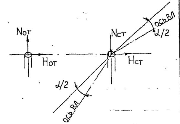
1. В таблицах даны нагрузки на фундаменты нормальных опор на уровне 0,6 м. выше поверхности земли. Для повышенных опор эти нагрузки имеют место на высоте 2,5 м. от поверхности земли.
