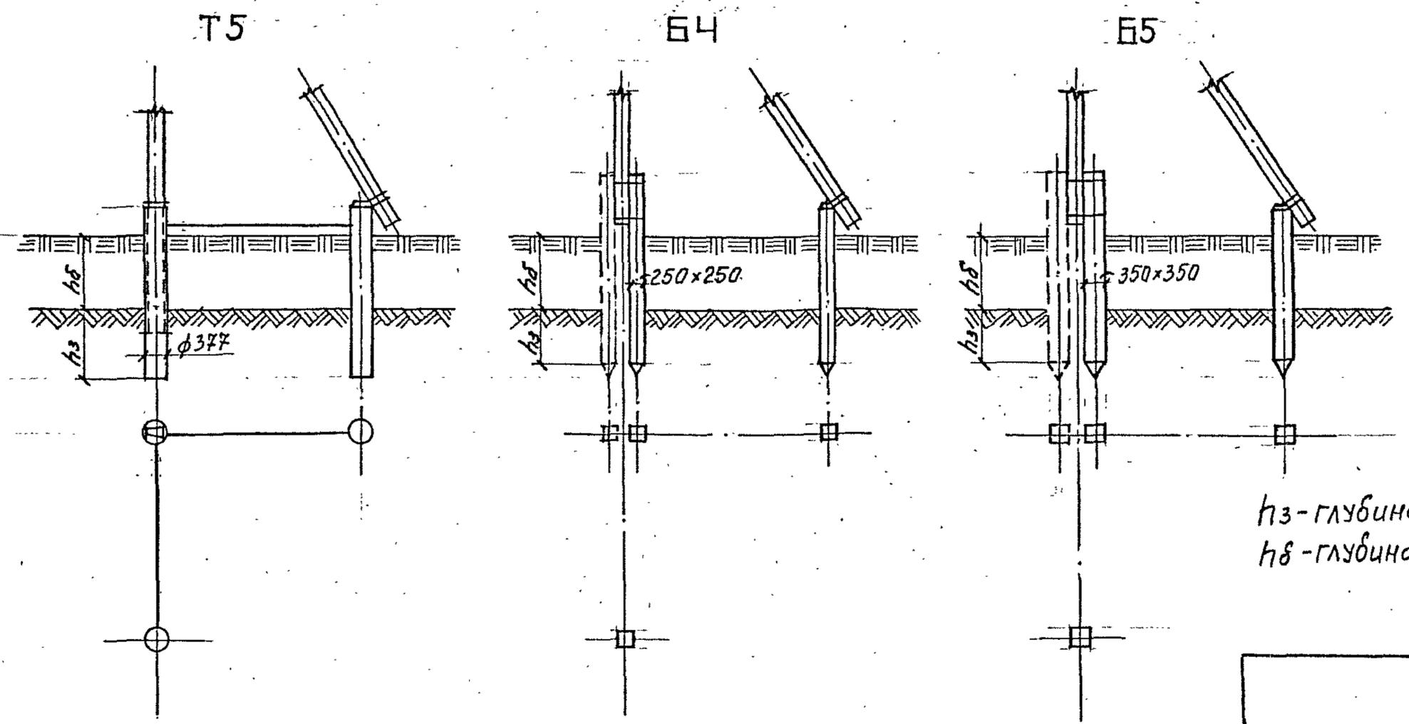
$h_3$  - глубина заделки в минеральный грунт
