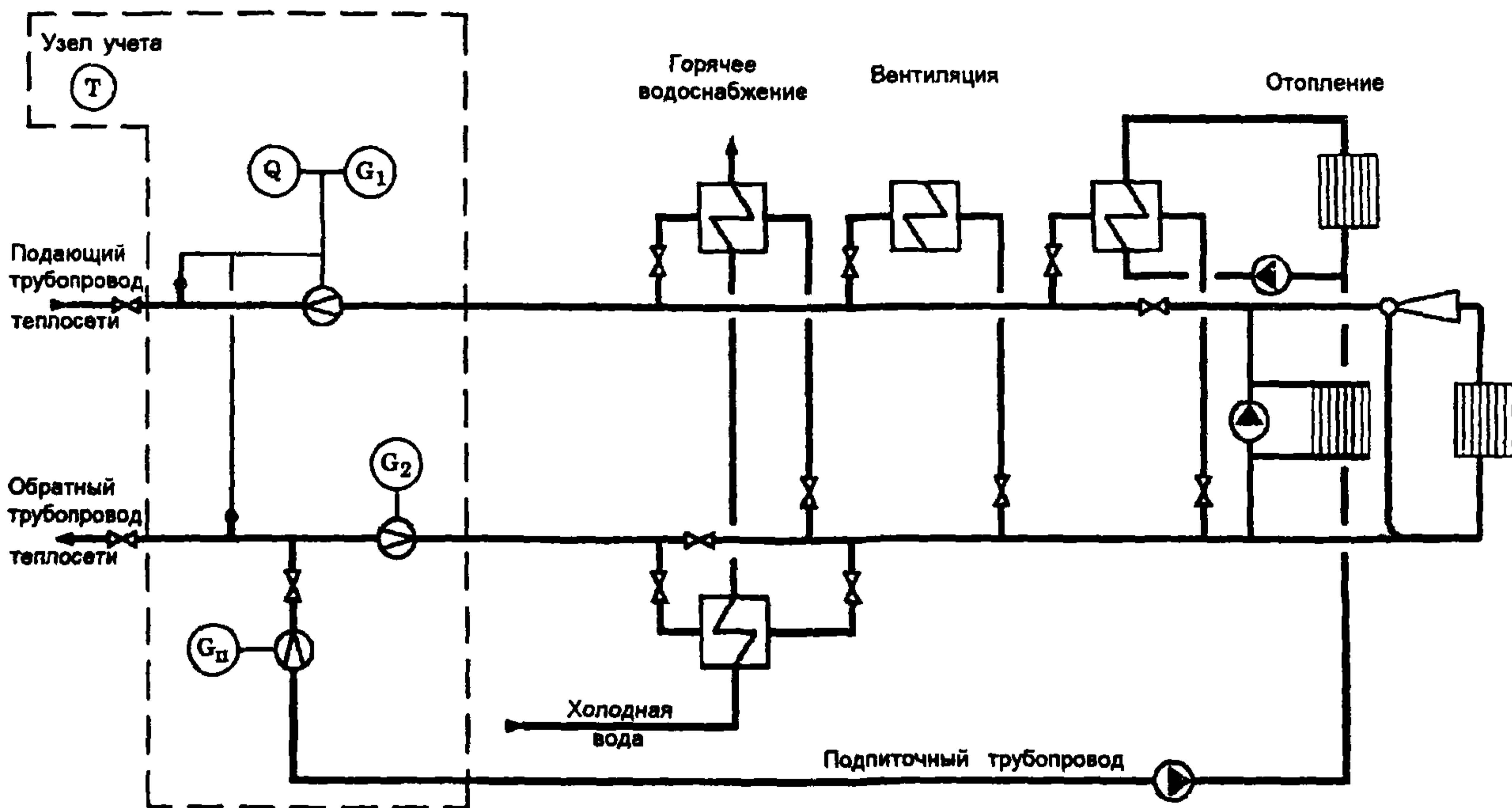
Рис. 6. Принципиальная схема размещения точек измерения количества тепловой энергии и массы (объема) теплоносителя в закрытых системах теплопотребления с суммарной тепловой нагрузкой, не превышающей 0,5 Гкал/ч
