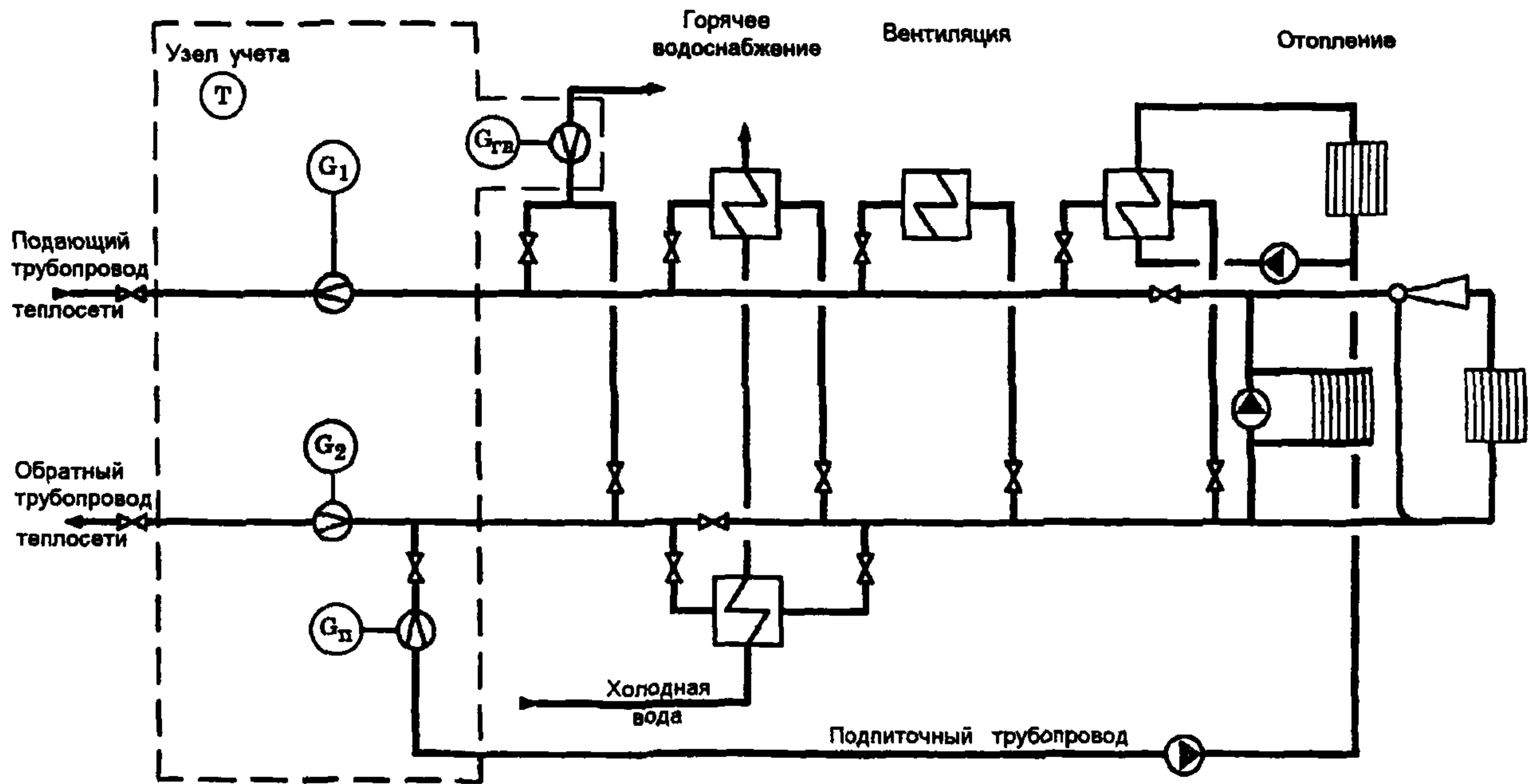
Рис 7 Принципиальная схема размещения точек измерения количества тепловой энергии и массы (объема) теплоносителя в открытых системах теплопотребления с суммарной тепловой нагрузкой, не превышающей 0,1 Гкал/ч
