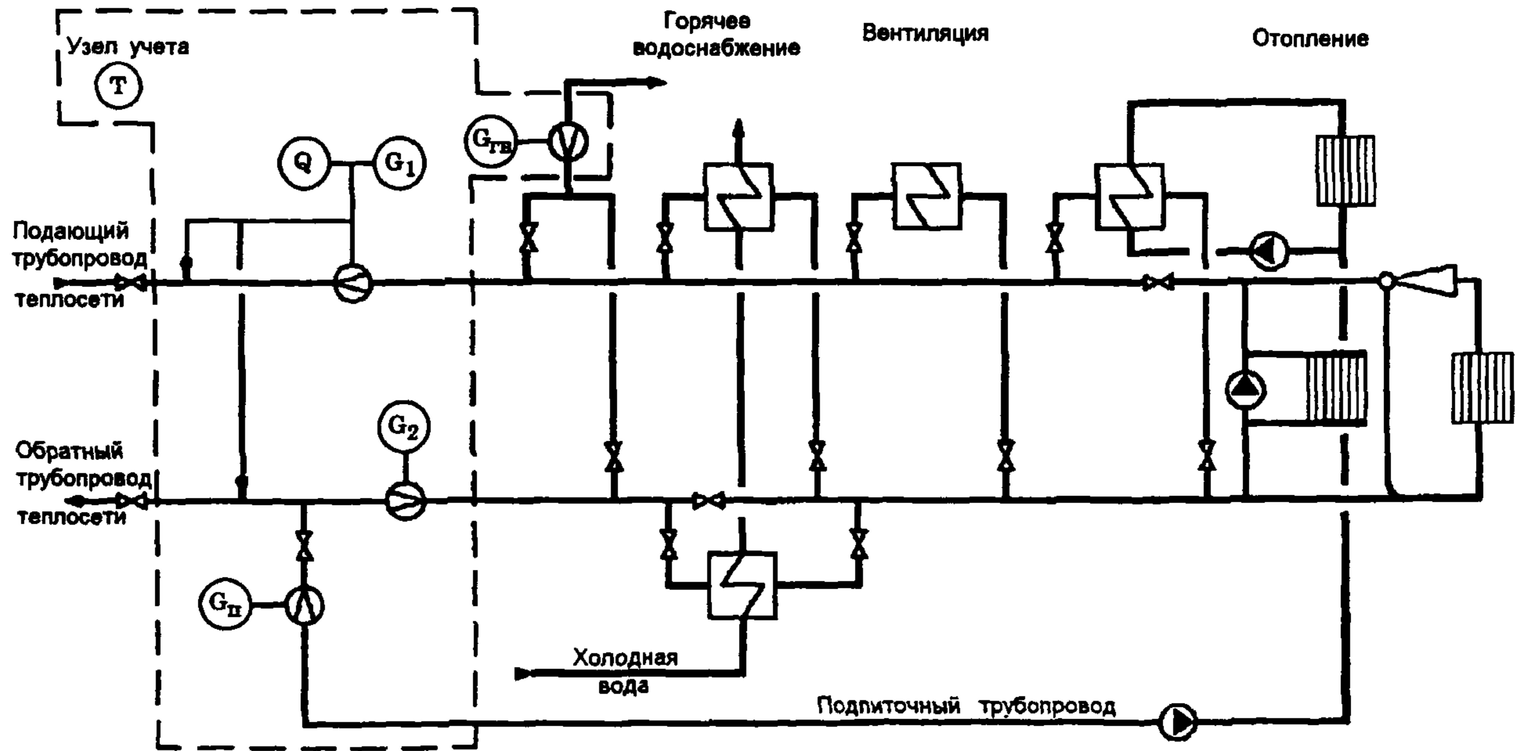
Рис. 5 Принципиальная схема размещения точек измерения количества тепловой энергии и массы (объема) теплоносителя в открытых системах теплопотребления с суммарной тепловой нагрузкой, не превышающей 0,5 Гкал/ч
