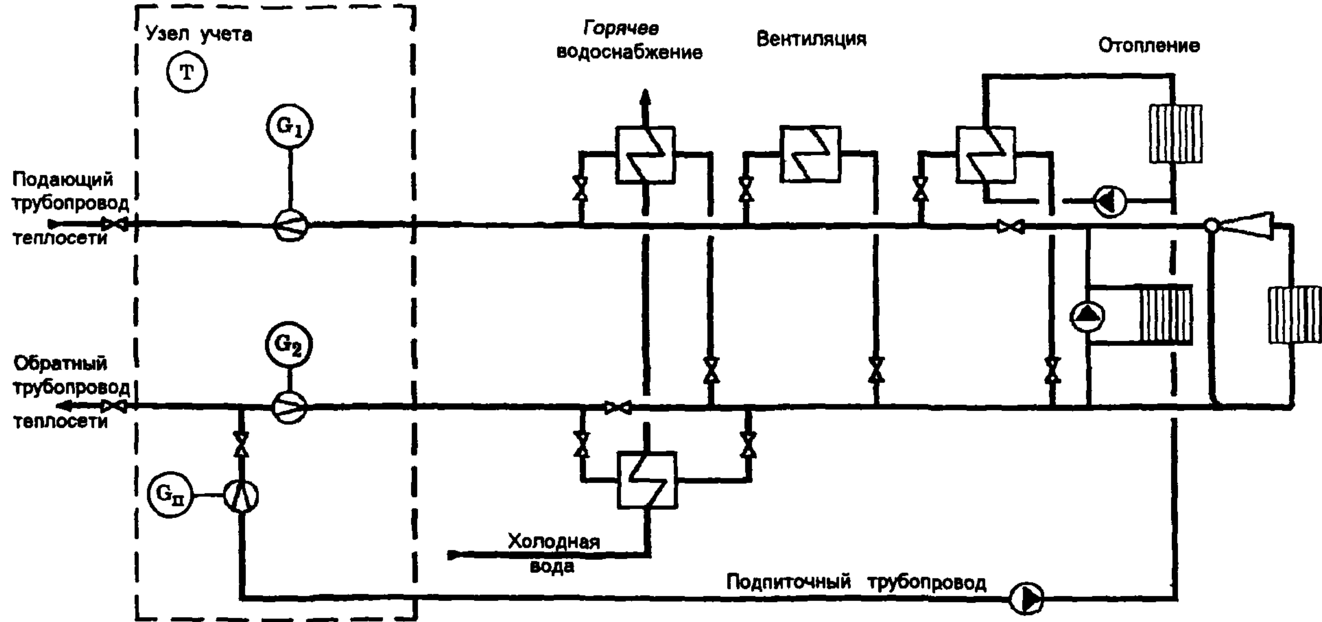
Рис 8 Принципиальная схема размещения точек измерения количества тепловой энергии и массы (объема) теплоносителя в закрытых системах теплопотребления с суммарной тепловой нагрузкой, не превышающей 0,1 Гкал/ч
