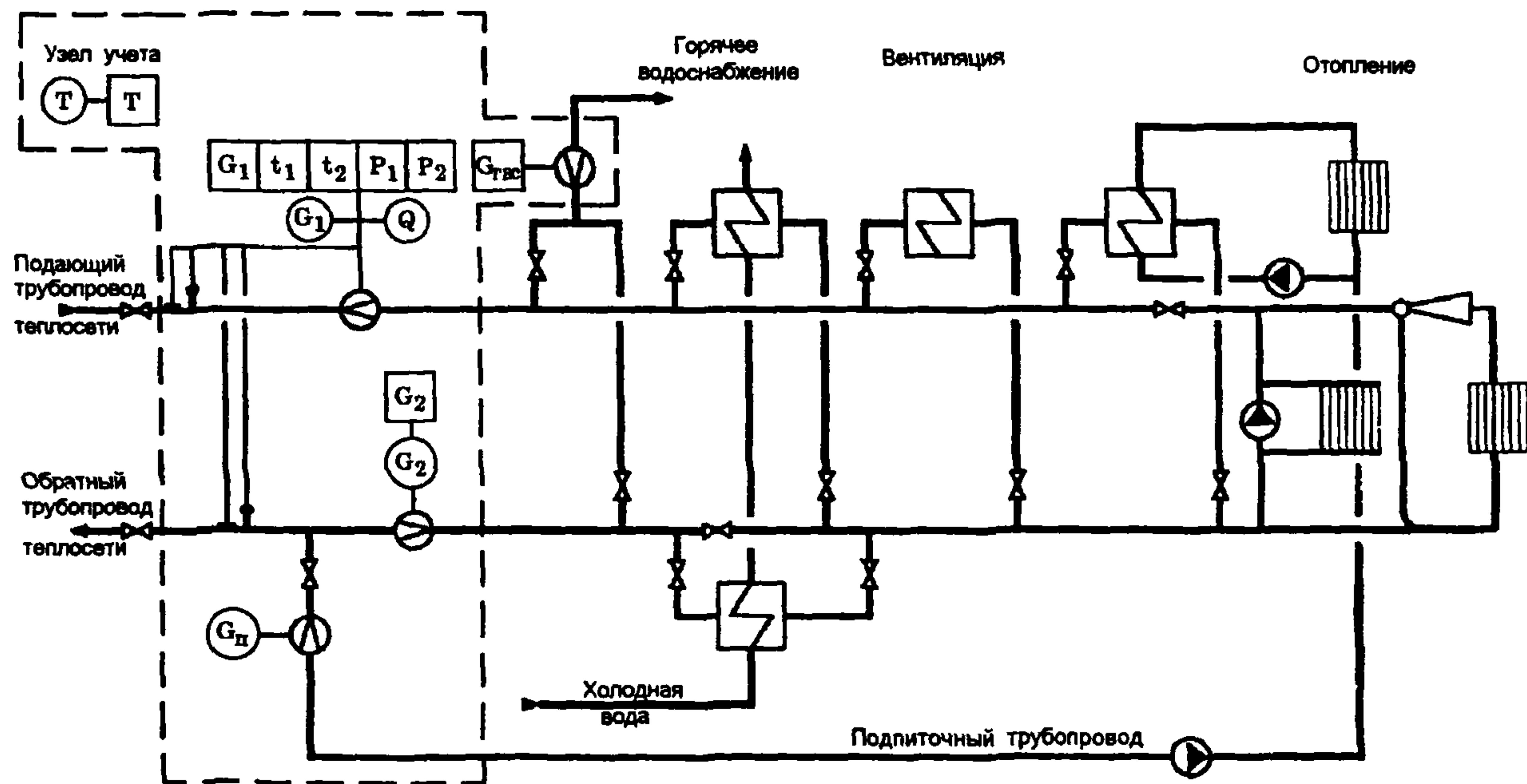
Рис. 3 Принципиальная схема размещения точек измерения количества тепловой энергии и массы (объема) теплоносителя, а также его регистрируемых параметров в открытых системах теплопотребления
