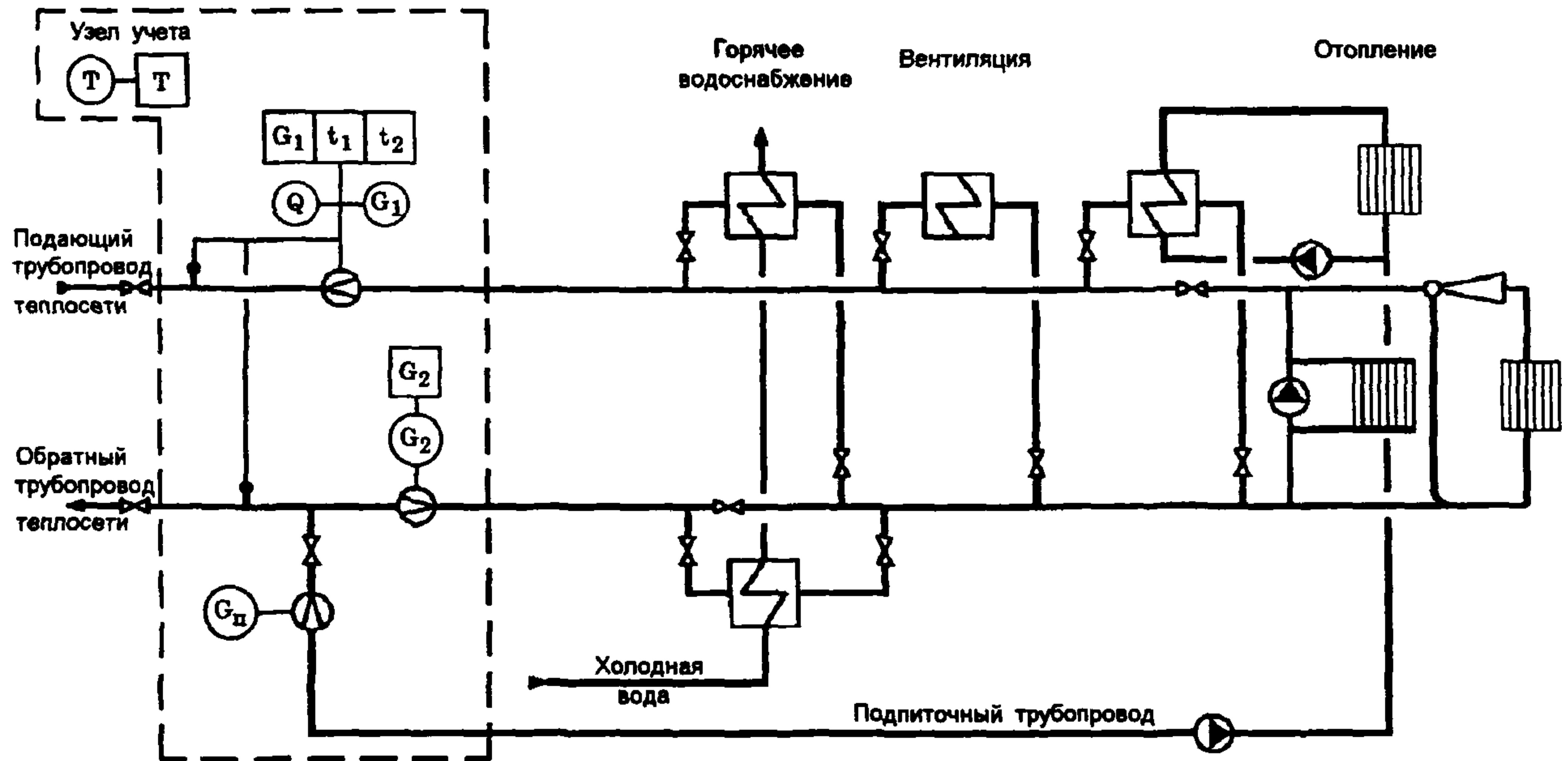
Рис. 4 Принципиальная схема размещения точек измерения количества тепловой энергии и массы (объема) теплоносителя, а также его регистрируемых параметров в закрытых системах теплопотребления
