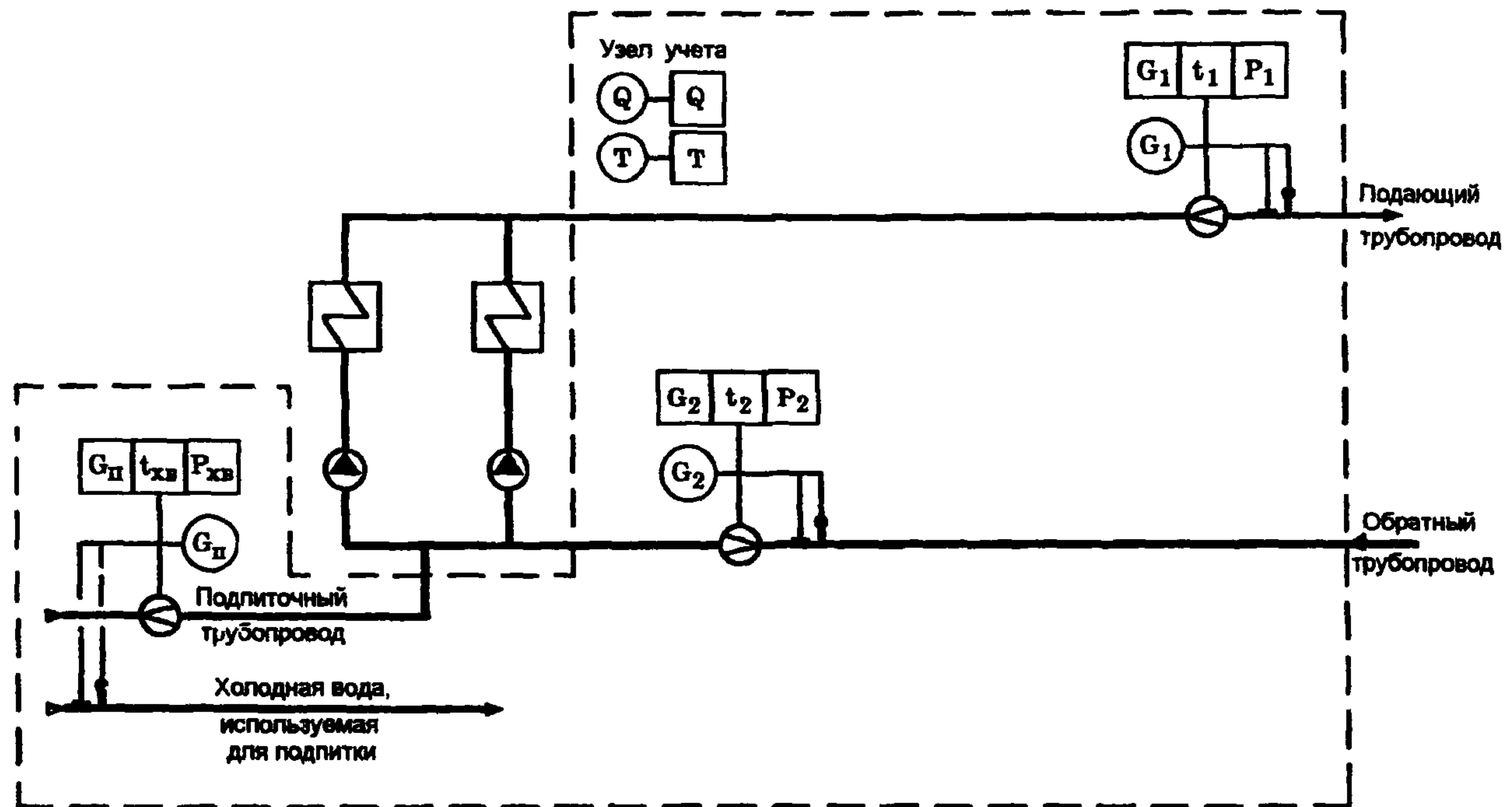
Рис. I Принципиальная схема размещения точек измерения массы (объема) теплоносителя и его регистрируемых параметров на источнике теплоты для водяных систем теплоснабжения
