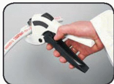
Отрезать трубу SANEXT PEX//EVOH//PEX под прямым углом ножницами, предназначенными для резки труб.
