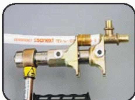
Запрессовать гильзу на фитинг с помощью ручного или гидравлического пресса с соответствующими диаметру трубы насадками.
