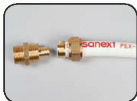
Надеть на трубу SANEXT PEX//EVOH//PEX обжимную гайку резьбой в сторону штуцера. Надеть на трубу разрезное кольцо. Край кольца должен при этом отстоять от среза трубы на 1 мм.
