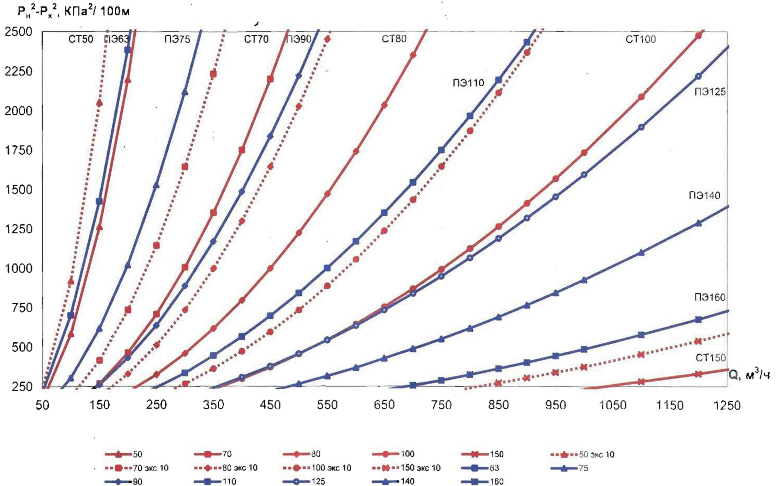
4 (SDR9) Удельные потери давления для стальных (новых и бывших в эксплуатации) и полиэтиленовых труб SDR 9
