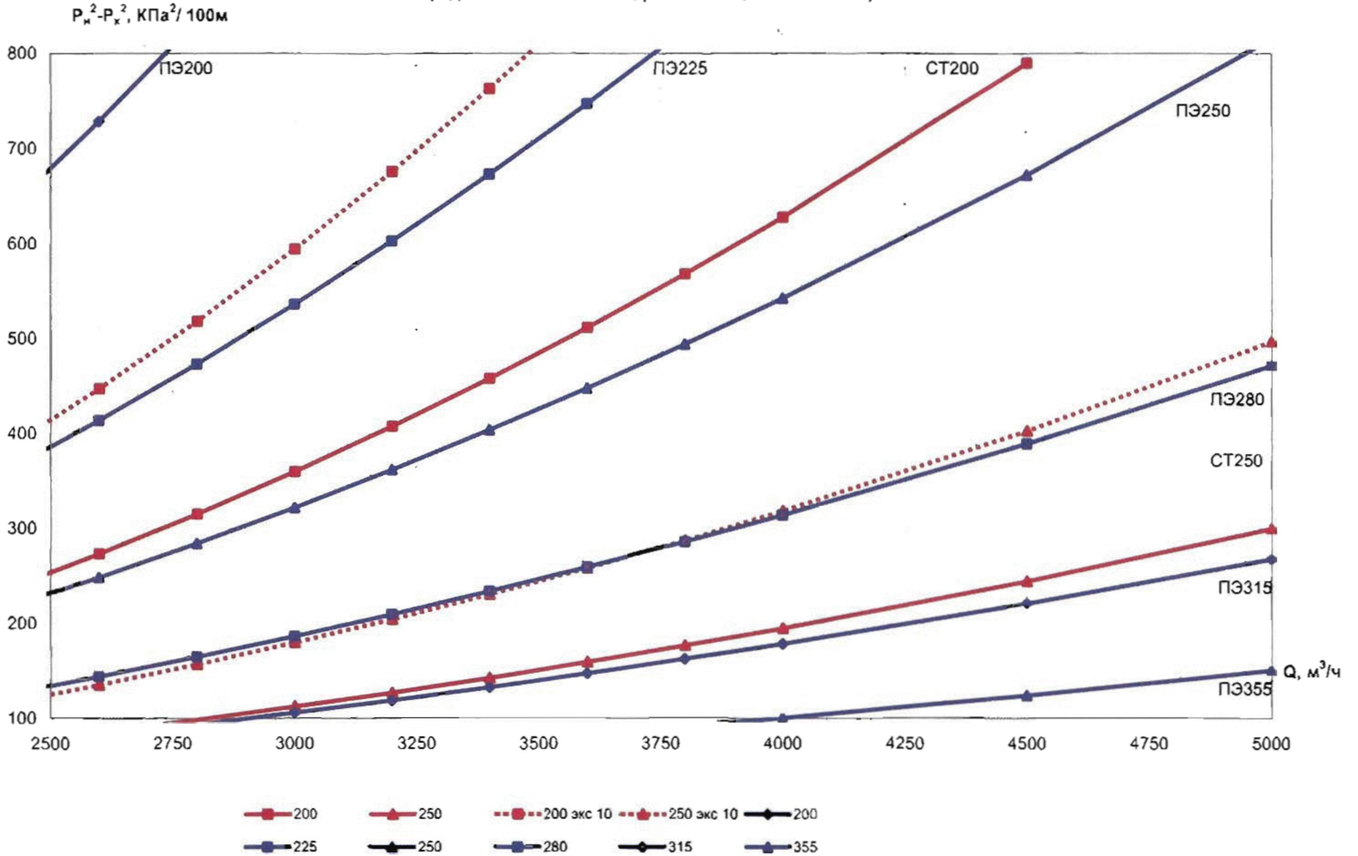
6 (SDR11) Удельные потери давления для стальных (новых и бывших в эксплуатации) и полиэтиленовых труб SDR 11
