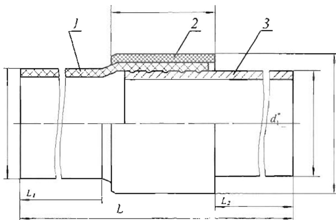
Рисунок: 1 — полиэтиленовый патрубок; 2 — муфта полиэтиленовая; 3 — стальной патрубок.
