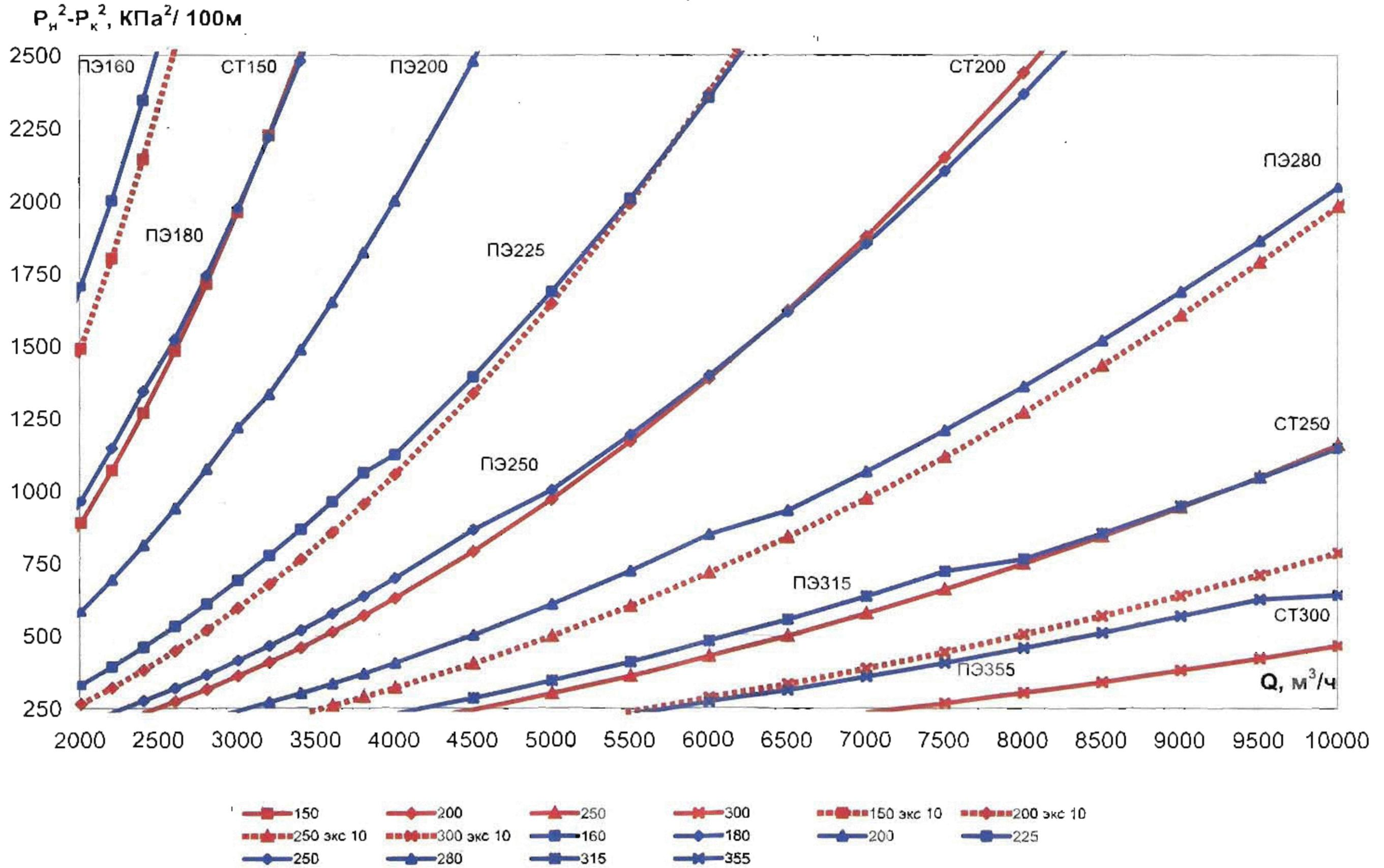
2 (SDR9) Удельные потери давления для стальных (новых и бывших в эксплуатации) и полиэтиленовых труб SDR 9
