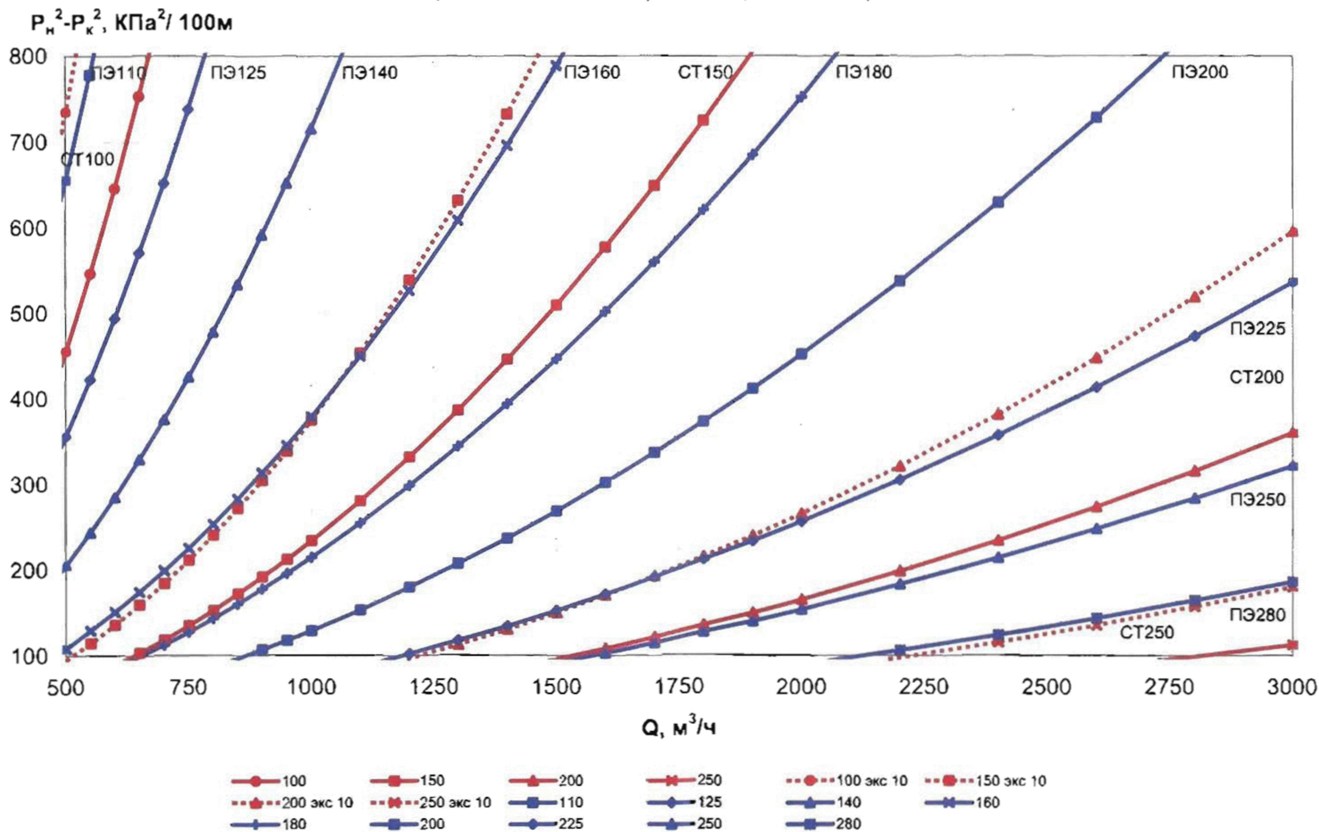
7 (SDR11) Удельные потери давления для стальных (новых и бывших в эксплуатации) и полиэтиленовых труб SDR 11
