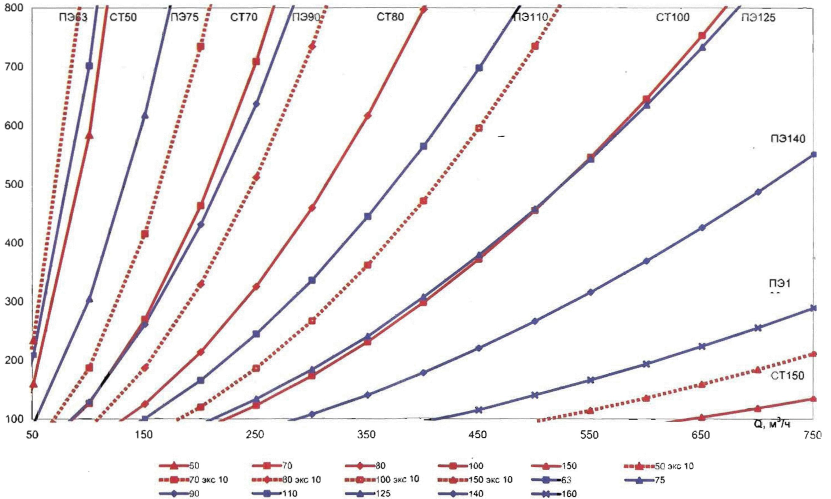
8 (SDR9) Удельные потери давления для стальных (новых и бывших в эксплуатации) и полиэтиленовых труб SDR 9
