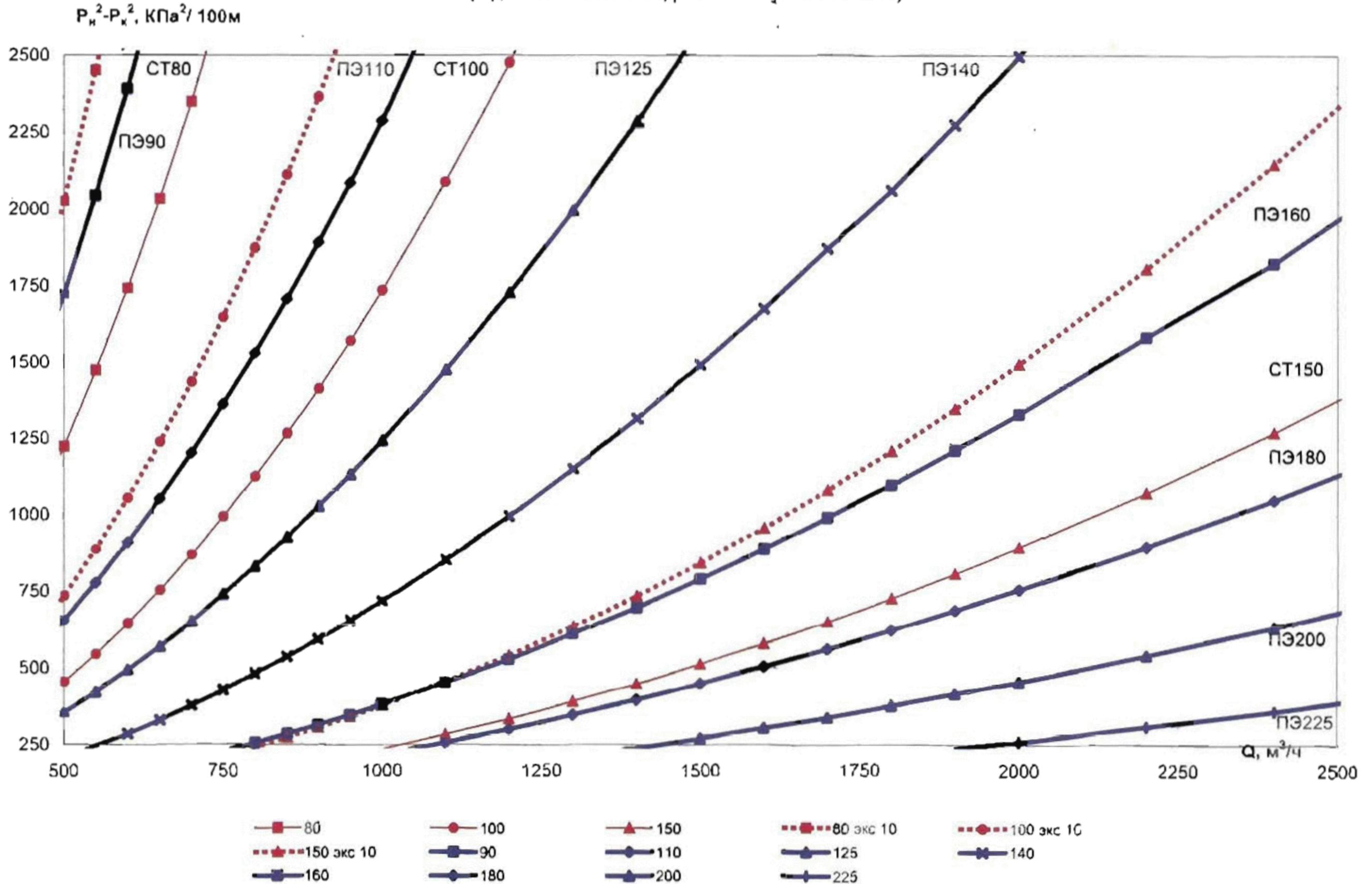
3 (SDR11) Удельные потери давления для стальных (новых и бывших в эксплуатации) и полиэтиленовых труб SDR 11
