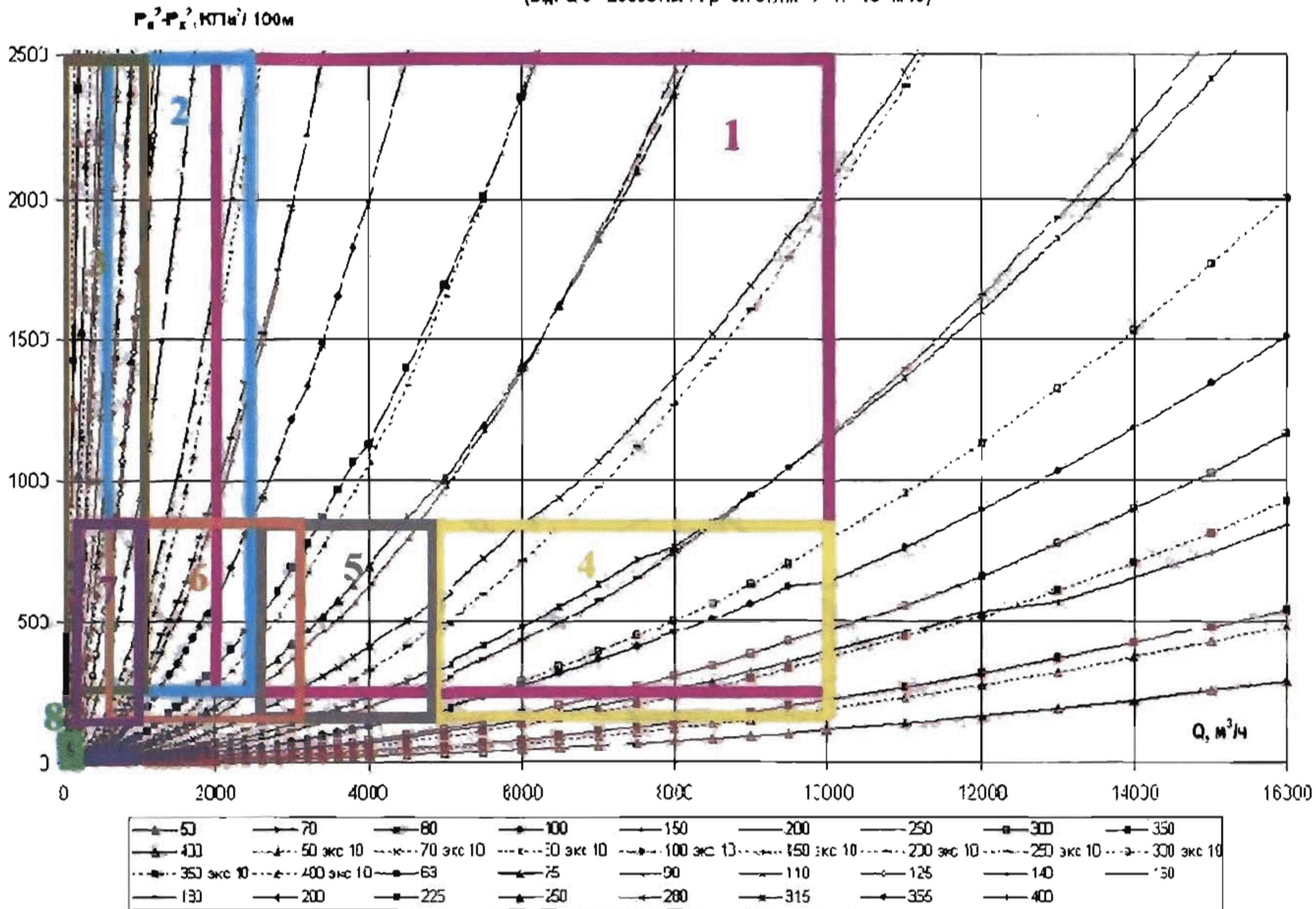
1 (SDR9) Удельные потери давления для стальных (новых и бывших в эксплуатации) и полиэтиленовых труб SDR 9
