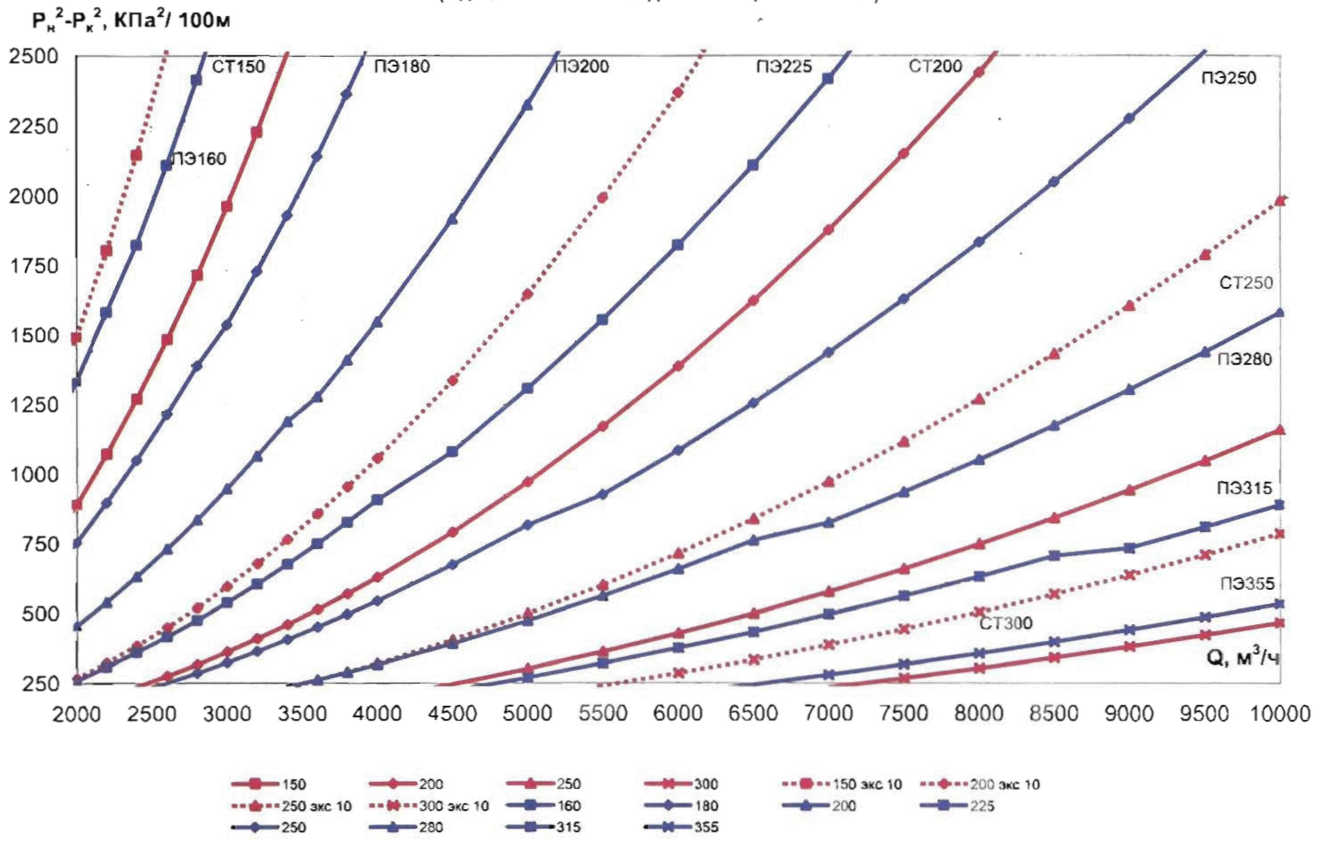
2 (SDR11) Удельные потери давления для стальных (новых и бывших в эксплуатации) и полиэтиленовых труб SDR 11
