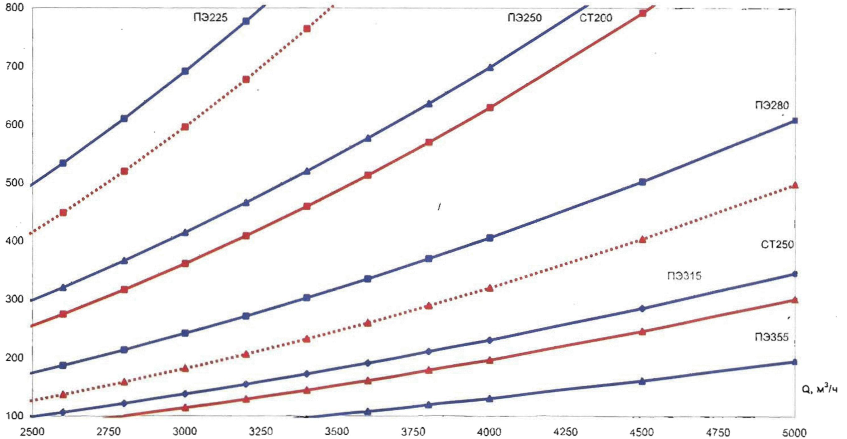
6 (SDR9) Удельные потери давления для стальных (новых и бывших в эксплуатации) и полиэтиленовых труб SDR 9
