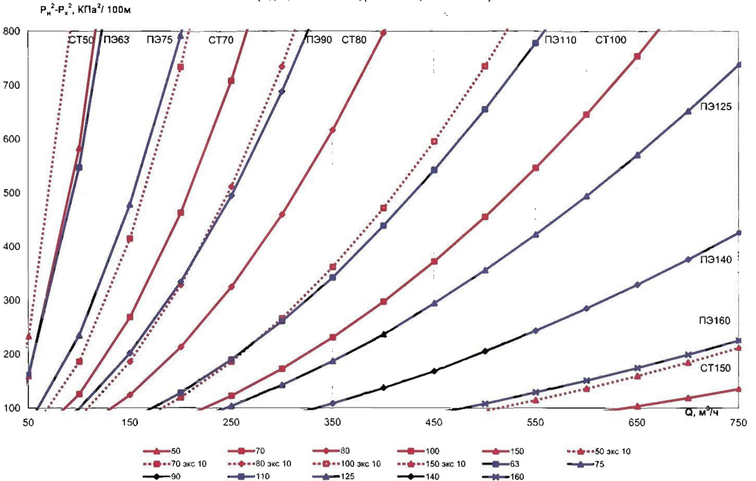
8 (SDR11) Удельные потери давления для стальных (новых и бывших в эксплуатации) и полиэтиленовых труб SDR 11
