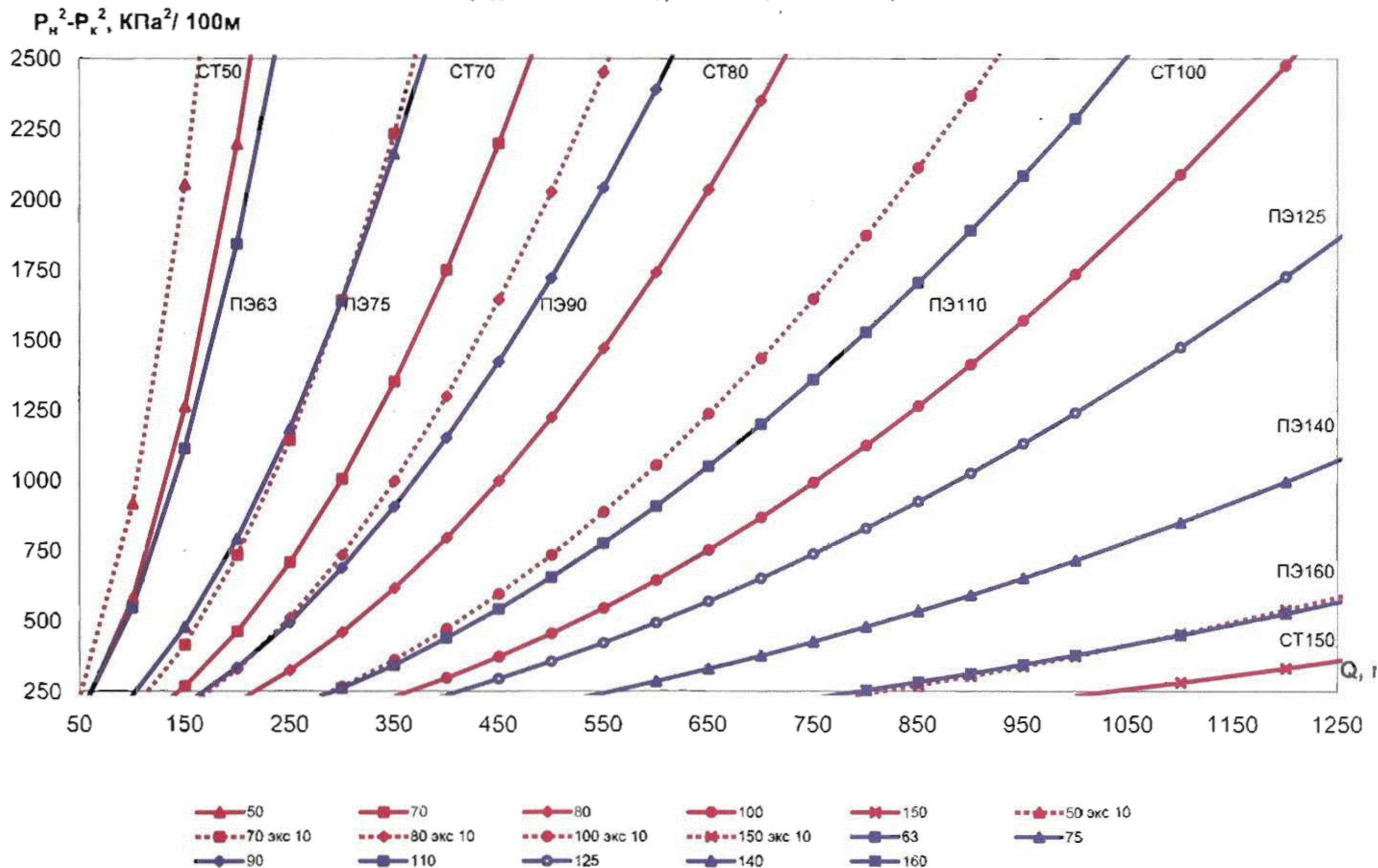
4 (SDR11) Удельные потери давления для стальных (новых и бывших в эксплуатации) и полиэтиленовых труб SDR 11
