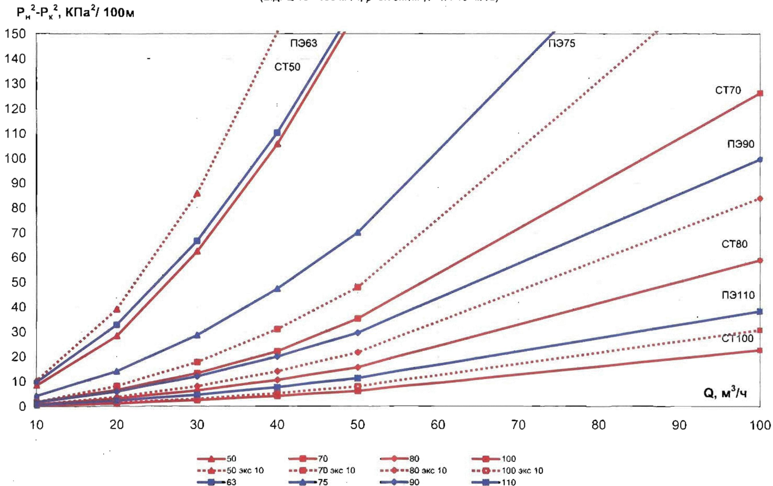
Удельные потери давления для стальных (новых и бывших в эксплуатации) и полиэтиленовых труб SDR 9
