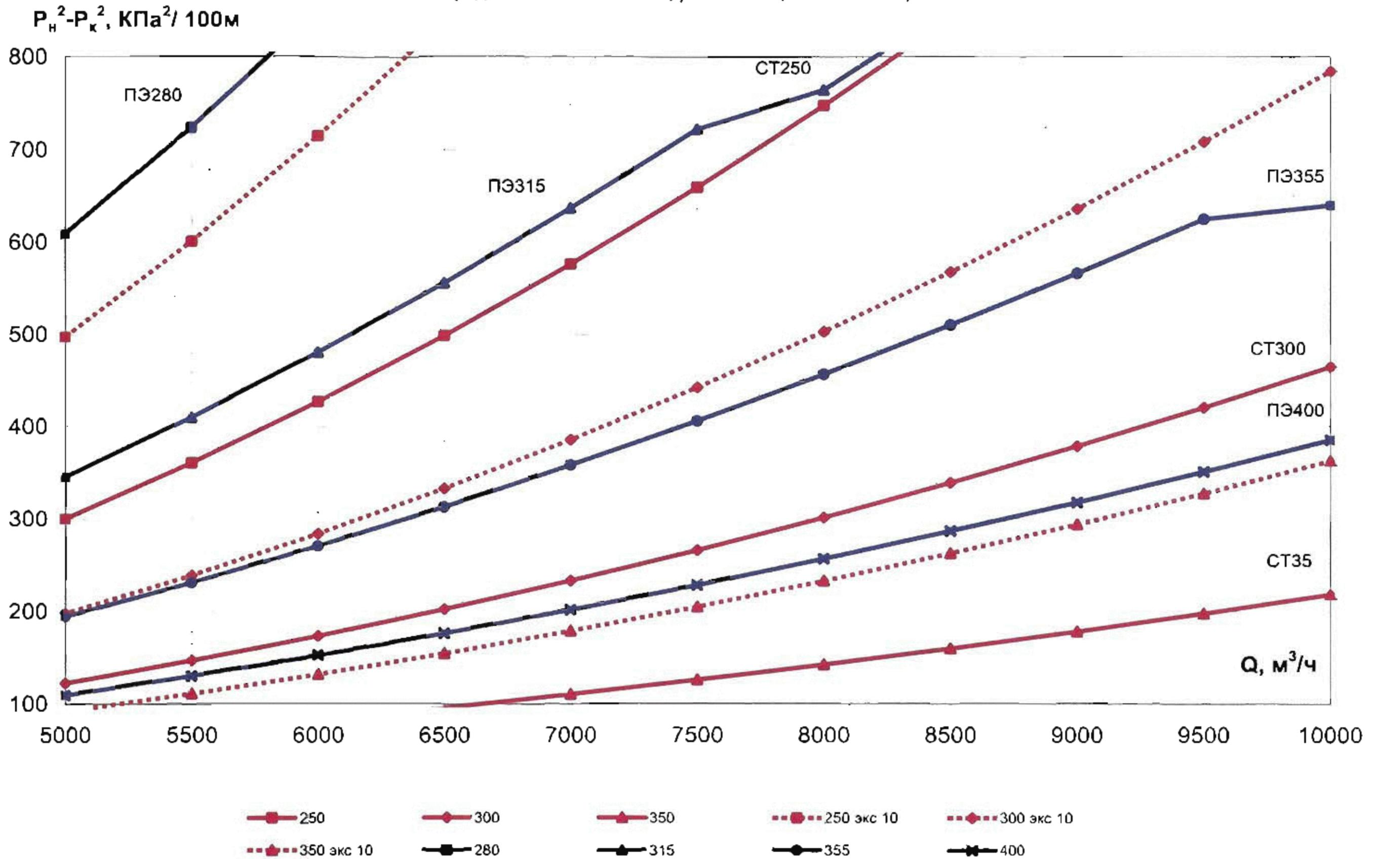
5 (SDR9) Удельные потери давления для стальных (новых и бывших в эксплуатации) и полиэтиленовых труб SDR 9
