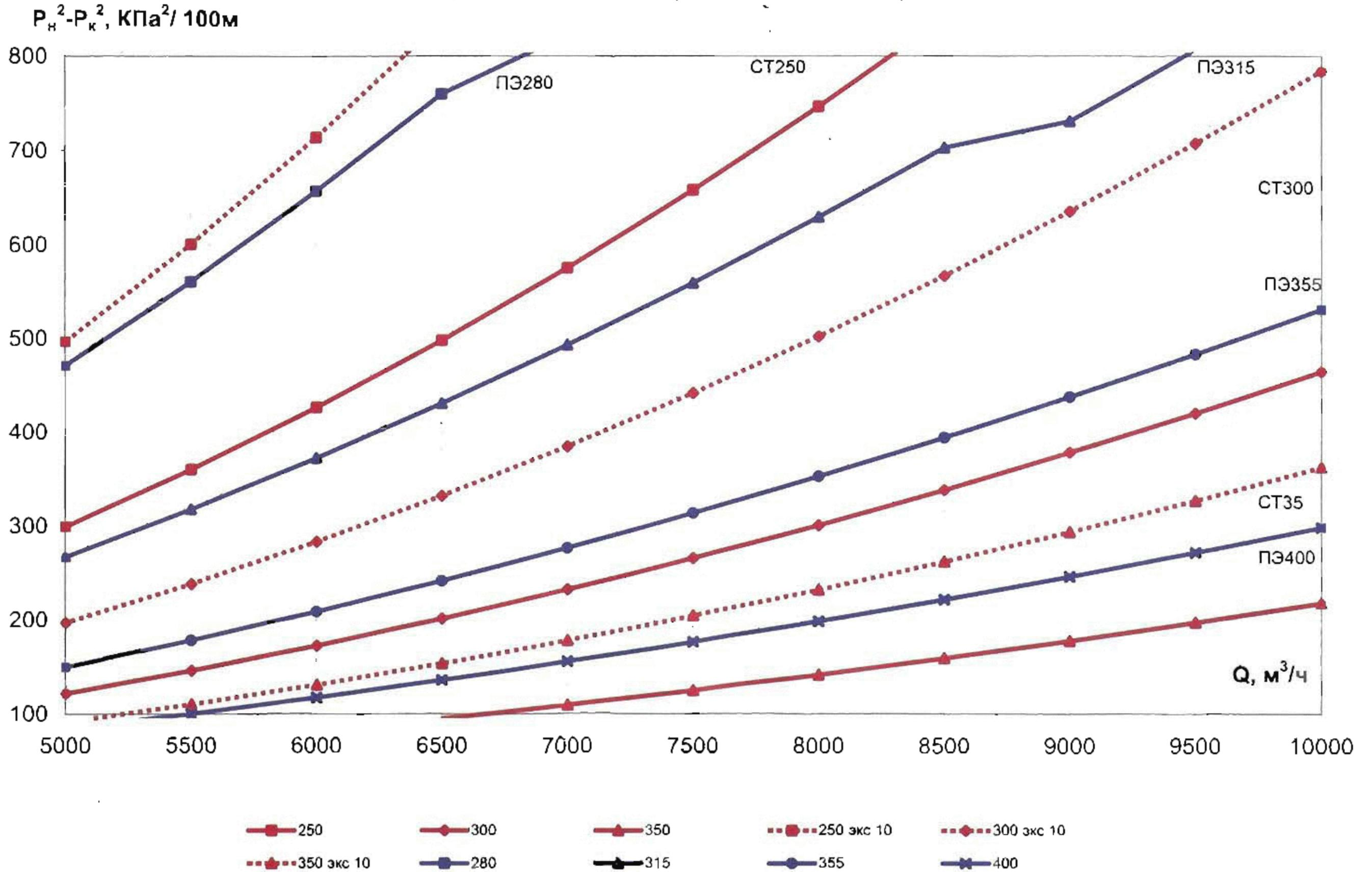
5 (SDR11) Удельные потери давления для стальных (новых и бывших в эксплуатации) и полиэтиленовых труб SDR 11
