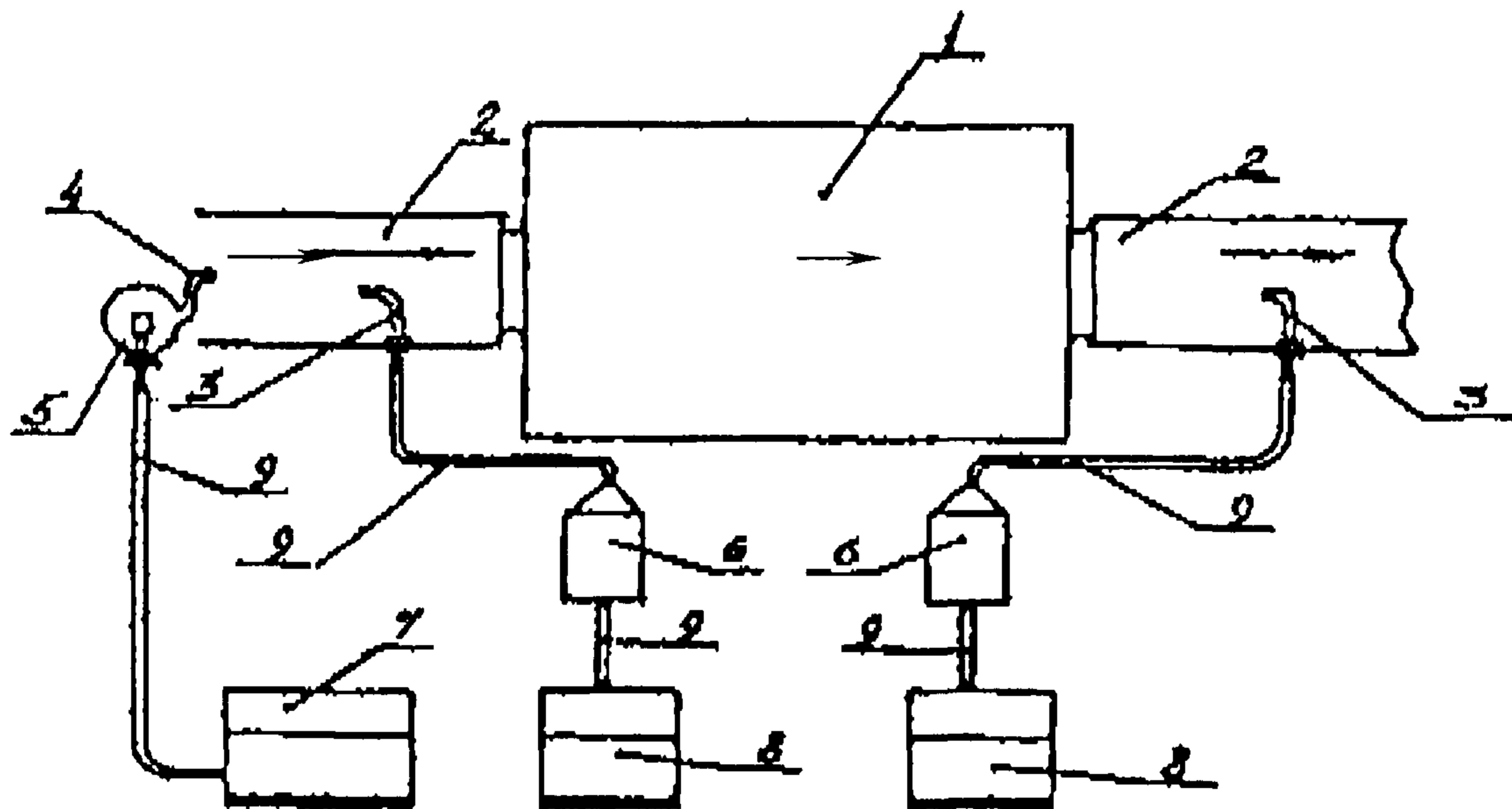
ОБОЗНАЧЕНИЯ: 1 – фильтр Д-13 (Д-15), 2 – воздуховод вентиляционной системы,
