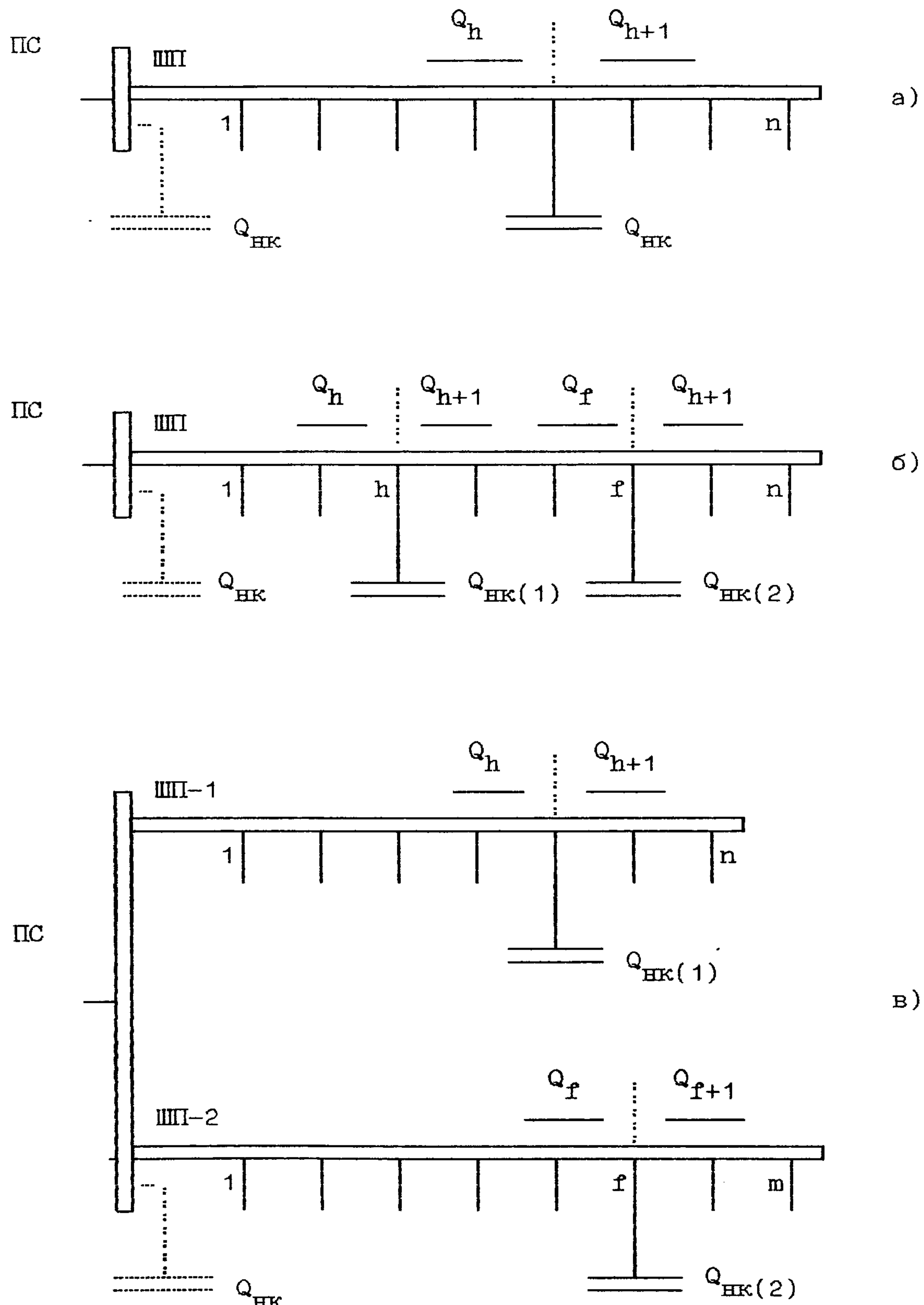
Рис. 2-6. Схема подключения БНК к магистральным шинопроводам:
