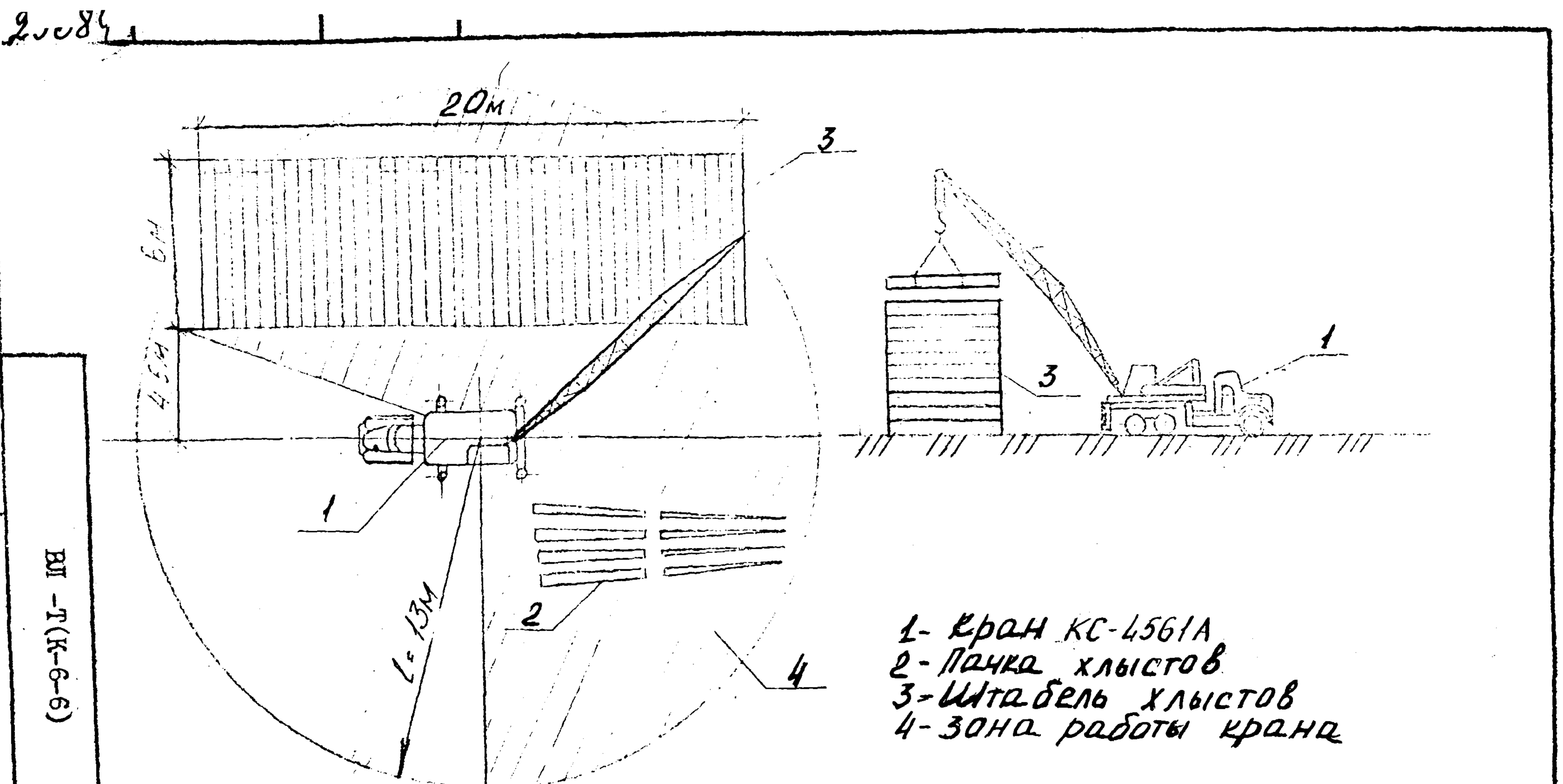
Рис 9-1 Технологическая схема укладки штабеля
