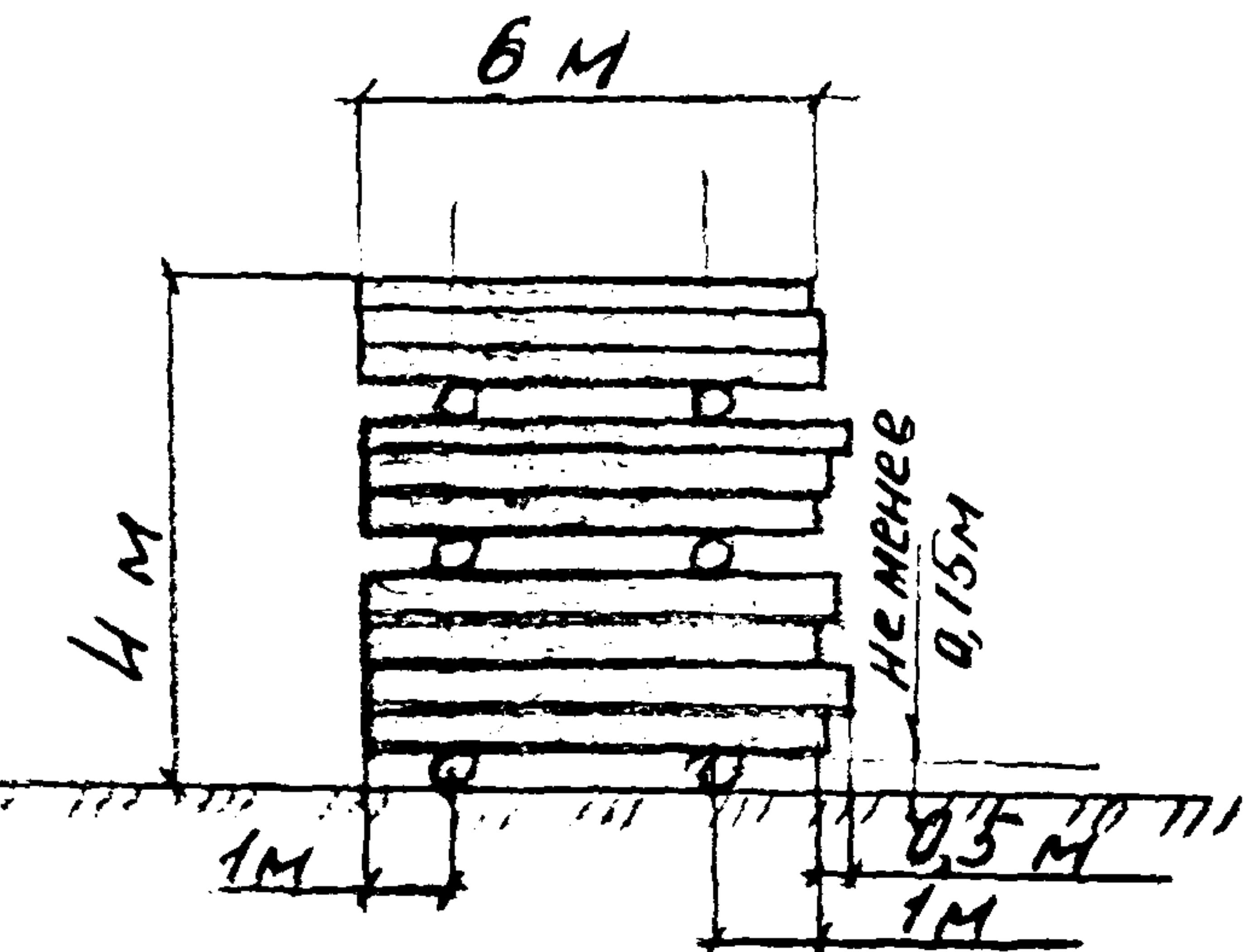
Рис. 9-2 Форма и размеры укладываемых штабелей.
